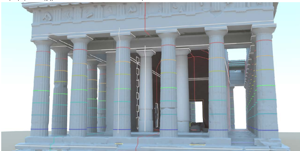
Απόδοση (rendering) του μοντέλου με ενιαία επιφανειακή υφή και διακριτές τις τομές σε διάφορα επίπεδα.
