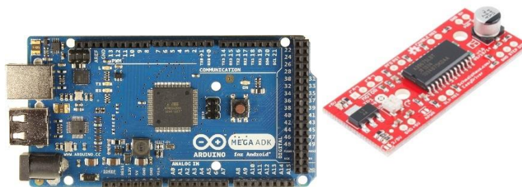
Εικόνα 2.28: Αριστερά: Μικροεπεξεργαστής Arduino MEGA ADK.[26] Δεξιά: Βηματικός οδηγός Easy Driver.[25]
