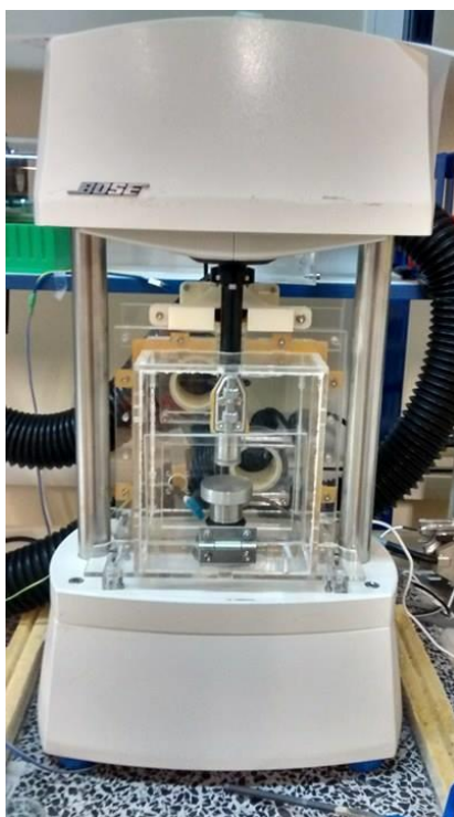
Εικόνα 1.4: Μηχανή δοκιμής υλικών BOSE Electroforce 3100 του εργαστηρίου Εμβιομηχανικής και Συστημικής Βιολογίας.
