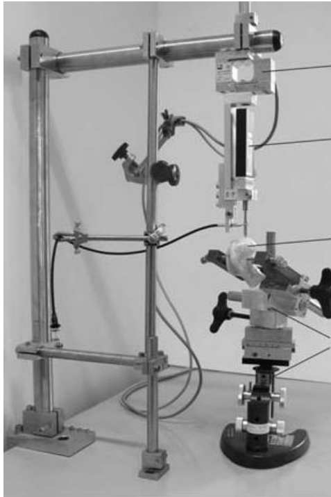
Εικόνα 1.5: Απλή συσκευή μέτρησης για εργαστηριακές δοκιμές αυλακώσεως σε χόνδρο.[5]
