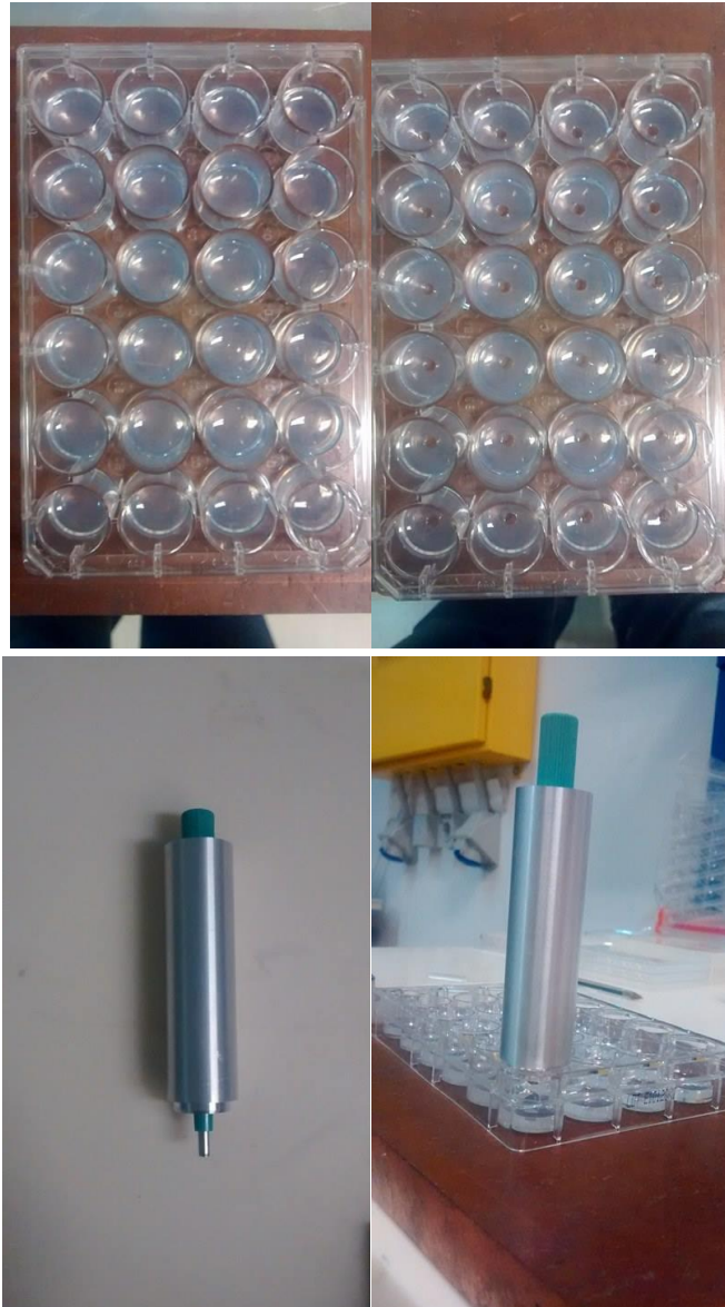
Εικόνα 4,1: Πάνω αριστερά: Ζελέσ αγαρόζης μέσα σε πηγάδια. Πάνω δεξιά: ζελέσ αγαρόζης με κυλινδρική τρύπα στο κέντρο. Κάτω αριστερά: Συσκευή κεντραρίσματος ενός biopsy punch. Κάτω δεξιά: Διαδικασία αφαίρεσης κυλινδρικού τμήματος.
