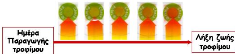
Εικόνα 2.2 Χρωματική απόκριση του ενζυμικού δείκτη Check Point της VITSAB
