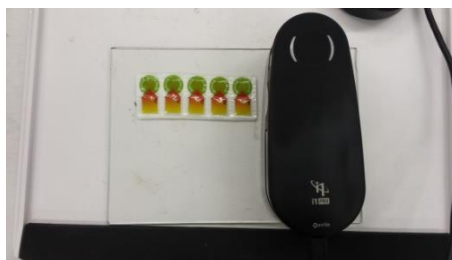
Εικόνα 4.3 Χρωματόμετρο X-rite Eye1pro και δείκτες ΤΤΙ.
