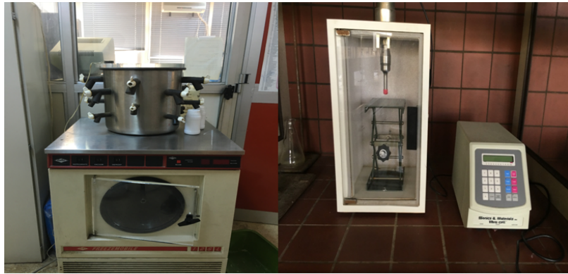
Εικόνα 2.5. Συσκευή λυοφιλίωσης Freezmobile, Virtins (Η.Π.Α.) και συσκευή υπερήχων VC 505 (500 watts) & VC 750 (750 watts), Sonics and Materials (Η.Π.Α.)
