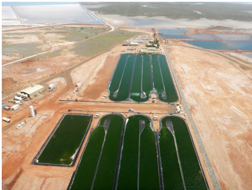
Εικόνα 1.8. Καλλιέργεια μικροφυκών σε ανοιχτές δεξαμενές
