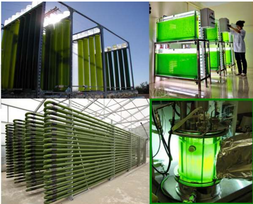
Εικόνα 1.9. Διάφορα είδη βιοαντιδραστήρων: Α) Φωτοβιοαντιδραστήρες με κάθετες στήλες, Β) Φωτοβιοαντιδραστήρες επίπεδης πλάκας, Γ) Σωληνοειδής φωτοβιοαντιδραστήρες και Δ) Φωτοβιοαντιδραστήρες με εσωτερικό φωτισμό
