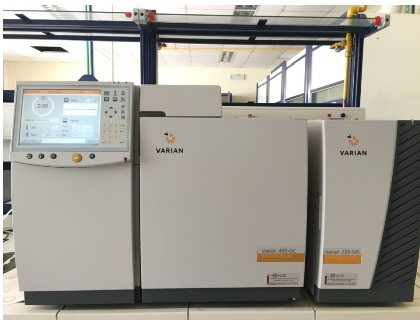
Εικόνα 2.10. Χρωματογράφος GC-MS Variant, Variant (Η.Π.Α.) που χρησιμοποιήθηκε για τον ποιοτικό και ποσοτικό προσδιορισμό των εστέρων
