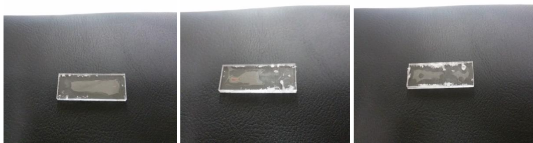
Εικόνα 67 Πειράματα 313, 314 & 315 με amplitude: 7, Energy: 800 Joule και αντίστοιχα welding force: 200, 400 & 600 N
