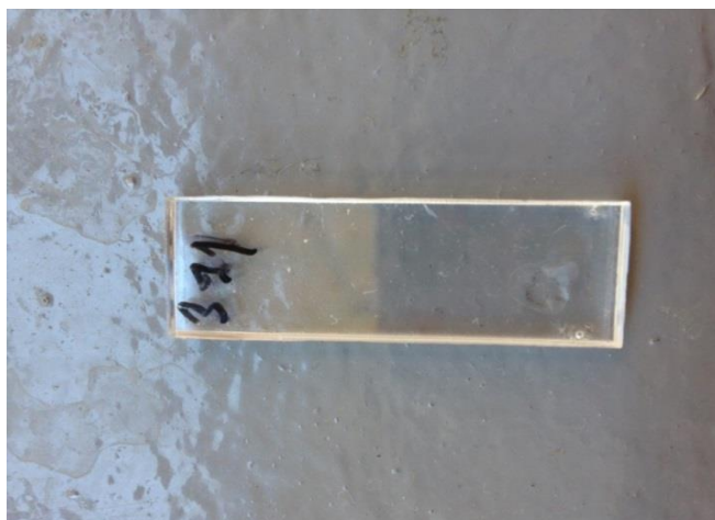
Εικόνα 72 Πείραμα 321 πλάτος ταλάντωση 2.5 \mu\text{m} , δύναμη συγκόλλησης 50 N, χρόνος συγκόλλησης 15 δευτερόλεπτα και ενέργεια 233 Joule
