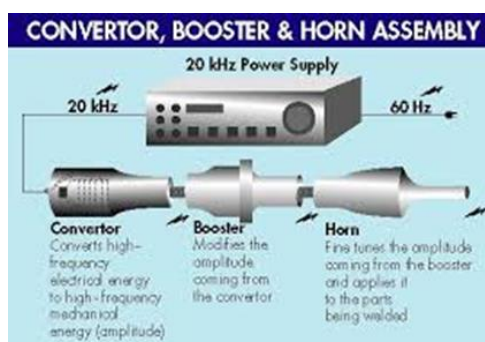
Εικόνα 37 μετατροπείς συχνότητας και συστάδα εφαρμογής υπερήχων
