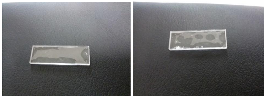
Εικόνα 66 Πειράματα 311 & 312 amplitude: 5 \mu\text{m} , welding force: 400 & 600 N, Energy: 230 & 656 Joule
