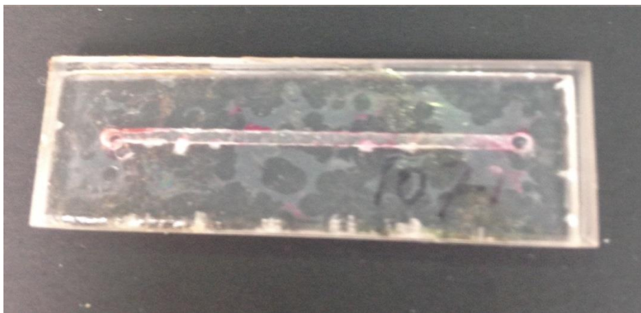
Εικόνα 78 Πείραμα 1071 πλάτος ταλάντωσης 7 \mu\text{m} , δύναμη συγκόλλησης 240 N, Ενέργεια 4 x 100 J
