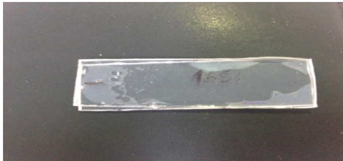
Εικόνα 118 Εμβαπτισμένα σε διαλύτη δείγματα πριν τη συγκόλληση
