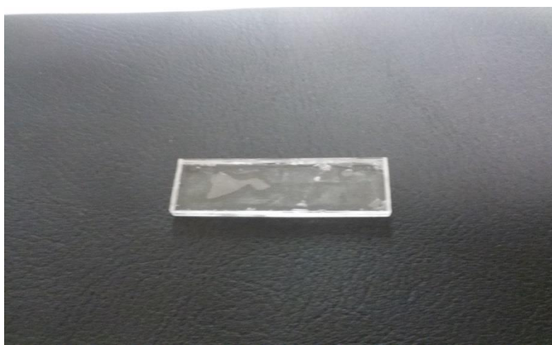
Εικόνα 68 Πείραμα 316 amplitude 5 \mu\text{m} , welding force 400 N, Energy 1465 Joule
