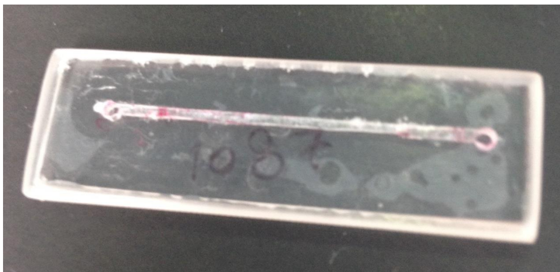
Εικόνα 79 Πείραμα 1087 πλάτος ταλάντωσης 5 \mu\text{m} , δύναμη συγκόλλησης 240 N, Ενέργεια 4 x 150 J
