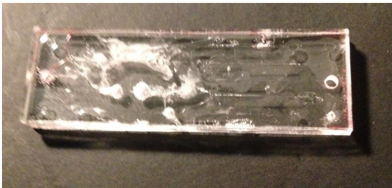
Εικόνα 57 υπερβολική ροή υλικού μέσα στη διεπιφάνεια (κάψιμο)
