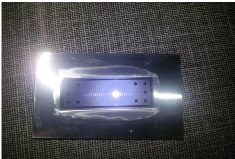
Εικόνα 54 Master εγχάραξης μικρορυστονικής διάταξης βάθους 50 \mu\text{m}
