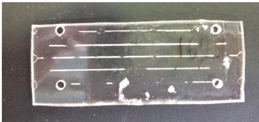
Εικόνα 92 Πείραμα 1621 πλάτος ταλάντωσης 4.3 μm, δύναμη συγκόλλησης 200 N, χρόνος συγκόλλησης 10 δευτερόλεπτα και ενέργεια 633 Joule
