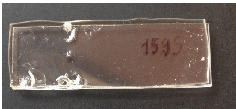
Εικόνα 90 Πείραμα 1572 πλάτος ταλάντωσης 4.4 \mu\text{m} , δύναμη συγκόλλησης 200 N, Χρόνος 10 δευτερόλεπτα, Ενέργεια 500 J
