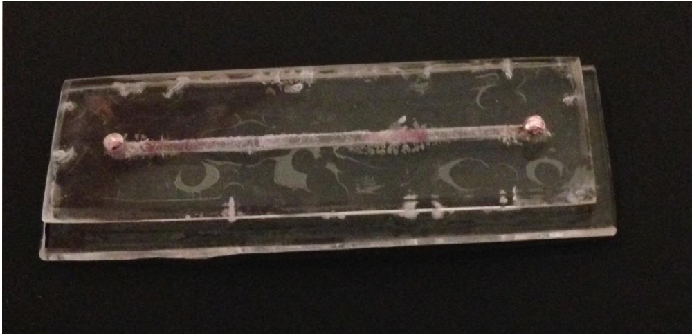
Εικόνα 96 Πείραμα μεγάλου πλάτους ταλάντωσης και μικρού χρόνου συγκόλλησης με "μαξιλάρι"
