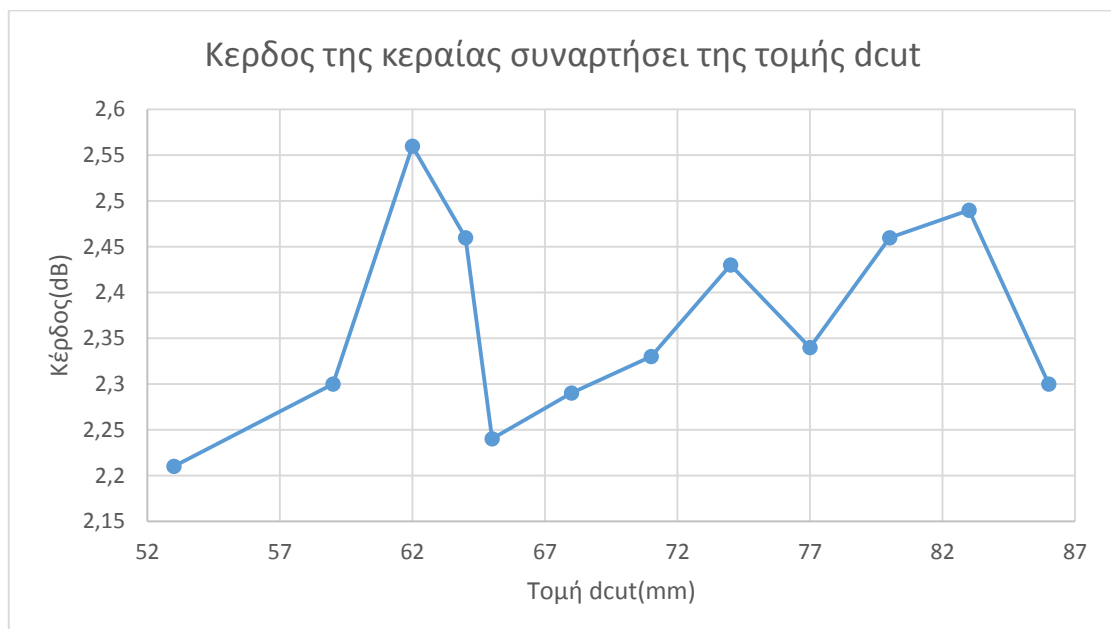
Εικόνα 3.13 Κέρδος της κεραίας συναρτήσει του μήκους της κεντρικής εγκοπής dcut
