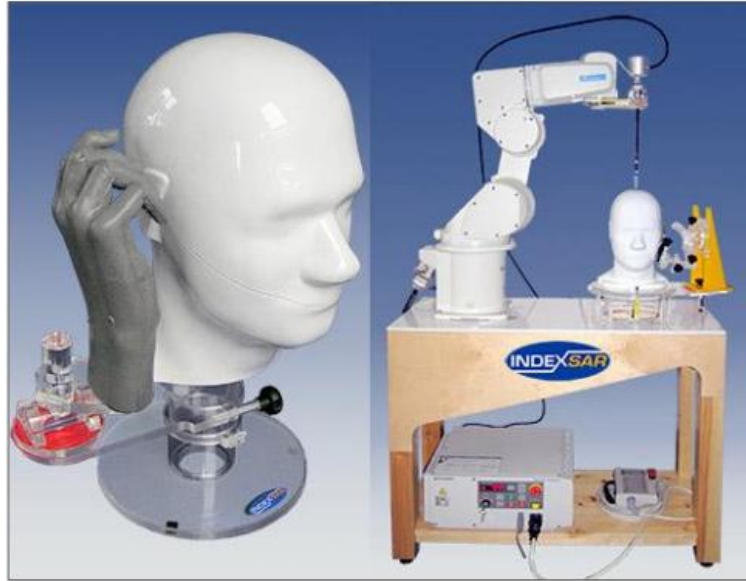
Εικόνα 2.26 Φυσικό μοντέλο ανθρώπινης κεφαλής για εργαστηριακές δοκιμές[53]
