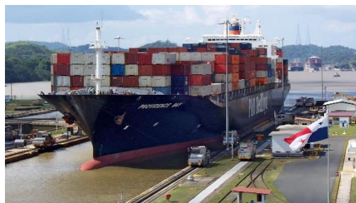
Εικόνα 2: Panamax vessel, Providence Bay 4224 TEU
