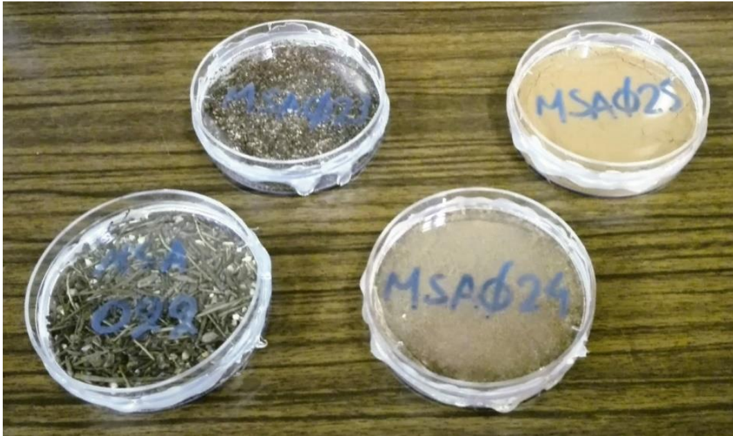
Σχήμα 4-5: Συσκευασμένα δείγματα ομαδοποιημένων κλασμάτων από την επεξεργασία του κλάσματος 1-2mm με τη μέθοδο της υγρής κοσκίνισης
