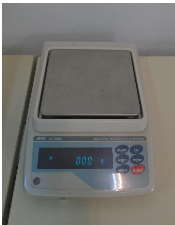
Σχήμα 3-14: Ηλεκτρονική ζυγαριά που χρησιμοποιήθηκε για το ζύγισμα των κλασμάτων χόματος.
