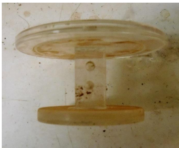
Σχήμα 3-25: Βοήθημα πλήρωσης των κυλινδρικών δοχείων σε γεωμετρία «5»
