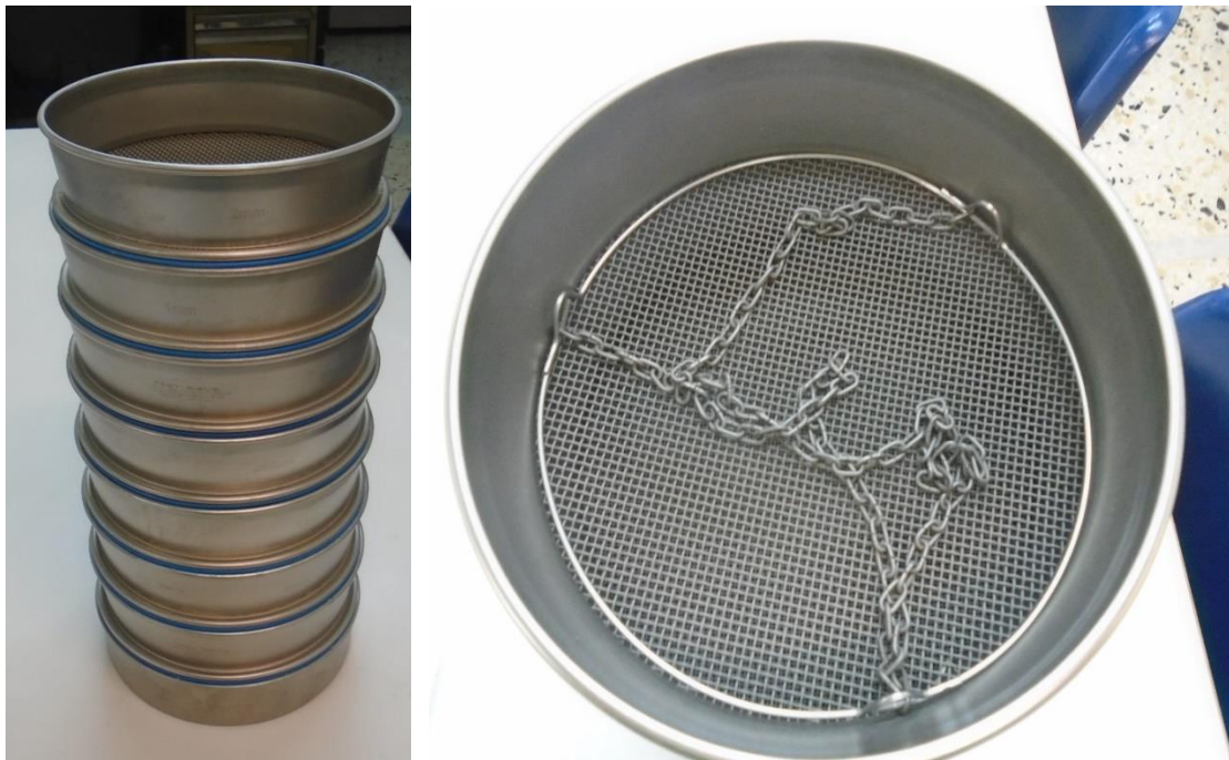
Σχήμα 3-12 : Στα αριστερά φαίνεται η στήλη των κοσκίων μαζί με τη βάση της που χρησιμοποιείται για την κοσκίνιση των δειγμάτων, και στα δεξιά φαίνεται η βοηθητική αλυσίδα τοποθετημένη στο κόσκινο κορυφής
