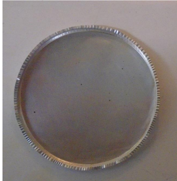
Σχήμα 3-23 : Αλουμινένιος δίσκος για την τοποθέτηση των 10.0gr δείγματος προς προσδιορισμό υγρασίας
