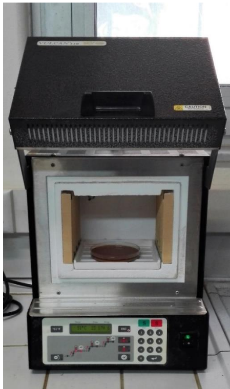
Σχήμα 4-10: Το ίζημα που συλλέξαμε από το υγρό δείγμα τοποθετημένο σε ρυθμιζόμενο φούρνο για την τελική φάση της ξήρανσής του
