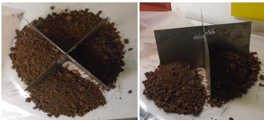
Σχήμα 3-11: Η μέθοδος «cone and quartering» στο ΕΠΤ-ΕΜΠ
