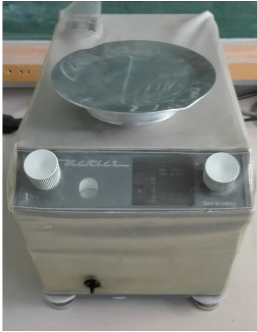
Σχήμα 3-8: Ο ζυγός ακριβείας του ΕΠΤ-ΕΜΠ που χρησιμοποιήθηκε για τη ζύγιση των δειγμάτων στην παρούσα ΔΕ
