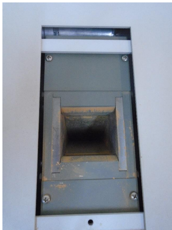
Σχήμα 3-21: Στα αριστερά φαίνεται η συσκευή Retsch BB51 και στα δεξιά η είσοδος του υλικού προς θραύση
