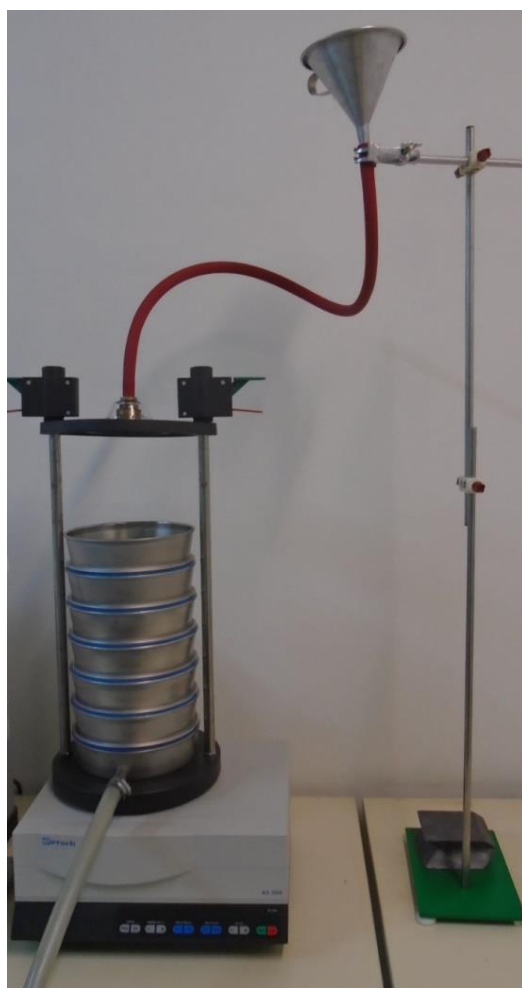
Σχήμα 4-1: Διάταξη υγρής κοσκίνισης όπως αυτή διαμορφώθηκε για την παρούσα ΔΕ
