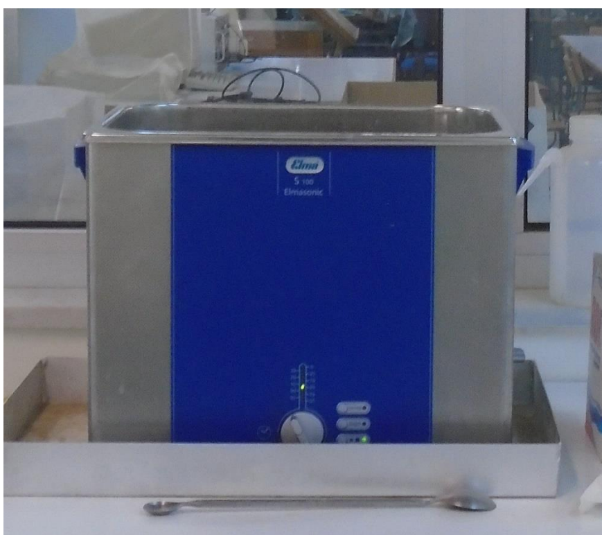
Σχήμα Γ-1: Συσκευή πλυσίματος κοσκίνων με χρήση υπερήχων
