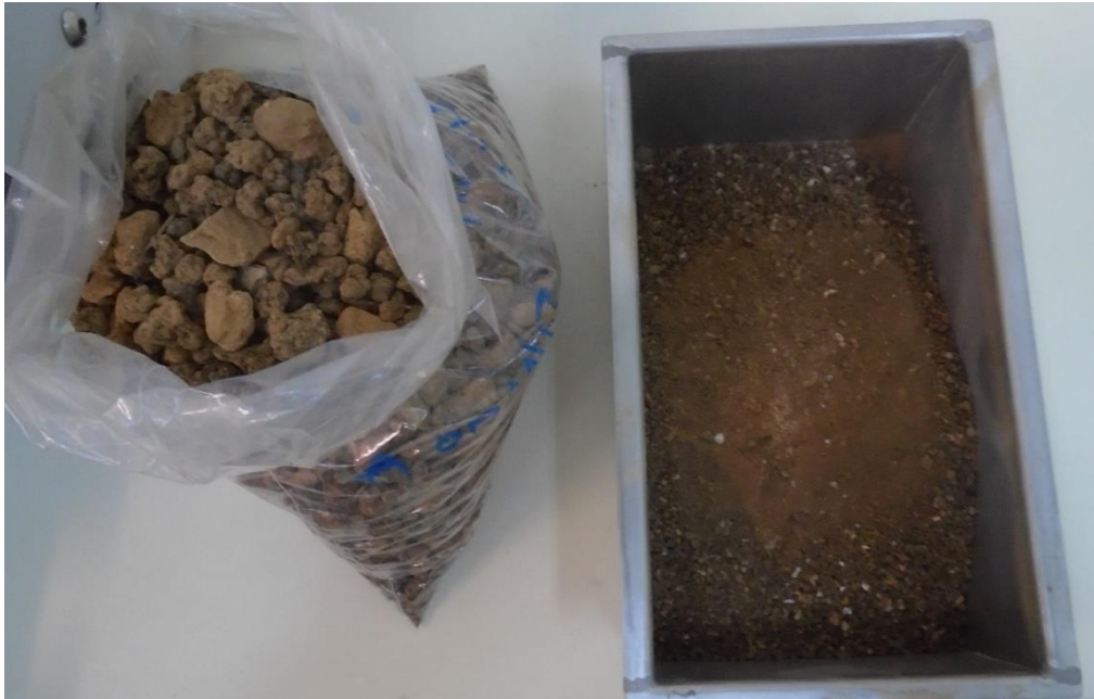
Σχήμα 3-22: Των κλάσμα των >2mm του δείγματος A πριν και μετά τη θραύση του στη συσκευή Retsch BB51
