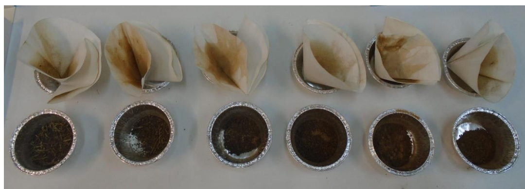
Σχήμα 4-3: Από αριστερά προς τα δεξιά τα συλλεχθέντα κλάσματα των 1-2mm, 500μm-1mm, 250μm-500μm, 125μm-250μm, 63μm-125μm, 45μm-63μm μετά την ξήρανσή τους
