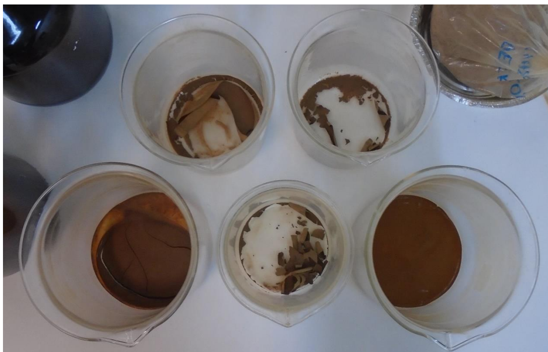
Σχήμα 4-4: Το δείγμα των <math><45\mu\text{m}</math> μέσα στα δοχεία συλλογής μετά το πέρας της ξήρανόσής του,
