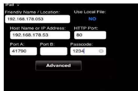
Σχέδιο 58: παραμετροποίηση εφαρμογής Ipad στο Crestron Mobile Pro
