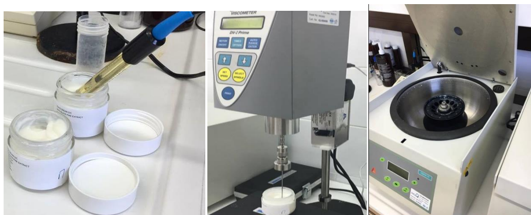
Εικόνες 4.14. Παράμετροι ελέγχου. Αριστερά: Μέτρηση ρΗ, Στο κέντρο: Μέτρηση ιξώδους, Δεξιά: Φυγοκέντρος
