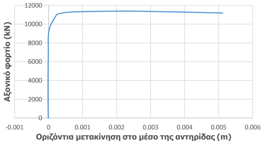
Σχήμα 4-60: Δρόμος ισορροπίας αντηρίδας κάτω στάθμης διατομής CHS610/20 για μετακίνηση στο οριζόντιο επίπεδο από ανάλυση GMNIA
