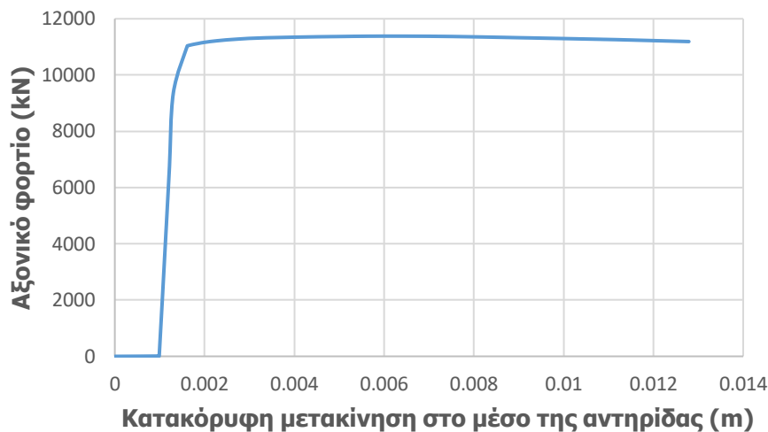
Σχήμα 4-59: Δρόμος ισορροπίας αντηρίδας κάτω στάθμης διατομής CHS610/20 για μετακίνηση στο κατακόρυφο επίπεδο από ανάλυση GMNIA
