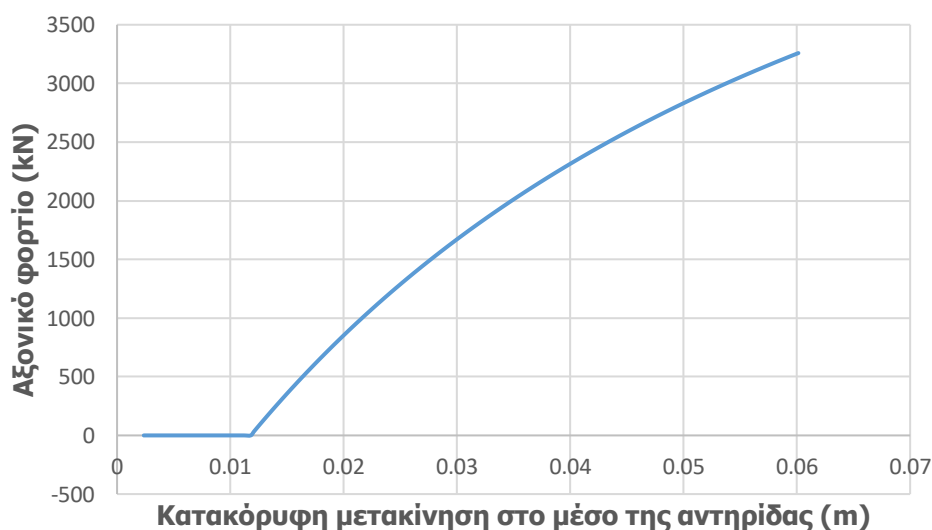
Σχήμα 4-21: Δρόμος ισορροπίας αντηρίδας άνω στάθμης διατομής HEM340 για μετακίνηση στο κατακόρυφο επίπεδο από ανάλυση GNIA έως το αξονικό φορτίο σχεδιασμού
