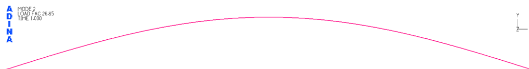
Σχήμα 3-36: 2 η ιδιομορφή λυγισμού στο οριζόντιο επίπεδο xy για την διατομή CHS610/40 αντηρίδας κάτω στάθμης από γραμμική ανάλυση λυγισμού
