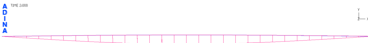
Σχήμα 3-15: Διάγραμμα καμπικών ροπών M_z αντηρίδας άνω στάθμης διατομής CHS508/20 στο τέλος της ανάλυσης GNIA με μέγιστη τιμή M_z=359.1\text{kNm}
