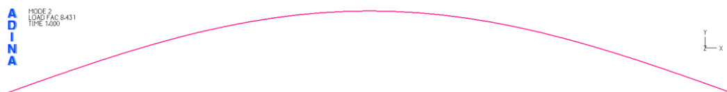
Σχήμα 3-10: 2 η ιδιομορφή λυγισμού στο οριζόντιο επίπεδο xy για την διατομή CHS508/20 αντηρίδας άνω στάθμης από γραμμική ανάλυση λυγισμού
