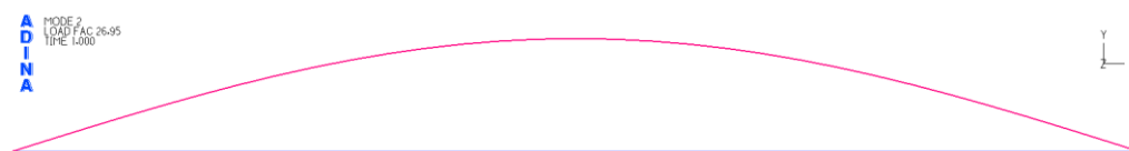
Σχήμα 3-43: 2 η ιδιομορφή λυγισμού στο οριζόντιο επίπεδο xy για την διατομή CHS610/30 αντηρίδας κάτω στάθμης από γραμμική ανάλυση λυγισμού
