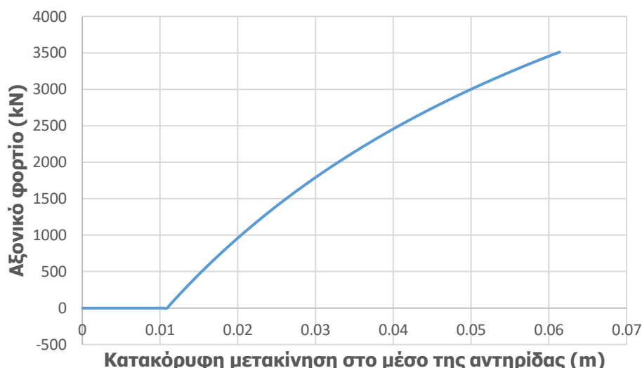
Σχήμα 3-11: Δρόμος ισορροπίας αντηρίδας άνω στάθμης διατομής CHS508/20 για μετακίνηση στο κατακόρυφο επίπεδο από ανάλυση GNIA έως το αξονικό φορτίο σχεδιασμού
