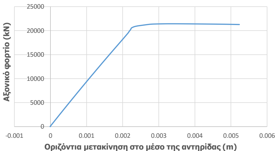
Σχήμα 4-53: Δρόμος ισορροπίας αντηρίδας κάτω στάθμης διατομής CHS610/40 για μετακίνηση στο οριζόντιο επίπεδο από ανάλυση GMNIA
