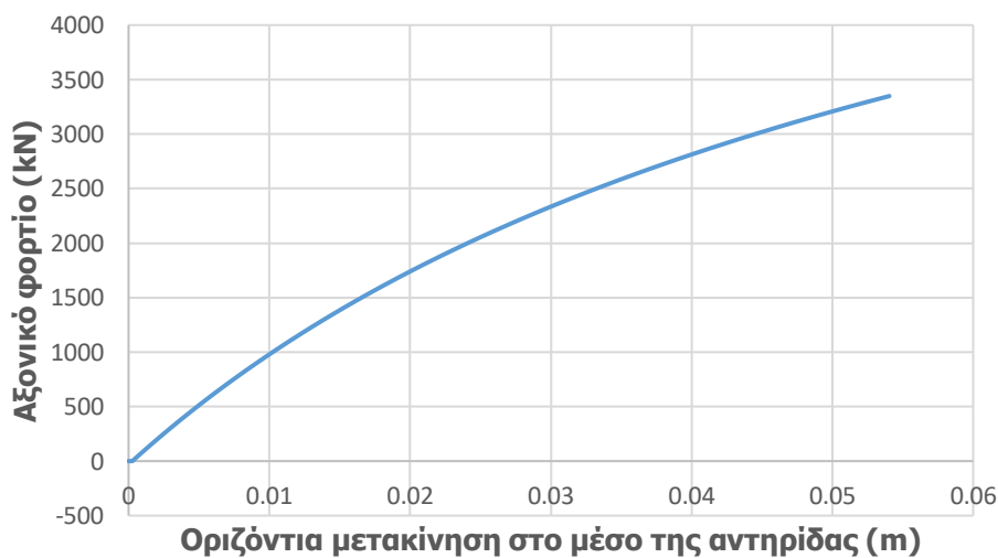
Σχήμα 4-71: Δρόμος ισορροπίας αντηρίδας άνω στάθμης διατομής CHS508/16 για μετακίνηση στο οριζόντιο επίπεδο από ανάλυση GNIA έως το αξονικό φορτίο σχεδιασμού
