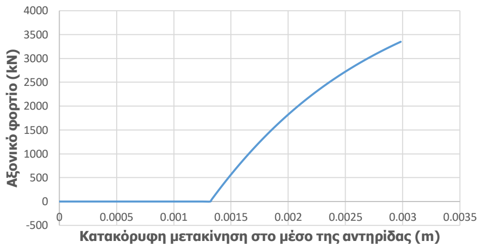
Σχήμα 4-70: Δρόμος ισορροπίας αντηρίδας άνω στάθμης διατομής CHS508/16 για μετακίνηση στο κατακόρυφο επίπεδο από ανάλυση GNIA έως το αξονικό φορτίο σχεδιασμού
