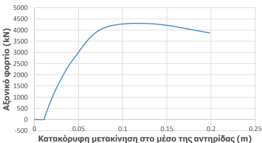
Σχήμα 3-19: Δρόμος ισορροπίας αντηρίδας άνω στάθμης διατομής CHS508/20 για μετακίνηση στο κατακόρυφο επίπεδο από ανάλυση GMNIA
