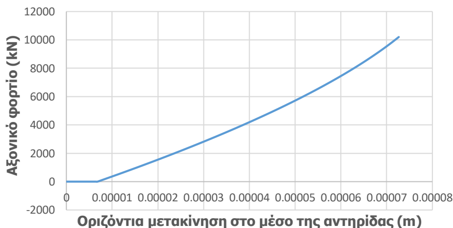
Σχήμα 4-57: Δρόμος ισορροπίας αντηρίδας κάτω στάθμης διατομής CHS610/20 για μετακίνηση στο οριζόντιο επίπεδο από ανάλυση GNIA έως το αξονικό φορτίο σχεδιασμού
