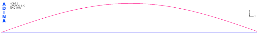
Σχήμα 3-29: 2 η ιδιομορφή λυγισμού στο οριζόντιο επίπεδο xy για την διατομή CHS457/16 αντηρίδας άνω στάθμης από γραμμική ανάλυση λυγισμού
