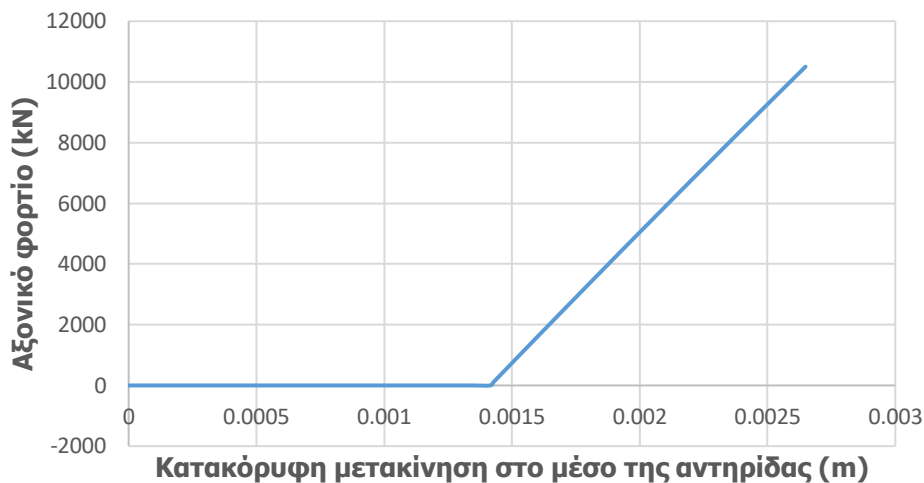
Σχήμα 4-44: Δρόμος ισορροπίας αντηρίδας κάτω στάθμης διατομής CHS610/40 για μετακίνηση στο κατακόρυφο επίπεδο από ανάλυση GNIA έως το αξονικό φορτίο σχεδιασμού
