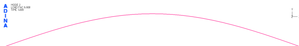
Σχήμα 3-22: 2 η ιδιομορφή λυγισμού στο οριζόντιο επίπεδο xy για την διατομή CHS508/16 αντηρίδας άνω στάθμης από γραμμική ανάλυση λυγισμού
