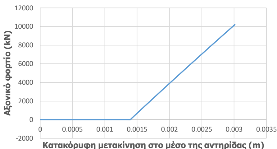
Σχήμα 4-56: Δρόμος ισορροπίας αντηρίδας κάτω στάθμης διατομής CHS610/20 για μετακίνηση στο κατακόρυφο επίπεδο από ανάλυση GNIA έως το αξονικό φορτίο σχεδιασμού
