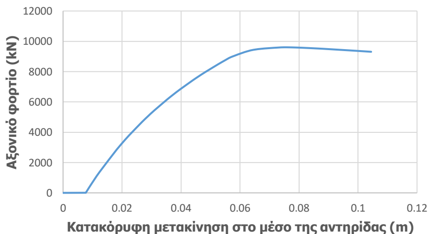
Σχήμα 3-47: Δρόμος ισορροπίας αντηρίδας κάτω στάθμης διατομής CHS610/30 για μετακίνηση στο κατακόρυφο επίπεδο από ανάλυση GMNIA
