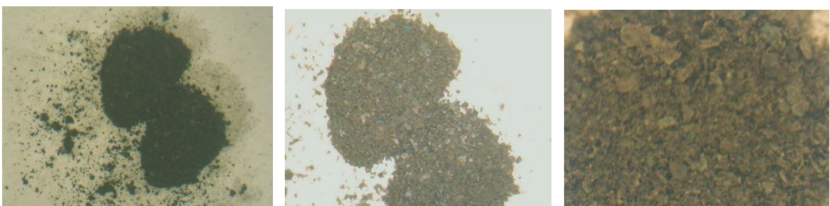
Εικόνα 59: Δείγμα 7 καφέ μαύρου χρώματος, πολωμένο φως (x30,x50,x120)
