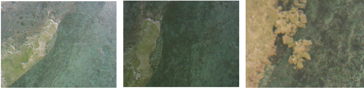
Εικόνα 248: Σημείο A_Δ_1 Οργανικές επικαθίσεις, μη πολωμένο φως (x30, x50, x120)
