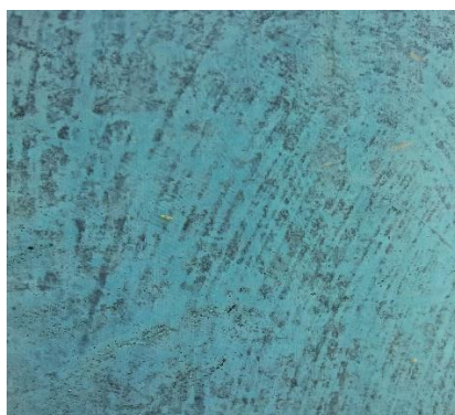
Εικόνα 240: Πράσινη επικαθήση-προϊόν διάβρωσης
