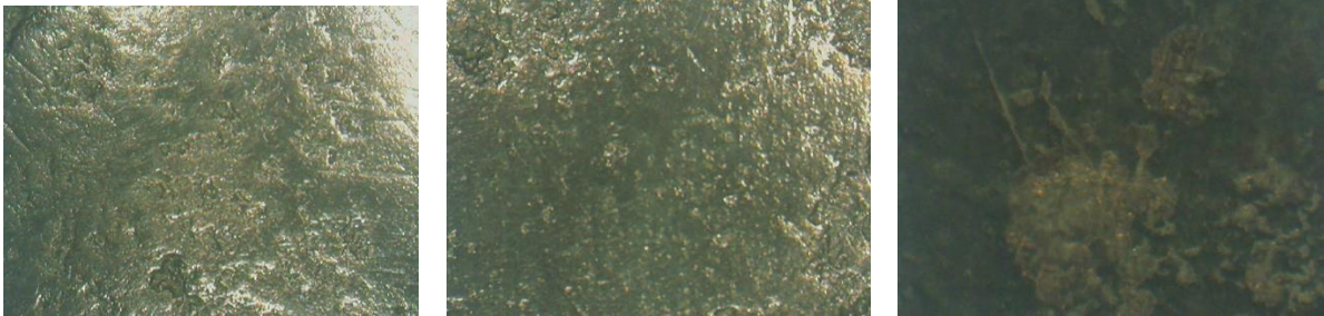
Εικόνα 167: Σημείο F_2_1_Δ_1, Καφέ μαύρη περιοχή, μη πολωμένο φως (x30,x50,x120)
