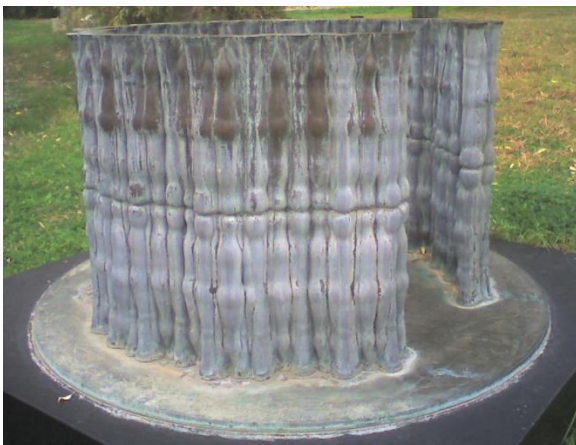
Εικόνα 234: Υπόλευκη και μαύρη επικάλυψη-προϊόν διάβρωσης στην εξωτερική περίμετρο, συνεφιασμένη ημέρα
