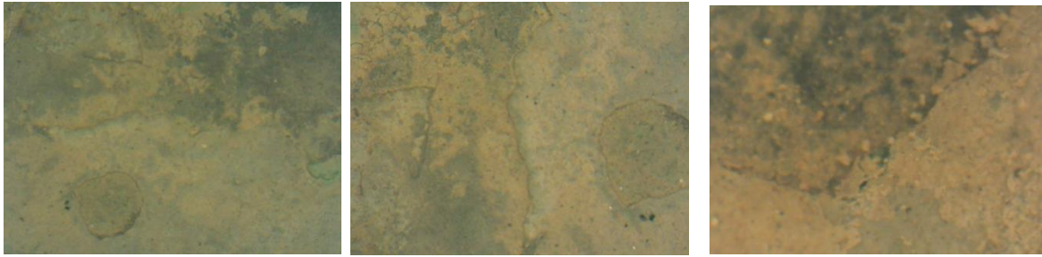
Εικόνα 205: Σημείο N_Δ17, καφέ-πράσινη επικάθιση-προϊόν διάβρωσης, μη πολωμένο φως (x30,x50,x120)
