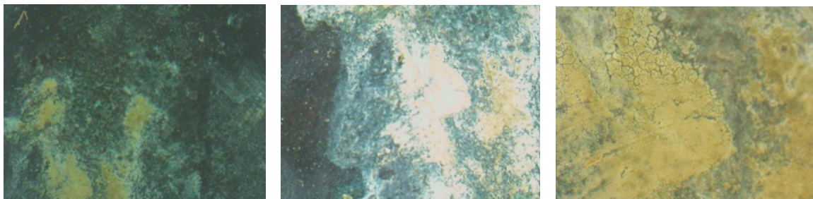
Εικόνα 133: Σημείο B_5_1_Δ_1, επικάλυψη χρώματος κίτρινου χρώματος, πολωμένο φως (x30,x50,x120)
