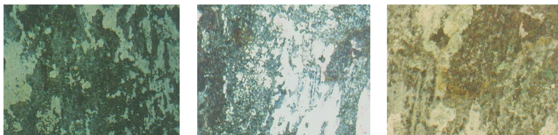
Εικόνα 111: Σημείο F_3_1_Δ_2, επικάλυψη- προϊόν διάβρωσης υπόλευκου χρώματος σε μορφή κηλίδων, πολωμένο φως (x30,x50,x120)
