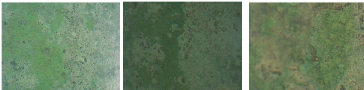
Εικόνα 219: Σημείο N_Δ13, ανοιχτό πράσινη επικάθιση-προϊόν διάβρωσης, μη πολωμένο φως(x30,x50,x120)
