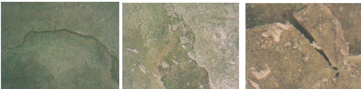
Εικόνα 250: Σημείο N_Δ_5 Ρωγμή και ανάγλυφο, μη πολωμένο φως (x30, x50, x120)
