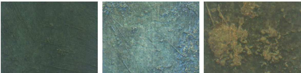
Εικόνα 168: Σημείο F_2_1_Δ_1, Καφέ μαύρη περιοχή, πολωμένο φως (x30,x50,x120)
