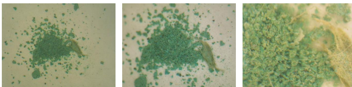
Εικόνα 78: Δείγμα 3 πράσινου χρώματος, πολωμένο φως (x30,x50,x120)
