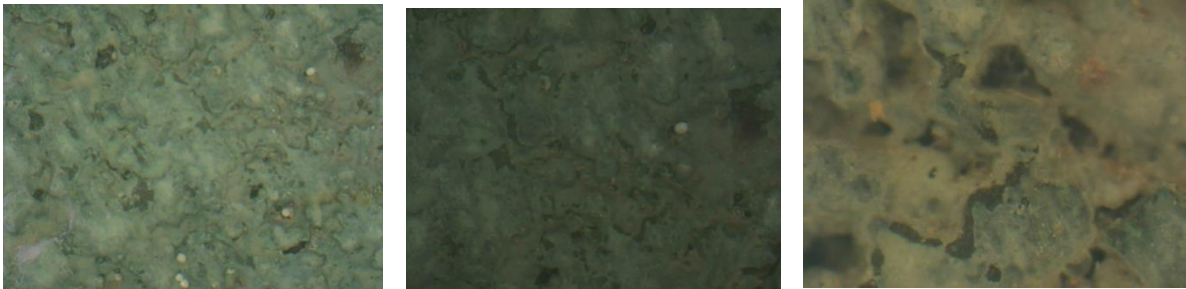
Εικόνα 252: Σημείο N_Δ_3 Οπές, μη πολωμένο φως (x30, x50, x120)
