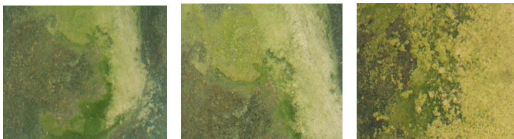
Εικόνα 104: Σημείο F_1_1_Δ_1, περιπτώματα από πουλιά, μη πολωμένο φως (x30,x50,x120)
