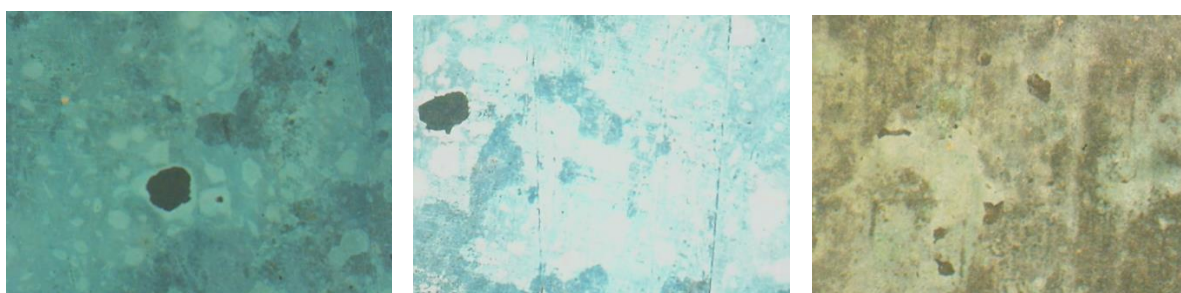
Εικόνα 243: Σημείο B_Δ_2 Έντονα πράσινη επικάλυψη-προϊόν διάβρωσης, πολωμένο φως (x30, x50, x120)
