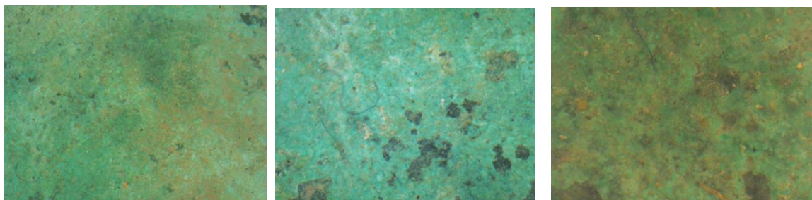
Εικόνα 119: Σημείο F_4_2_Δ_2, επικάλυψη- προϊόν διάβρωσης σε ανοιχτό πράσινο χρώμα, πολωμένο φως (x30,x50,x120)
