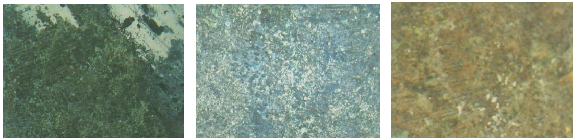
Εικόνα 131: Σημείο B_4_3_Δ_1, αρχή δημιουργίας επικάλυψης-προϊόντος διάβρωσης υπόλευκου χρώματος, πολωμένο φως (x30,x50,x120)
