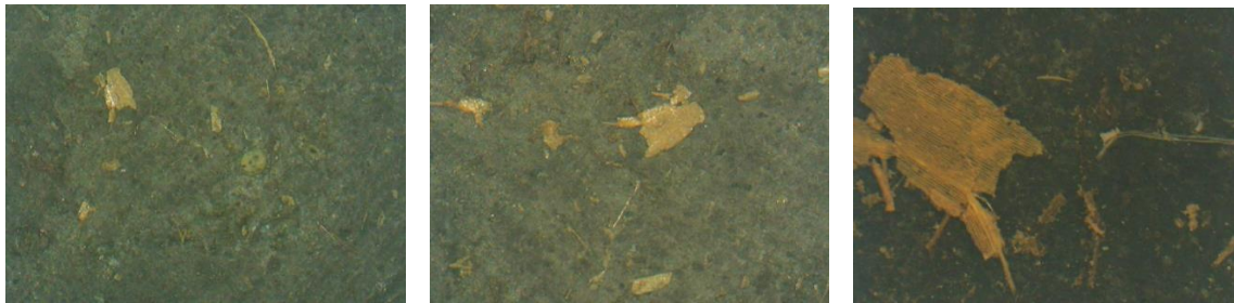
Εικόνα 120: Σημείο F_4_2_Δ_4, Σκωρία , μη πολωμένο φως (x30,x50,x120)
