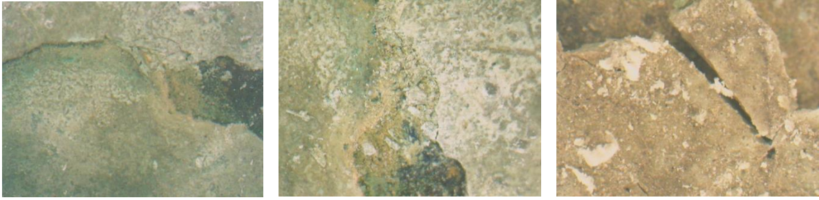
Εικόνα 251: Σημείο N_Δ_5 Ρωγμή και ανάγλυφο, πολωμένο φως (x30, x50, x120)
