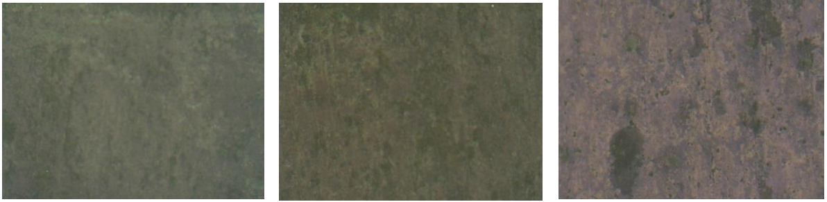
Εικόνα 244: Σημείο A_Δ_2 Καφέ επικάλυψη-προϊόν διάβρωσης, μη πολωμένο φως (x30, x50, x120)
