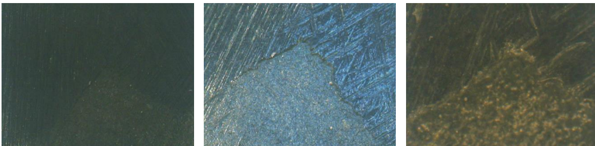
Εικόνα 179: Σημείο B_3_2_Δ_1, καθαρή περιοχή, πολωμένο φως (x30,x50,x120)
