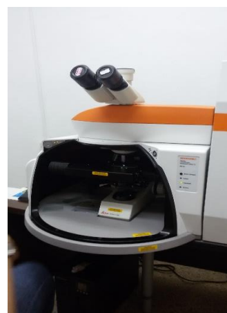
Εικόνα 56: Συσκευή φασματοσκοπίας μ-Raman
