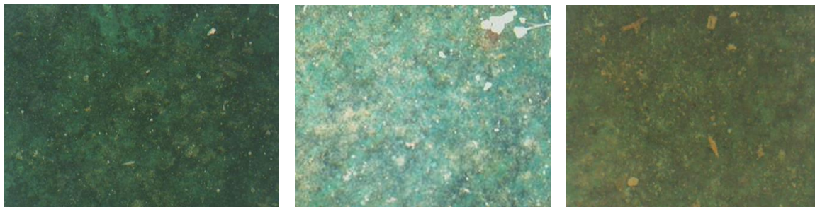
Εικόνα 115: Σημείο F_4_1_Δ_1, επικάθηση- προϊόν διάβρωσης σε σκούρο πράσινο χρώμα, πολωμένο φως (x30,x50,x120)
