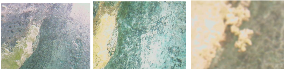
Εικόνα 249: Σημείο A_Δ_1 Οργανικές επικαθίσεις, πολωμένο φως (x30, x50, x120)
