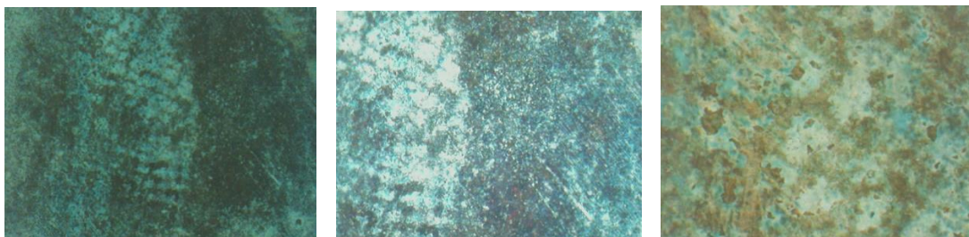
Εικόνα 127: Σημείο B_2_1_Δ_1 επικάθηση-προϊόν διάβρωσης πράσινου χρώματος, πολωμένο φως (x30,x50,x120)
