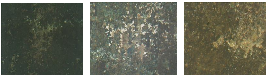
Εικόνα 109: Σημείο F_2_1_Δ_1, Καφέ - μαύρη περιοχή, πολωμένο φως (x30,x50,x120)
