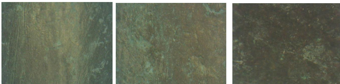
Εικόνα 221: Σημείο E_Δ5, σχετικά καθαρή εσωτερική επιφάνεια, μη πολωμένο φως (x30,x50,x120)
