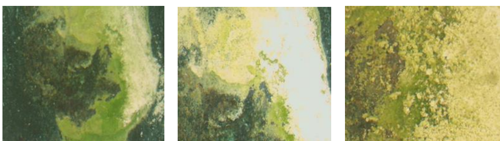
Εικόνα 105: Σημείο F_1_1_Δ_1, περιπτώματα από πουλιά, πολωμένο φως (x30,x50,x120)
