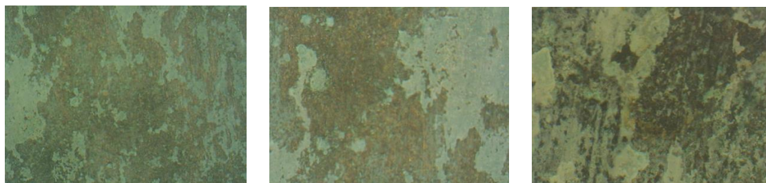
Εικόνα 110: Σημείο F_3_1_Δ_2, επικάλυψη- προϊόν διάβρωσης υπόλευκου χρώματος σε μορφή κηλίδων, μη πολωμένο φως (x30,x50,x120)
