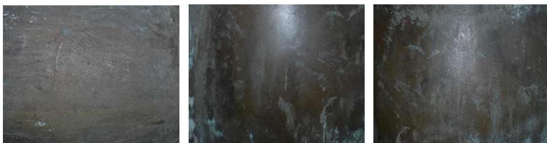
Εικόνα 100 : Μαύρες επικαθίσεις-προϊόντα διάβρωσης
