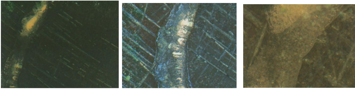
Εικόνα 212: Σημείο B_Δ1, Ρωγμή, πολωμένο φως (x30,x50,x120)
