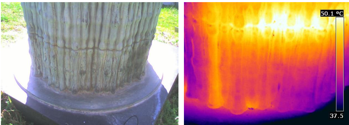
Εικόνα 230: Σημείο συγκόλλησης στην εξωτερική περίμετρο σε ηλιόλουστη ημέρα
