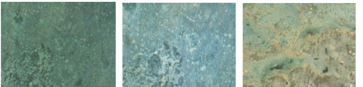
Εικόνα 247: Σημείο Μέτρηση N_Δ_1 Υπόλευκη - πράσινη επιφάνεια, πολωμένο φως (x30, x50, x120)
