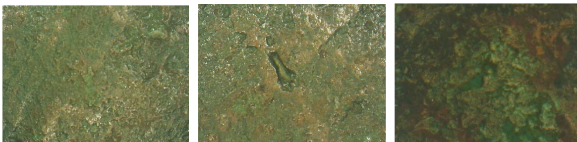
Εικόνα 171: Σημείο F_4_1_Δ_1, πράσινη περιοχή με καφέ στίγματα, μη πολωμένο φως (x30,x50,x120)
