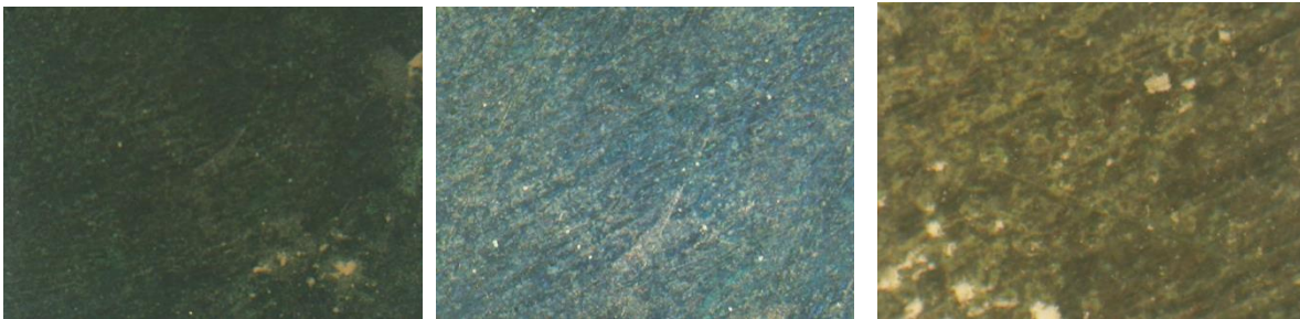
Εικόνα 214: Σημείο B_Δ2, σχετικά καθαρή επιφάνεια, πολωμένο φως (x30,x50,x120)
