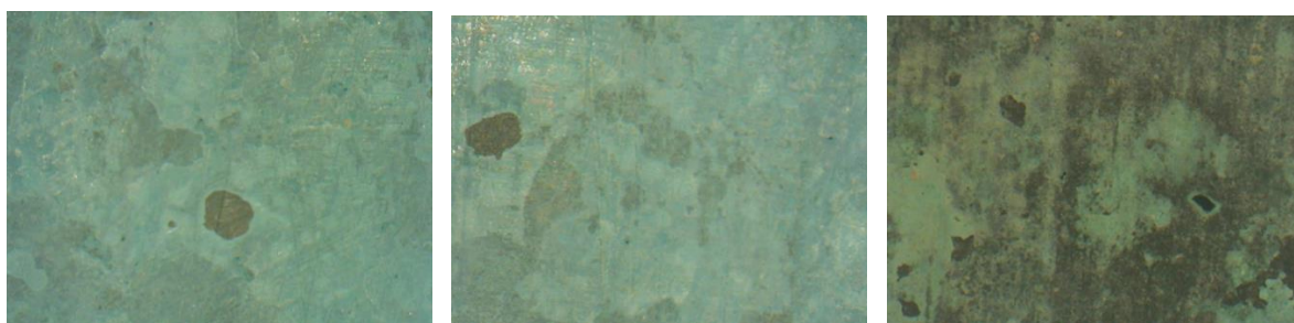
Εικόνα 242: Σημείο B_Δ_2 Έντονα πράσινη επικάλυψη-προϊόν διάβρωσης, μη πολωμένο φως (x30, x50, x120)
