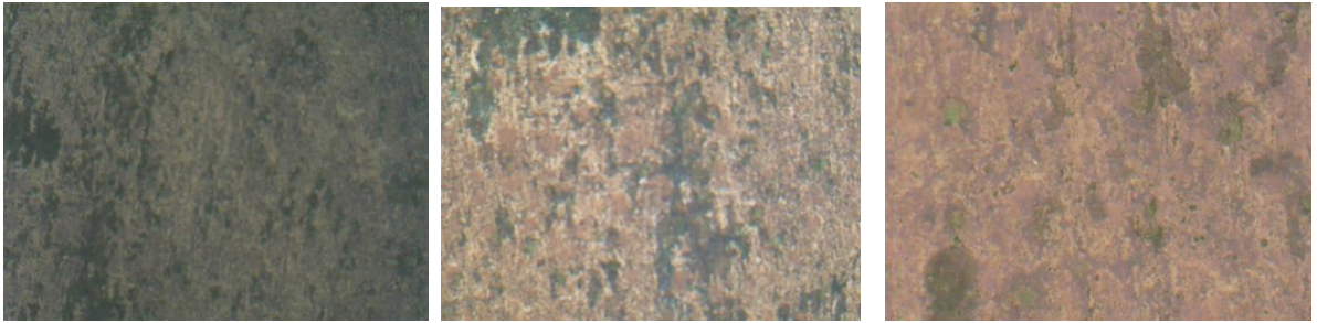
Εικόνα 245: Σημείο A_Δ_2 Καφέ επικάλυψη-προϊόν διάβρωσης, πολωμένο φως (x30, x50, x120)
