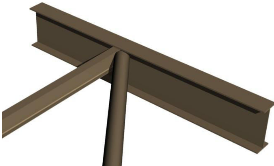
Σχήμα 10.5: Συγκολλητή σύνδεση κύριας δοκού-διαδοκίδας και διαγωνίων συνδέσμων
