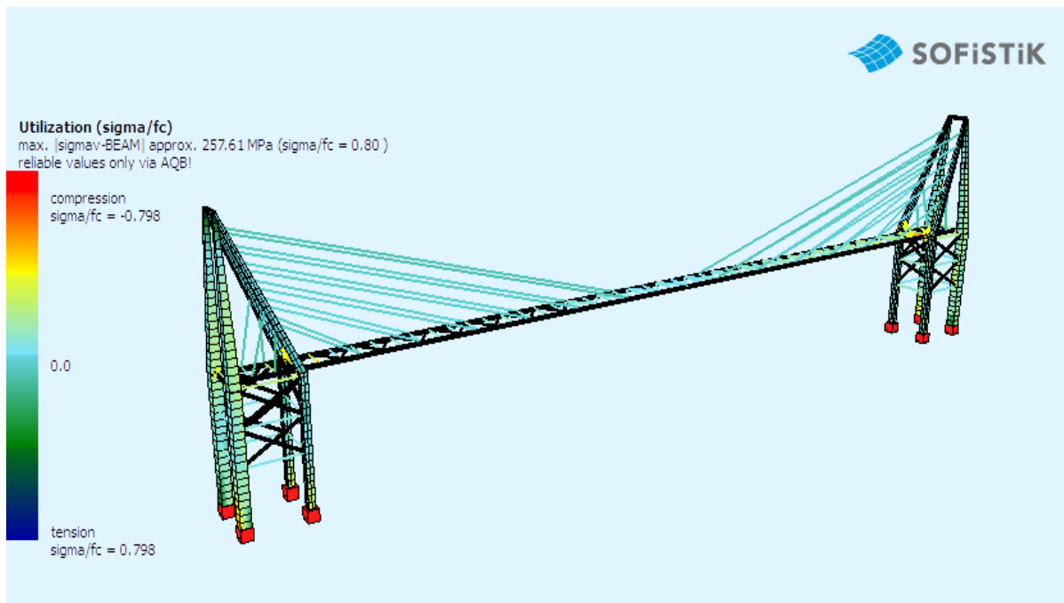
Σχήμα 6.9 Στάδιο μετά την ολοκλήρωση της κατασκευής του καταστρώματος και της τοποθέτησης του ξύλινου παρκέ
