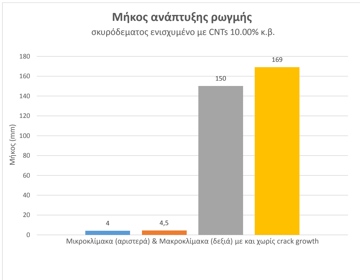
Σχήμα 3.34: Ραβδόγραμμα σύγκρισης διάδοσης ρωγμής σε δοκίμιο με και χωρίς CNTs σε μικρο και μακροκλίμακα.
