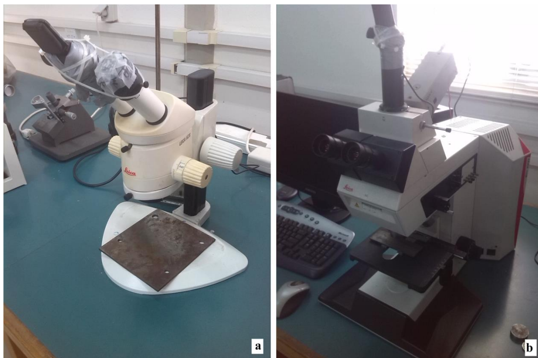
Εικόνα 70. Εξοπλισμός που χρησιμοποιήθηκε για την παρατήρηση των δοκιμίων: Στερεοσκόπιο (a) και οπτικό μικροσκόπιο (b) για την παρατήρηση της μορφολογίας των συνθέτων υλικών, της διασποράς των εγκλεισμάτων και την ποιότητα εμποτισμού.
