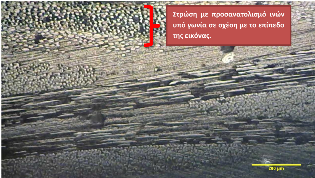
Εικόνα 75. Άποψη από οπτικό μικροσκόπιο (μεγέθυνση x10) συνθέτου υλικού με ενίσχυση Twill 2x2 [45/0/0/-45] και 2% w.t. GNPs.
