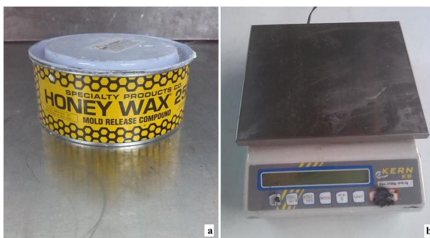
Εικόνα 57. Ειδικό κερί για καλούπια (α) που χρησιμοποιήθηκε για την επικάλυψη των πάγκων εργασίας και ηλεκτρονική ζυγαριά (β) για την προετοιμασία του μίγματος ρητίνης.
