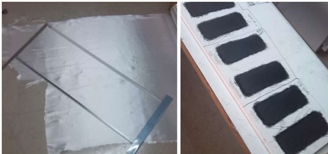
Εικόνα 48. Απόψεις από την εκτύλιξη του ρολού του υαλοϋφάσματος ενίσχυσης και από την παρασκευή των σύνθετων υλικών.
