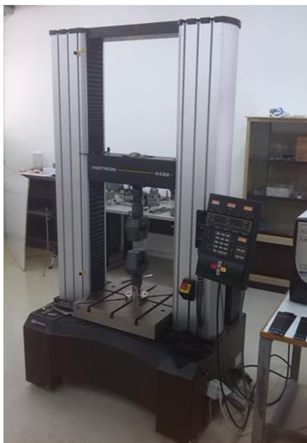
Εικόνα 47. Μηχανή μετρήσεων INSTRON 4482 και τα χαρακτηριστικά λειτουργίας της [30].
