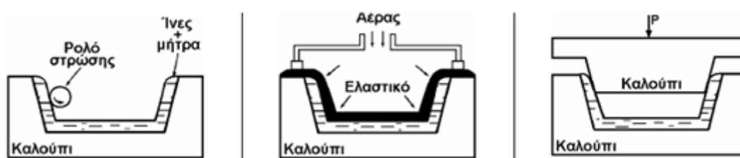
Εικόνα 4. Χύτευση σε διαιρετό καλούπι. [3]
