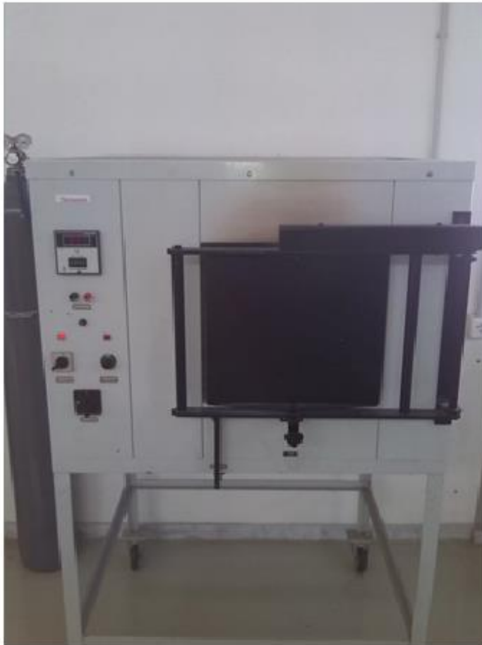
Εικόνα 65. Ο εργαστηριακός κλίβανος (αριστερά) που χρησιμοποιήθηκε για τη θερμική θεραπεία δοκιμίων (δεξιά) με ενίσχυση μονοδιευθυντικού υαλοϋφάσματος σε διάταξη στρώσεων [0/90/0/90] και 2% wt GNPs.
