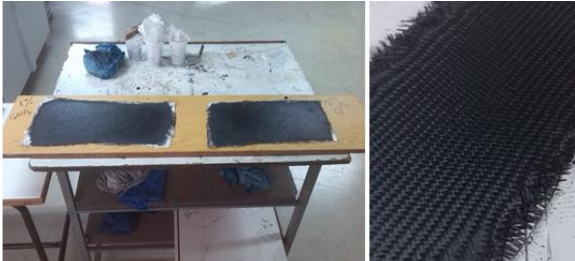
Εικόνα 58. Απεικόνιση σύνθετων υλικών έπειτα από σκλήρυνση σε συνθήκες δωματίου για επτά ημέρες.
