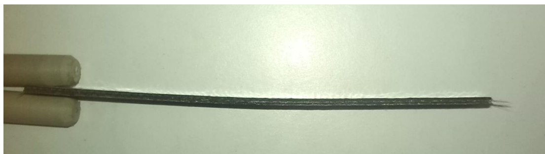
Εικόνα 69. Άποψη προφίλ δοκιμίου μονοδιευθυντικής ενίσχυσης και 5% w.t. GNPs, κατόπιν κάμψης.
