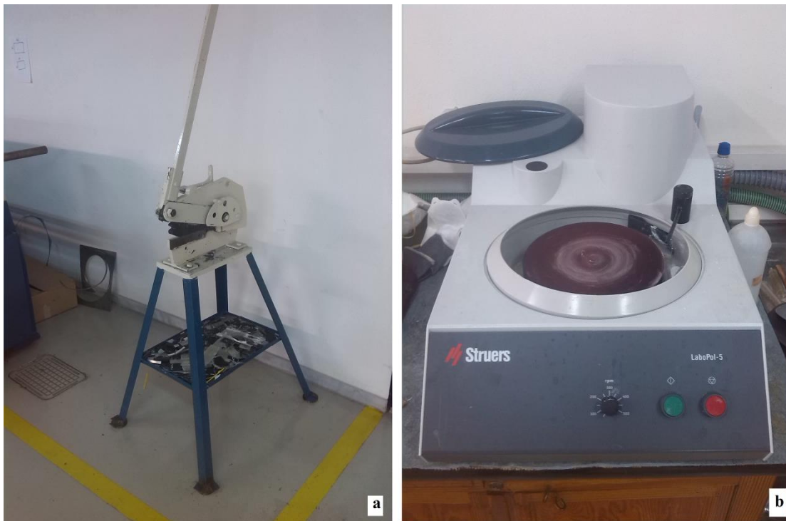
Εικόνα 59. Κόφτης ελασμάτων (a) για την κοπή των σύνθετων υλικών στις επιθυμητές διαστάσεις δοκιμίων και τριβείο (b) για την λείανση των επιφανειών των (προς παρατήρηση σε μικροσκόπιο) δοκιμίων.
