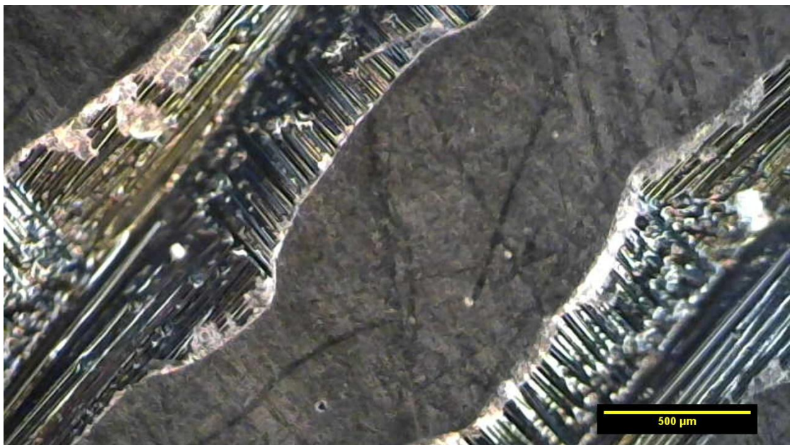
Εικόνα 64. Άποψη από οπτικό μικροσκόπιο (μεγέθυνση x5) πίσω όψης ανεπαρκώς εμποτισμένου δοκιμίου με μονοδιευθυντική ενίσχυση και 2% GNPs.
