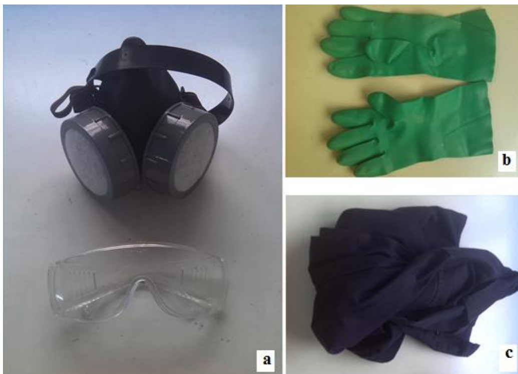
Εικόνα 49. Εξοπλισμός ασφαλείας που χρησιμοποιήθηκε κατά την παρασκευή των συνθέτων υλικών: μάσκα μισού προσώπου για προστασία αναπνοής με φίλτρα ABEK(2) και P(3) (πάνω) και προστατευτικά γυαλιά (κάτω) (a), προστατευτικά γάντια (b) και χιτώνιο εργασίας (c).
