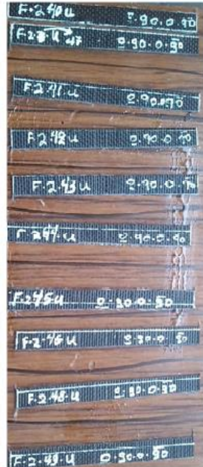
Εικόνα 65. Ο εργαστηριακός κλίβανος (αριστερά) που χρησιμοποιήθηκε για τη θερμική θεραπεία δοκιμίων (δεξιά) με ενίσχυση μονοδιευθυντικού υαλοϋφάσματος σε διάταξη στρώσεων [0/90/0/90] και 2% wt GNPs.
