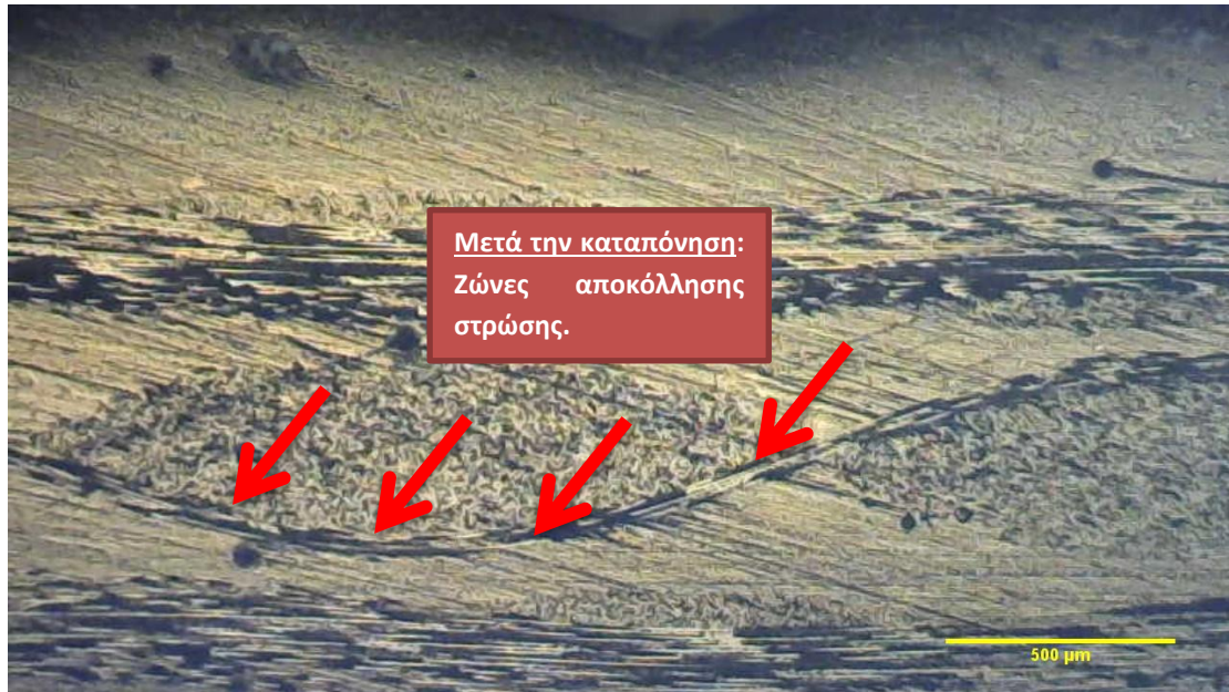
Εικόνα 79. Άποψη από οπτικό μικροσκόπιο (μεγέθυνση x5) συνθέτου υλικού με μονοδιευθυντική ενίσχυση [0/90/0/90] και 1% w.t. GNPs κατόπιν καμπτικής καταπόνησης.
