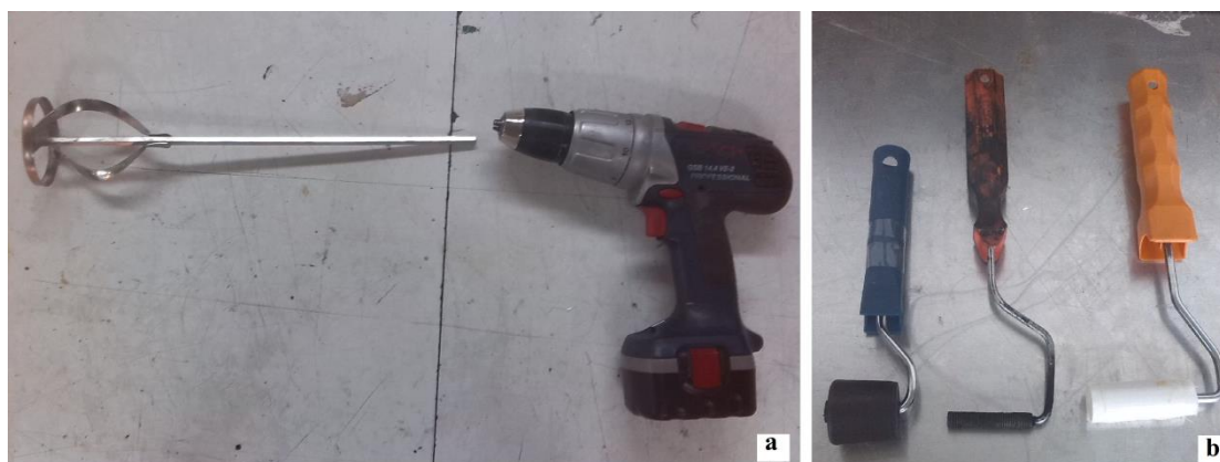
Εικόνα 60. Εξοπλισμός που χρησιμοποιήθηκε κατά την παρασκευή των σύνθετων υλικών. Ηλεκτρικό δραπενοκατσάβιδο και μύτη ανάδευσης (a) για την ανάδευση του συστήματος ρητίνης και ρολά για τον εμποτισμό των υφασμάτων με ρητίνη (b).
