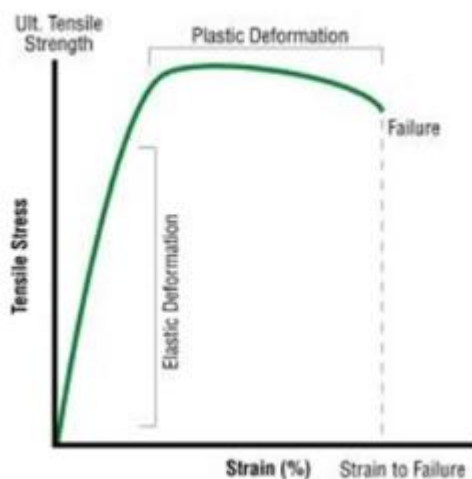
Σχήμα 1. Τυπικό διάγραμμα εφελκυσμού τάσης - παραμόρφωσης ρητινών. [6]
