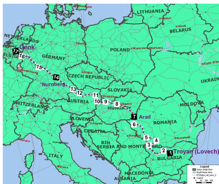
Εικόνα 24: Εύρεση επί μέρους σιδηροδρομικών αποστάσεων και βέλτιστης διαδρομής, μέσω του λογισμικού TransCAD και της βάσης δεδομένων ETIS-Plus
