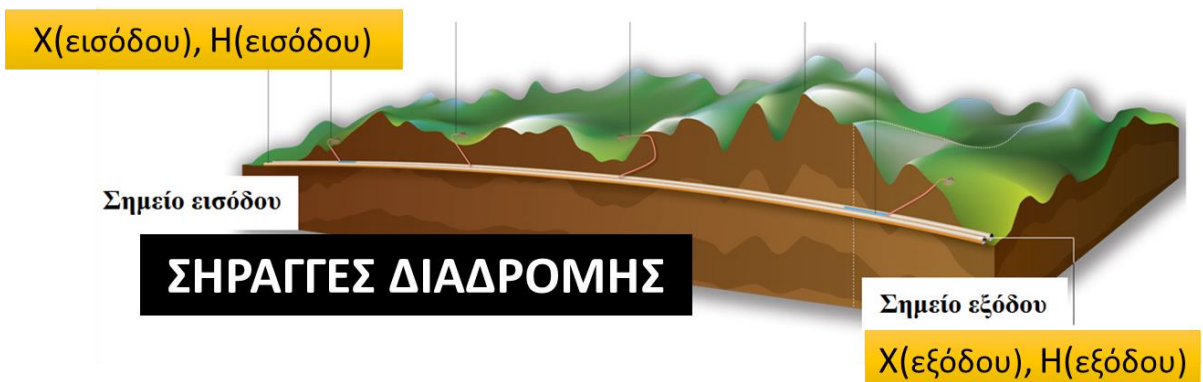
Εικόνα 17: Εκτίμηση κλίσεων σήραγγων μέσω των υψομέτρων εισόδου και εξόδου
