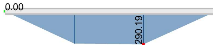
Σχήμα 4.24: Διάγραμμα ροπών κάμψης κύριας δοκού στη φάση λειτουργίας (kNm)
