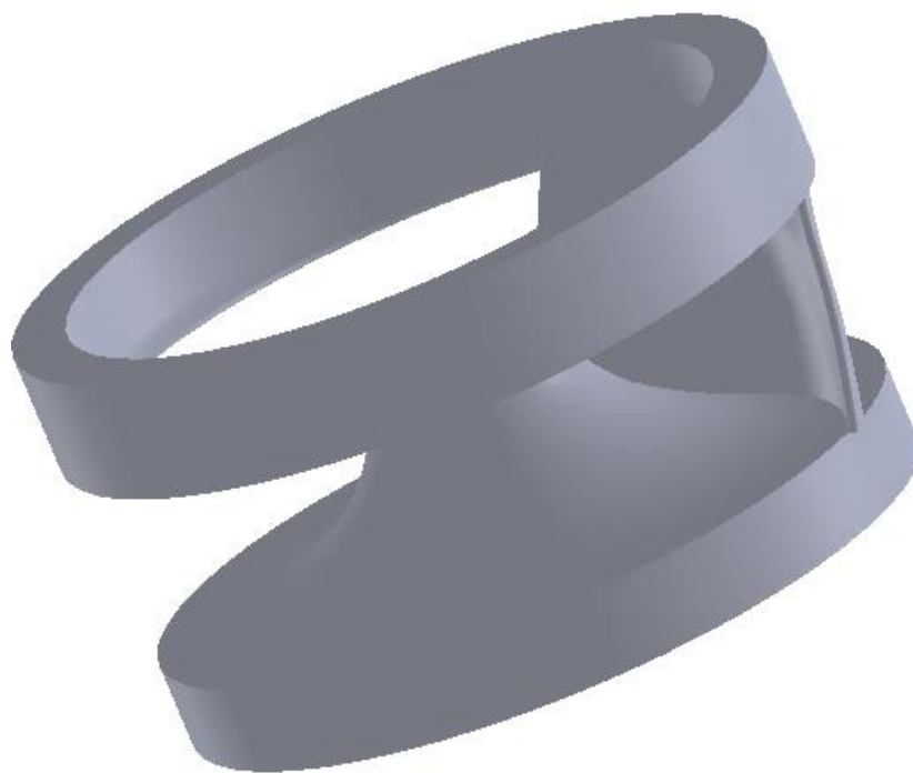
Σχήμα 7.37: Πτερύγιο γεωμετρίας δρομέα οκτώ πτερυγίων με πλήρη και στεφάνη
