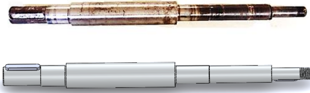
Σχήμα 3.8: Άτρακτος Επάνω: Πραγματικό μοντέλο | Κάτω: Μοντέλο CAD
