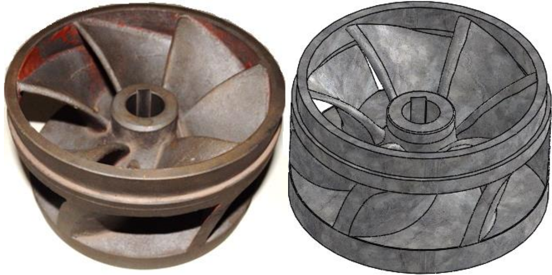
Σχήμα 5.1: Ισομετρική όψη πτερωτής πριν την επεξεργασία Αριστερά: Πραγματικό μοντέλο | Δεξιά: Μοντέλο CAD
