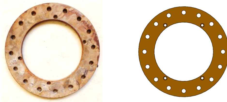
Σχήμα 3.9: Φλάντζα με ειδική διαμόρφωση για τοποθέτηση ρυθμιστικών περυγίων Αριστερά: Πραγματικό μοντέλο | Δεξιά: Μοντέλο CAD
