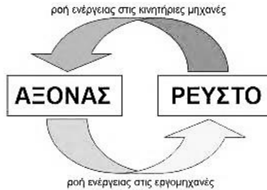
Σχήμα1.2: Ροή ενέργειας στις στροβιλομηχανές
