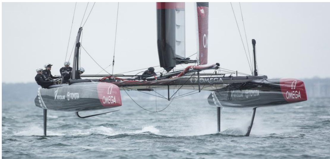
Εικόνα 1.11 Ένα daggerboard 'κατεβασμένο' κι ένα 'ανεβασμένο'
