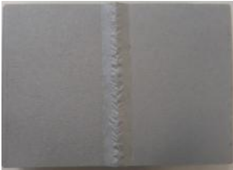
Εικόνα 5.43 α): Επιφάνεια του δοκιμίου ΙΑ12 έπειτα από την αμμοβολή, και πριν την εισαγωγή του στο θάλαμο αλατονέφωσης
