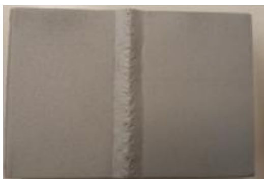
Εικόνα 5.33 α): Επιφάνεια του δοκιμίου ΙΑ2 έπειτα από την αμμοβολή, και πριν την εισαγωγή του στο θάλαμο αλατονέφωσης
