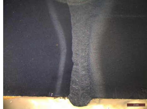
Εικόνα 5.6: Κατώτερο μέρος της συγκόλλησης, όπου εργάζεται το laser (Laser Zone)
