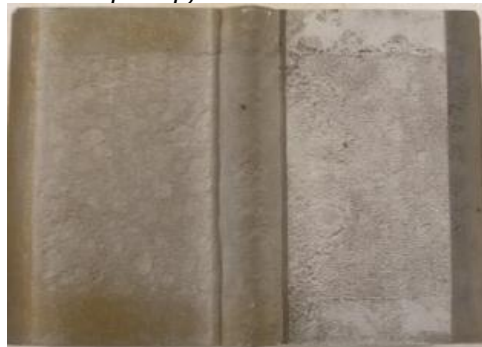
Εικόνα 5.43 γ): Δοκίμιο ΙΑ12 μετά την απομάκρυνση των προϊόντων διάβρωσης
