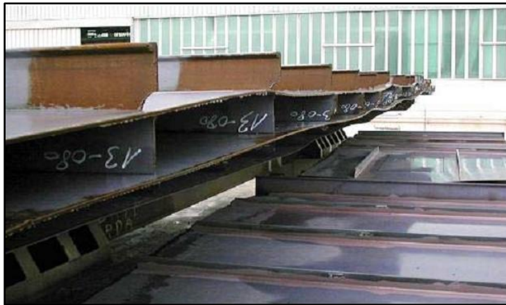
Εικόνα 2.4 : Παραμορφωμένα deck panels επιβατηγού πλοίου που συγκολλήθηκαν με συγκόλληση τόξου.[26]
