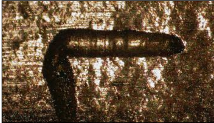
Εικόνα 2.3 : Γραμμική ένωση πόρων, γνωστή ως «worm tracks»
