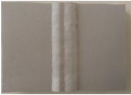
Εικόνα 5.47 α): Επιφάνεια του δοκιμίου IIIB2 έπειτα από την αμμοβολή, και πριν την εισαγωγή του στο θάλαμο αλατονέφωσης
