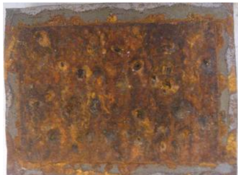
Εικόνα 5.53 β): Διαβρωμένη επιφάνεια δοκιμίου IIA1 μετά την έξοδό του από τον θάλαμο αλατονέφωσης
