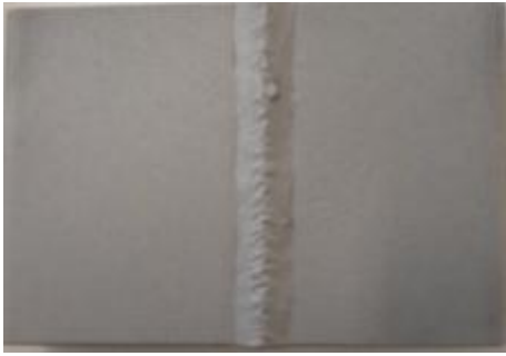
Εικόνα 5.37 α): Επιφάνεια του δοκιμίου ΙΑ6 έπειτα από την αμμοβολή, και πριν την εισαγωγή του στο θάλαμο αλατονέφωσης
