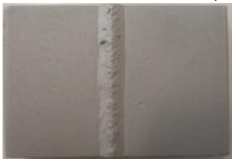
Εικόνα 5.35 α): Επιφάνεια του δοκιμίου ΙΑ4 έπειτα από την αμμοβολή, και πριν την εισαγωγή του στο θάλαμο αλατονέφωσης
