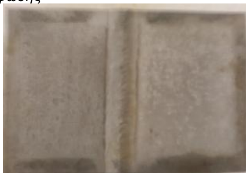
Εικόνα 5.42 γ): Δοκίμιο IA11* (interval) μετά την απομάκρυνση των προϊόντων διάβρωσης
