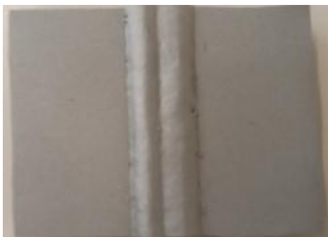
Εικόνα 5.44 α): Επιφάνεια του δοκιμίου IIB1 έπειτα από την αμμοβολή, και πριν την εισαγωγή του στο θάλαμο αλατονέφωσης
