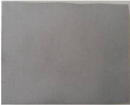
Εικόνα 5.55 α): Επιφάνεια του δοκιμίου IVC2 έπειτα από την αμμοβολή, και πριν την εισαγωγή του στο θάλαμο αλατονέφωσης
