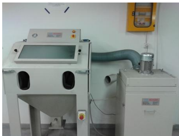
Εικόνα 4.11: Θάλαμος αμμοβολής του μηχανουργείου του ENT
