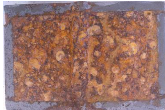
Εικόνα 5.41 β): Διαβρωμένη επιφάνεια δοκιμίου ΙΑ10* (interval) μετά την έξοδό του από τον θάλαμο αλατονέφωσης
