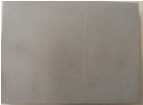
Εικόνα 5.52 α): Επιφάνεια του δοκιμίου IIA2 έπειτα από την αμμοβολή, και πριν την εισαγωγή του στο θάλαμο αλατονέφωσης
