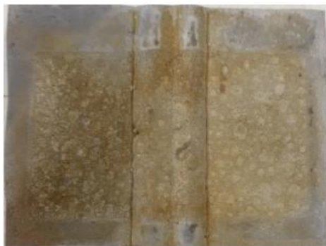
Εικόνα 5.44 γ): Δοκίμιο IIB1 μετά την απομάκρυνση των προϊόντων διάβρωσης
