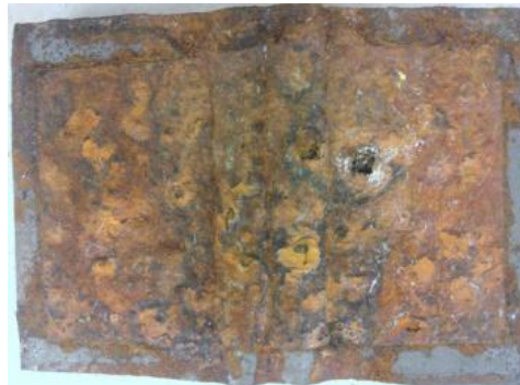
Εικόνα 5.51 β): Διαβρωμένη επιφάνεια δοκιμίου IVB2* ( interval ) μετά την έξοδό του από τον θάλαμο αλατονέφωσης
