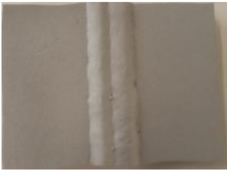
Εικόνα 5.46 α): Επιφάνεια του δοκιμίου IIB3 έπειτα από την αμμοβολή, και πριν την εισαγωγή του στο θάλαμο αλατονέφωσης
