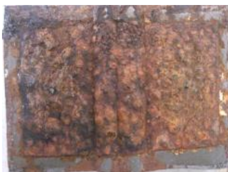
Εικόνα 5.45 β): Διαβρωμένη επιφάνεια δοκιμίου IIB2 μετά την έξοδό του από τον θάλαμο αλατονέφωσης
