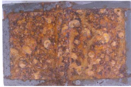
Εικόνα 5.40 β): Διαβρωμένη επιφάνεια δοκιμίου ΙΑ9* (interval) μετά την έξοδό του από τον θάλαμο αλατονέφωσης
