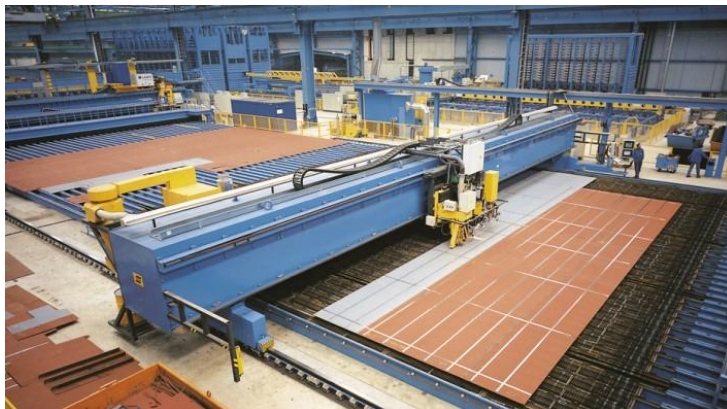
Εικόνα 2.5: Panel lines στο ναυπηγείο Meyer Werft όπου εφαρμόζονται οι μέθοδοι του laser
