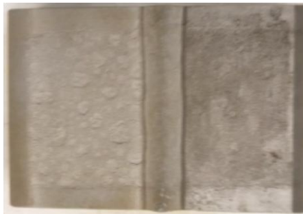
Εικόνα 5.37 γ): Δοκίμιο ΙΑ6 μετά την απομάκρυνση των προϊόντων διάβρωσης
