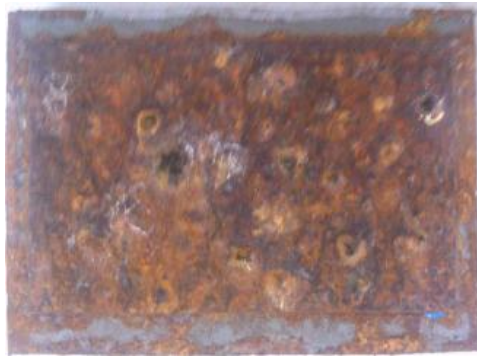
Εικόνα 5.55 β): Διαβρωμένη επιφάνεια δοκιμίου IVC2 μετά την έξοδό του από τον θάλαμο αλατονέφωσης
