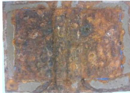
Εικόνα 5.47 β): Διαβρωμένη επιφάνεια δοκιμίου IIIB2 μετά την έξοδό του από τον θάλαμο αλατονέφωσης
