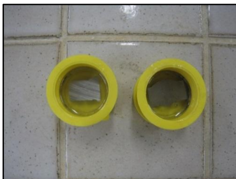
Εικόνα 4.2: Δοκίμια εμβυτισμένα σε εποξειδική ρητίνη
