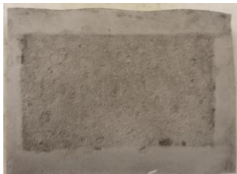
Εικόνα 5.54 γ): Δοκίμιο IIC2 μετά την απομάκρυνση των προϊόντων διάβρωσης
