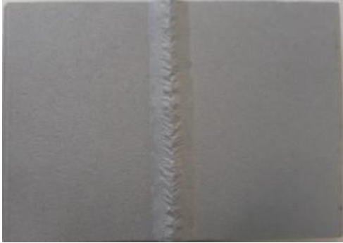
Εικόνα 5.31 α): Επιφάνεια του δοκιμίου έπειτα από την αμμοβολή, και πριν την εισαγωγή του στο θάλαμο αλατονέφωσης
