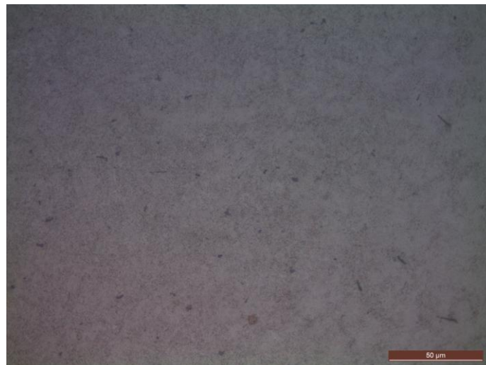
Εικόνα 5.10: Μικροσκοπική παρατήρηση της ΘΕΖ από την πλευρά του μετάλλου βάσης S690 του κατώτερου μέρους (Laser Zone) της υβριδικής συγκόλλησης Laser – MAG+Tandem S690-AH36.
