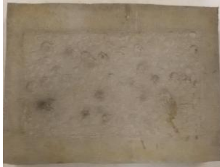
Εικόνα 5.52 γ): Δοκίμιο IIA2 μετά την απομάκρυνση των προϊόντων διάβρωσης
