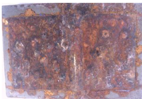
Εικόνα 5.42 β): Διαβρωμένη επιφάνεια δοκιμίου IA11* (interval) μετά την έξοδό του από τον θάλαμο αλατονέφωσης
