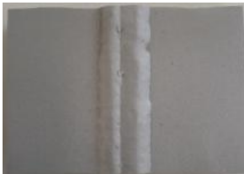
Εικόνα 5.48 α): Επιφάνεια του δοκιμίου IVB3 έπειτα από την αμμοβολή, και πριν την εισαγωγή του στο θάλαμο αλατονέφωσης
