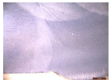
(στ) ΘΕΖ και μέταλλο βάσης AH36
