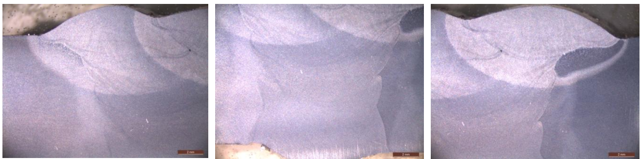
(α) Μέταλλο βάσης AH36, ΘΕΖ και ζώνη τήξης
