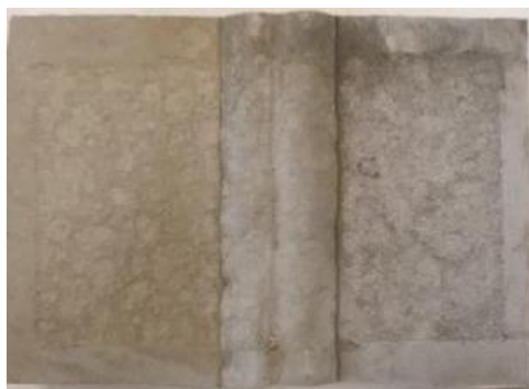
Εικόνα 5.51 γ): Δοκίμιο IVB2* (interval) μετά την απομάκρυνση των προϊόντων διάβρωσης
