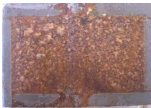
Εικόνα 5.33 β): Διαβρωμένη επιφάνεια δοκιμίου ΙΑ2 μετά την έξοδό του από τον θάλαμο αλατονέφωσης
