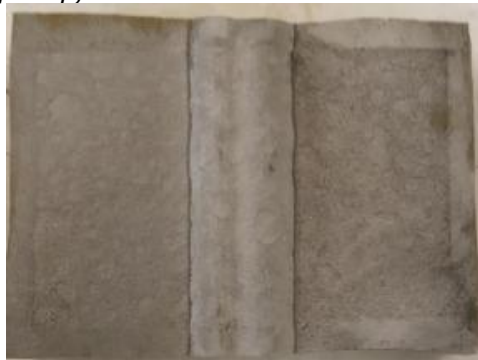
Εικόνα 5.50 γ): Δοκίμιο IVB1* ( interval ) μετά την απομάκρυνση των προϊόντων διάβρωσης
