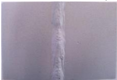
Εικόνα 5.34 α): Επιφάνεια του δοκιμίου ΙΑ3 έπειτα από την αμμοβολή, και πριν την εισαγωγή του στο θάλαμο αλατονέφωσης
