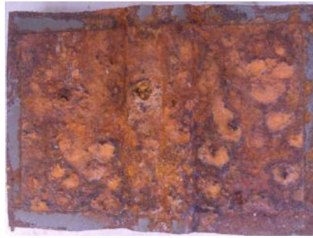
Εικόνα 5.50 β): Διαβρωμένη επιφάνεια δοκιμίου IVB1* ( interval ) μετά την έξοδό του από τον θάλαμο αλατονέφωσης
