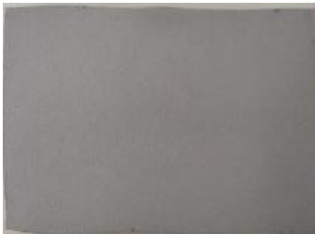
Εικόνα 5.54 α): Επιφάνεια του δοκιμίου IIC2 έπειτα από την αμμοβολή, και πριν την εισαγωγή του στο θάλαμο αλατονέφωσης
