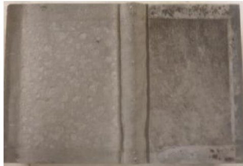
Εικόνα 5.40 γ): Δοκίμιο ΙΑ9* (interval) μετά την απομάκρυνση των προϊόντων διάβρωσης
