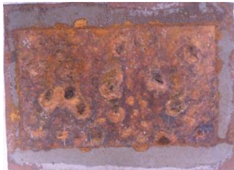
Εικόνα 5.54 β): Διαβρωμένη επιφάνεια δοκιμίου IIC2 μετά την έξοδό του από τον θάλαμο αλατονέφωσης
