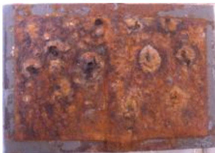
Εικόνα 5.35 β): Διαβρωμένη επιφάνεια δοκιμίου ΙΑ4 μετά την έξοδό του από τον θάλαμο αλατονέφωσης
