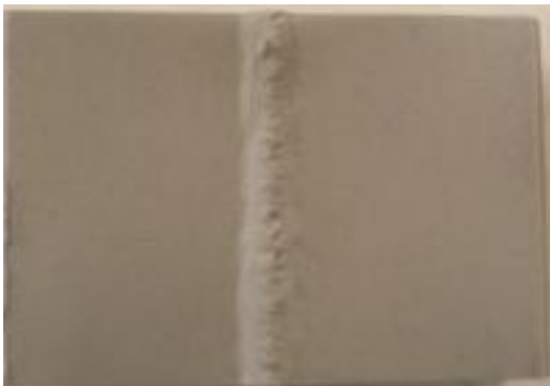
Εικόνα 5.41 α): Επιφάνεια του δοκιμίου ΙΑ10* (interval) έπειτα από την αμμοβολή, και πριν την εισαγωγή του στο θάλαμο αλατονέφωσης
