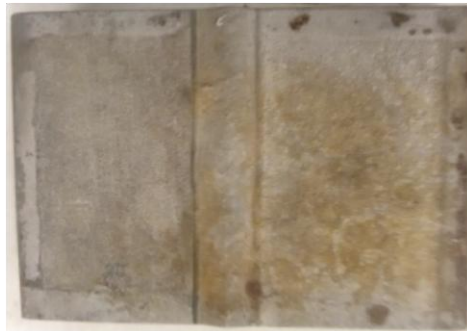
Εικόνα 5.35 γ): Δοκίμιο IA4 μετά την απομάκρυνση των προϊόντων διάβρωσης
