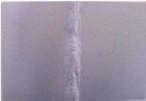
Εικόνα 5.39 α): Επιφάνεια του δοκιμίου IA8* (interval) έπειτα από την αμβολογή, και πριν την εισαγωγή του στο θάλαμο αλατονέφωσης
