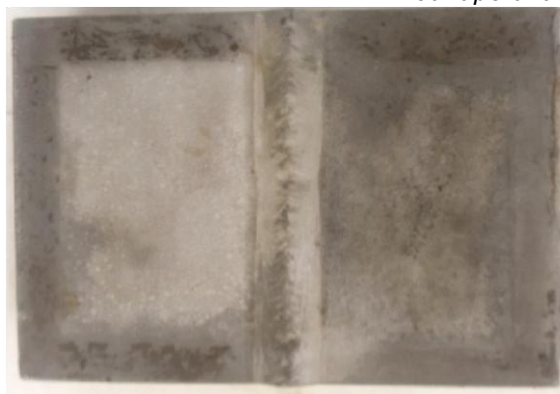
Εικόνα 5.32 γ): Δοκίμιο ΙΑ1 μετά την απομάκρυνση των προϊόντων διάβρωσης
