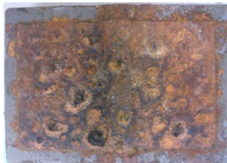
Εικόνα 5.38 β): Διαβρωμένη επιφάνεια δοκιμίου ΙΑ7* (interval) μετά την έξοδό του από τον θάλαμο αλατονέφωσης
