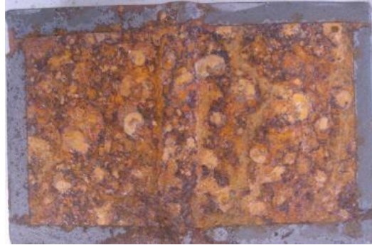
Εικόνα 5.31 β): Διαβρωμένη επιφάνεια δοκιμίου μετά την έξοδό του από τον θάλαμο αλατονέφωσης
