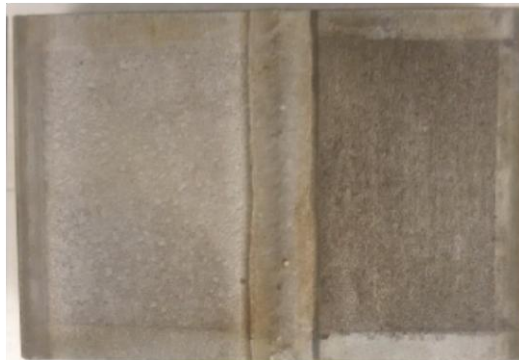
Εικόνα 5.39 γ): Δοκίμιο IA8* (interval) μετά την απομάκρυνση των προϊόντων διάβρωσης
