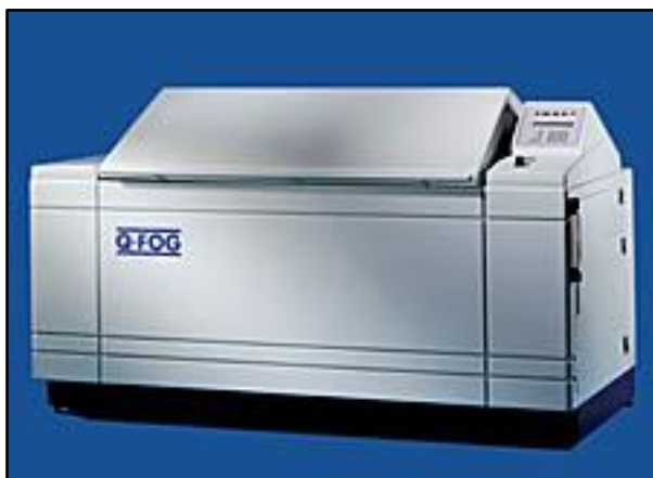
Εικόνα 4.10: Θάλαμος αλατονέφωσης (Q FOG CCT 1100)
