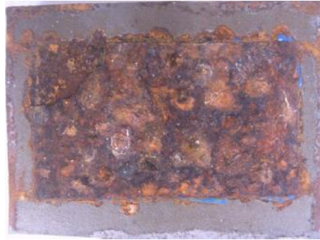
Εικόνα 5.52 β): Διαβρωμένη επιφάνεια δοκιμίου IIA2 μετά την έξοδό του από τον θάλαμο αλατονέφωσης
