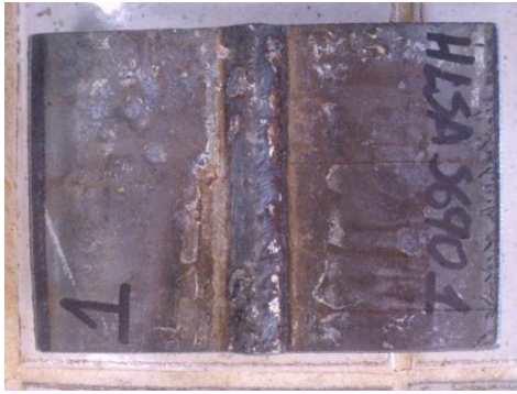
Εικόνα 4.12: Δοκίμιο Υβριδικής συγκόλλησης Laser- tandem τόξου AH36-S690 πριν την αμμοβολή
