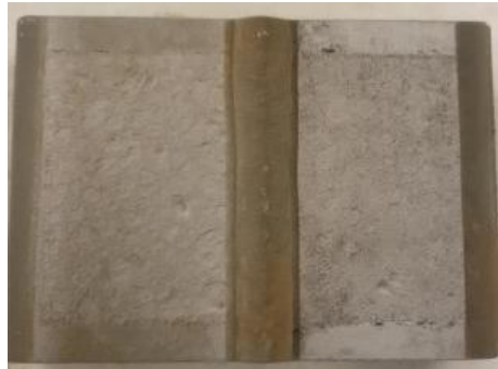
Εικόνα 5.38 γ): Δοκίμιο IA7* (interval) μετά την απομάκρυνση των προϊόντων διάβρωσης
