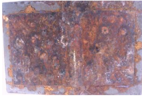
Εικόνα 5.37 β): Διαβρωμένη επιφάνεια δοκιμίου ΙΑ6 μετά την έξοδό του από τον θάλαμο αλατονέφωσης
