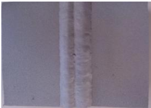
Εικόνα 5.49 α): Επιφάνεια του δοκιμίου III B3* (interval) έπειτα από την αμμοβολή, και πριν την εισαγωγή του στο θάλαμο αλατονέφωσης
