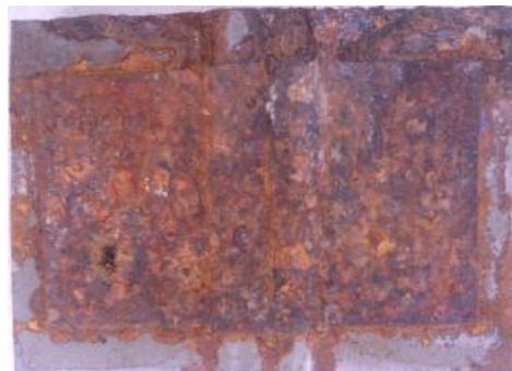
Εικόνα 5.48 β): Διαβρωμένη επιφάνεια δοκιμίου IVB3 μετά την έξοδό του από τον θάλαμο αλατονέφωσης
