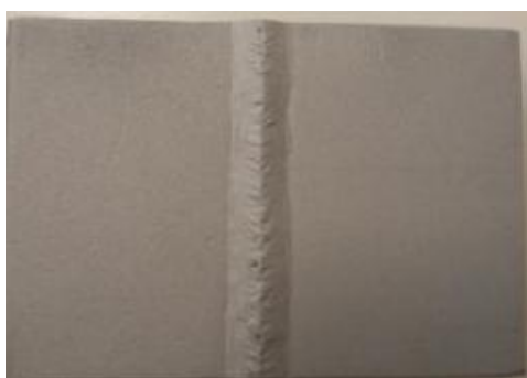
Εικόνα 5.42 α): Επιφάνεια του δοκιμίου IA11* (interval) έπειτα από την αμμοβολή, και πριν την εισαγωγή του στο θάλαμο αλατονέφωσης
