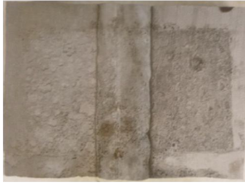
Εικόνα 5.48 γ): Δοκίμιο IVB3 μετά την απομάκρυνση των προϊόντων διάβρωσης
