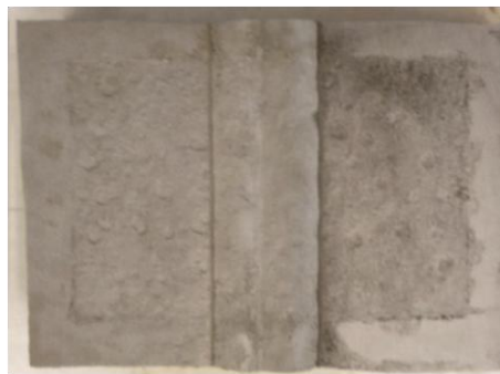
Εικόνα 5.47 γ): Δοκίμιο IIIB2 μετά την απομάκρυνση των προϊόντων διάβρωσης
