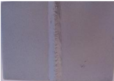
Εικόνα 5.38 α): Επιφάνεια του δοκιμίου ΙΑ7* (interval) έπειτα από την αμμοβολή, και πριν την εισαγωγή του στο θάλαμο αλατονέφωσης
