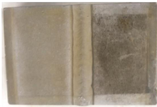
Εικόνα 5.41 γ): Δοκίμιο IA10* (interval) μετά την απομάκρυνση των προϊόντων διάβρωσης
