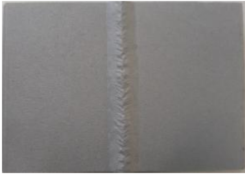
Εικόνα 5.40 α): Επιφάνεια του δοκιμίου ΙΑ9* (interval) έπειτα από την αμμοβολή, και πριν την εισαγωγή του στο θάλαμο αλατονέφωσης
