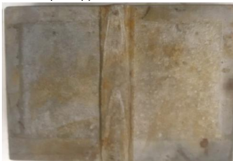
Εικόνα 5.34 γ): Δοκίμιο ΙΑ3 μετά την απομάκρυνση των προϊόντων διάβρωσης
