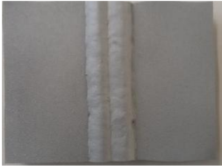
Εικόνα 5.50 α): Επιφάνεια του δοκιμίου IVB1* ( interval ) έπειτα από την αμμοβολή, και πριν την εισαγωγή του στο θάλαμο αλατονέφωσης
