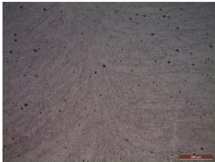
Εικόνα 5.10: Μικροσκοπική παρατήρηση της ζώνης τήξης του κατώτερου μέρους (Laser Zone) της υβριδικής συγκόλλησης Laser – MAG+Tandem S690-AH36.
