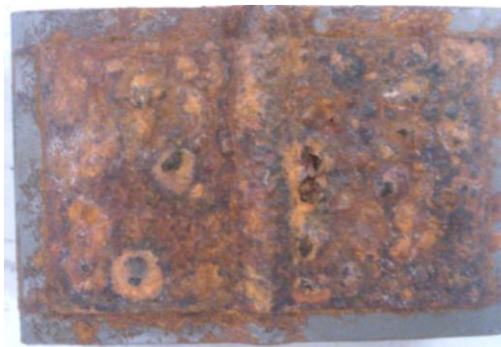
Εικόνα 5.36 β): Διαβρωμένη επιφάνεια δοκιμίου IA5* (interval) μετά την έξοδό του από τον θάλαμο αλατονέφωσης
