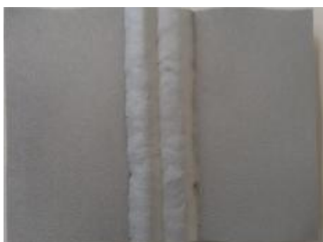
Εικόνα 5.45 α): Επιφάνεια του δοκιμίου IIB2 έπειτα από την αμμοβολή, και πριν την εισαγωγή του στο θάλαμο αλατονέφωσης
