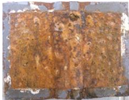
Εικόνα 5.46 β): Διαβρωμένη επιφάνεια δοκιμίου IIB3 μετά την έξοδό του από τον θάλαμο αλατονέφωσης
