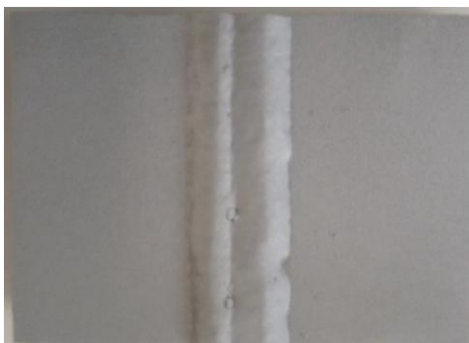
Εικόνα 5.51 α): Επιφάνεια του δοκιμίου IVB2* ( interval ) έπειτα από την αμμοβολή, και πριν την εισαγωγή του στο θάλαμο αλατονέφωσης
