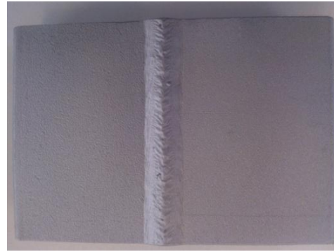
Εικόνα 4.13: Δοκίμιο Υβριδικής συγκόλλησης Laser- tandem τόξου AH36-S690 μετά την αμμοβολή
