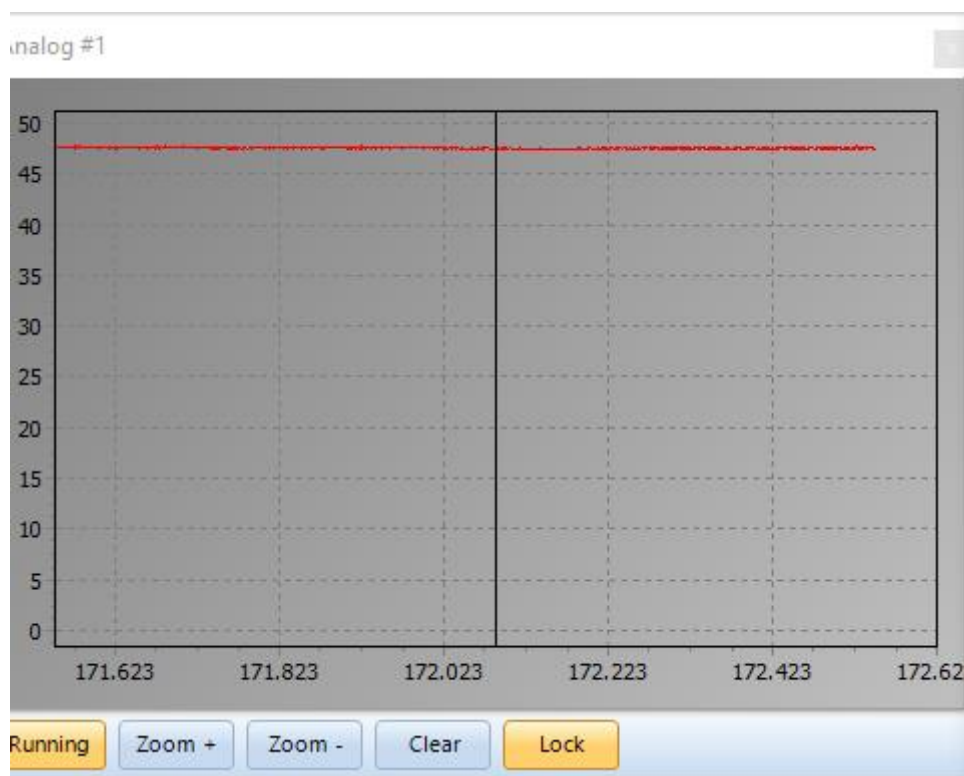
Σχήμα 42. Μέτρηση επιπέδου τάσης μπαταρίας κατά την ακινησία του ηλεκτρικού οχήματος.
