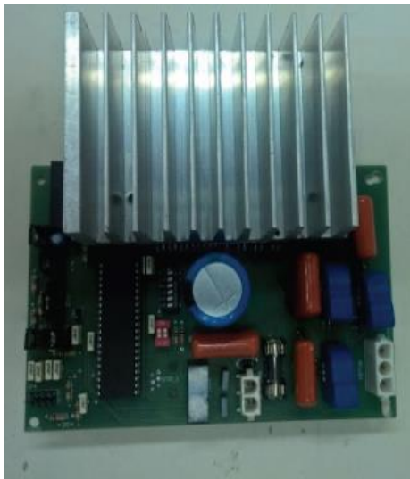
Σχήμα 5. Ο μετατροπέας ισχύος του «Πυρφόρου II». Κάτω από την ψήκτρα βρίσκεται το IRAM που περιέχει τα 6 διακοπτικά στοιχεία τύπου MOSFET.
