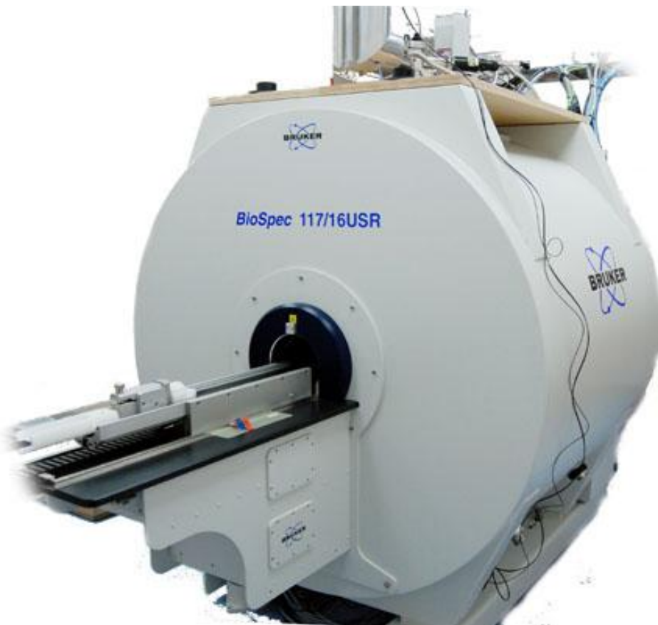
Εικόνα 2-25: Συσκευή φασματοσκοπίας που μπορεί να χρησιμοποιηθεί και ως σύστημα μίκρο-μαγνητικής τομογραφίας.
