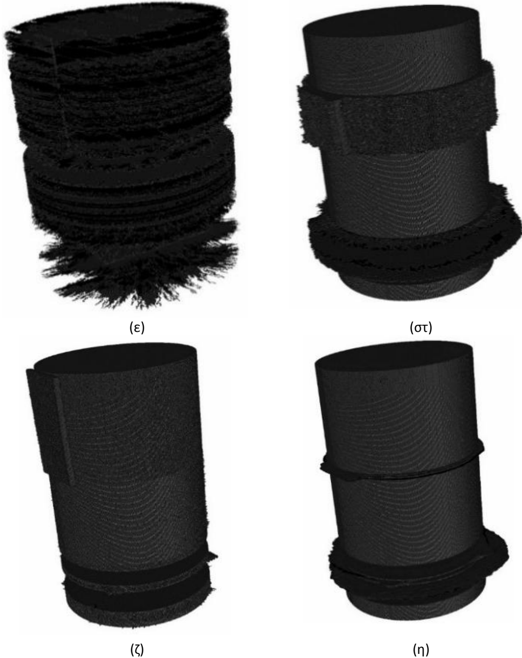
Εικόνα 3-11. Τρισδιάστατες ανακατασκευές των αποτελεσμάτων κάθε αλγορίθμου στο μικρο-τομογραφικό Phantom. (α) Βελτιστοποιημένο Phantom, (β) IACS, (γ) Κατωφλίωση Otsu, (δ) Προσαρμοστική Κατωφλίωση, (ε) Ανάπτυξη Περιοχών, (στ) Chan-Vese ΕΠ, (ζ) Geodesic ΕΠ and (η) ALR-CV ΕΠ.
