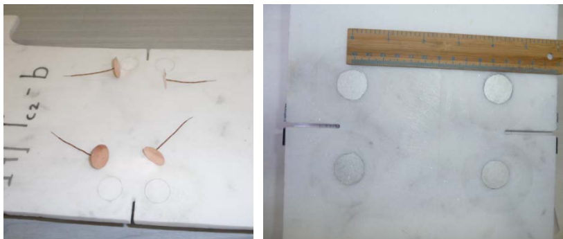
Εικόνα 6.11 Θέσεις ηλεκτροδίων εκατέρωθεν των εγκοπών του δοκιμίου.
