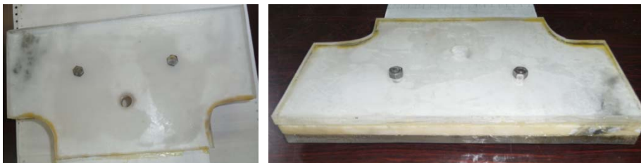
Εικόνα 6.2 Ενίσχυση άκρων δοκιμίου με plexiglass.
