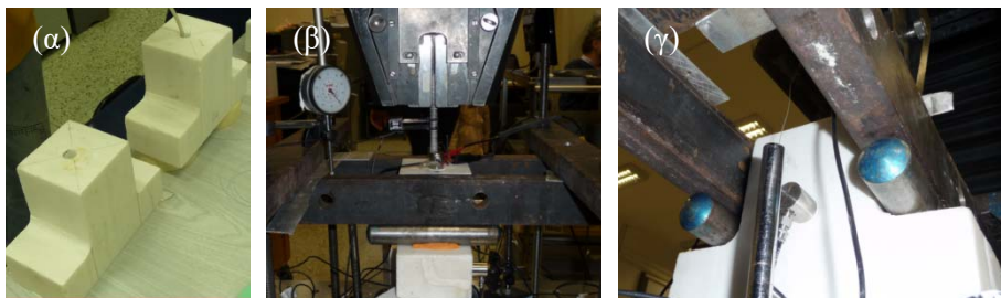
Εικόνα 9.11 (α) Δοκίμια μορφής ανεστραμμένου Ταυ, (β) πειραματική διάταξη δοκιμής εξόλκευσης.
