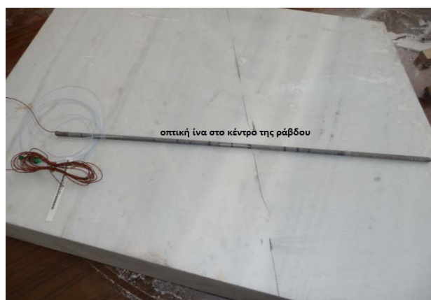
Εικόνα 10.8 Μετρητικά συστήματα πάνω στις ράβδους, εισαγωγή στο εσωτερικό του δοκιμίου.
