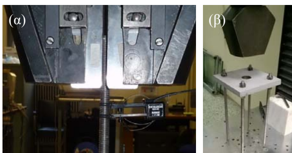
Εικόνα 9.18 (α)Αρπάγη- επιμηκνσιόμετρο, (β)μεταλλική πλάκα συγκράτησης δοκιμίου στηριζόμενη σε 4 περιμετρικές μεταλλικές ράβδους.
