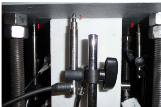
Εικόνα 9.24 Θέσεις μηχανοσυστοιχιών τύπου LVDT επί της μεταλλικής πλάκας συγκράτησης.
