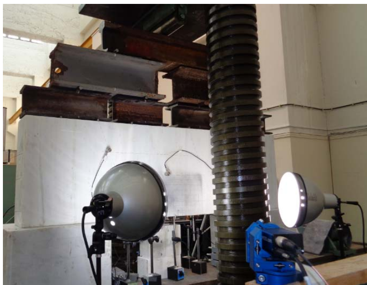
Εικόνα 10.15 Παρακολούθηση δοκιμίου με την τεχνική ψηφιακής εικόνας (DIC).
