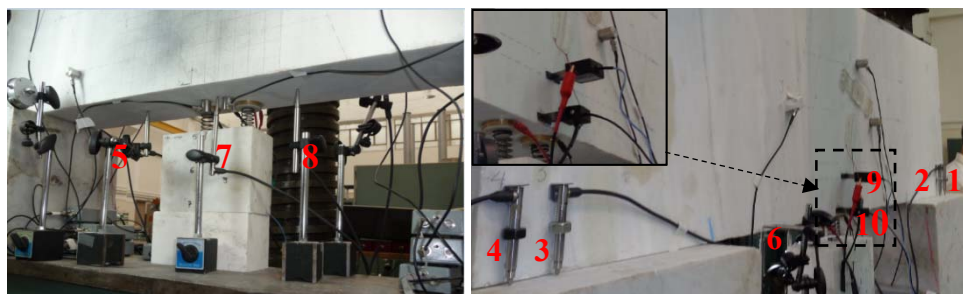
Εικόνα 10.12 Θέσεις μηκνσιόμετρων τύπου LVDT & clip gauges.
