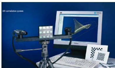
Εικόνα 6.5 Σύστημα τεχνικής συσχέτισης ψηφιακής εικόνας DIC (127).
