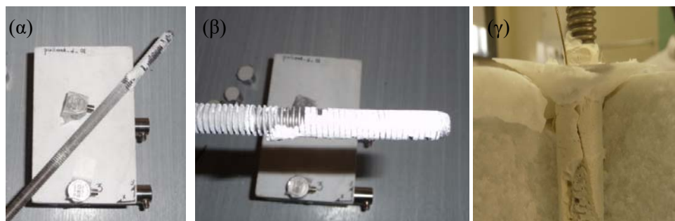
Εικόνα 9.42 (α), (β) Δοκίμιο μετά το πέρας του πειράματος, (γ) χαρακτηριστικός κώνος δοκιμής εξόλκευσης.
