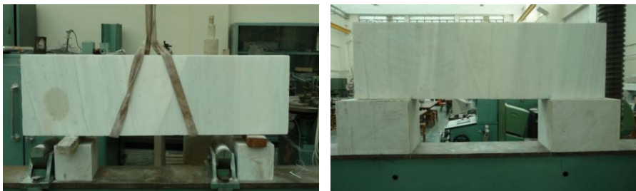
Εικόνα 10.10 Τοποθέτηση επιστυλίου στην θέση της δοκιμής.
