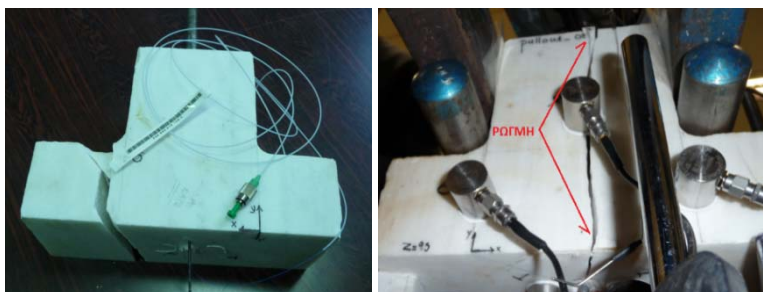
Εικόνα 9.12 Αστοχίες δοκιμίων μορφής ανεστραμμένου ταυ.
