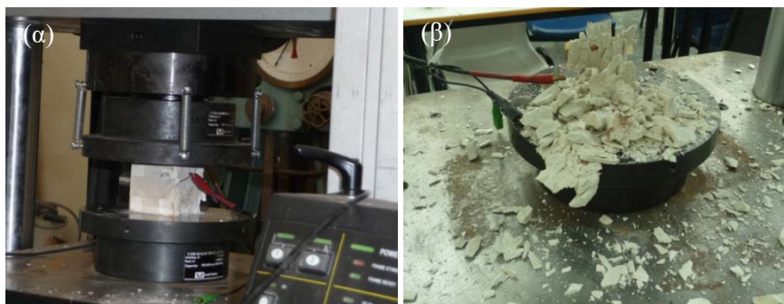
Εικόνα 3.7 (α) Δοκίμιο θλίψης τσιμεντοκονίας πριν και (β) μετά τη δοκιμή.
