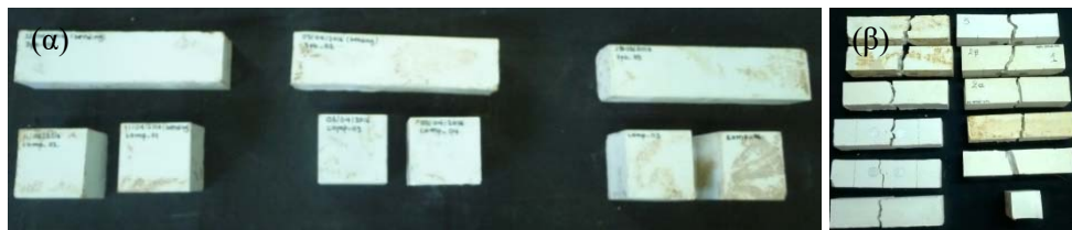
Εικόνα 3.6 (α) Δοκίμια κάμψης 3 σημείων και μονοαξονικής θλίψης από πάστα λευκού τσιμέντου, (β) δοκίμια κάμψης 3 σημείων από τσιμεντοκονία μετά τις δοκιμές.
