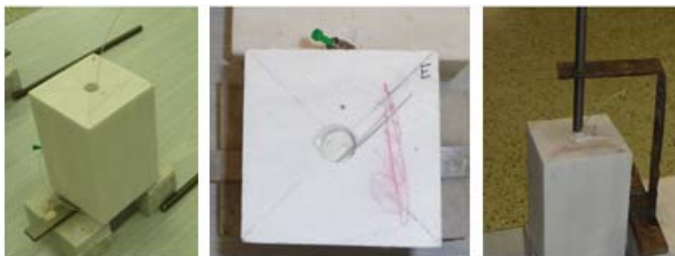
Εικόνα 9.14 Στάδια παρασκευής δοκιμίων εξόλκευσης.
