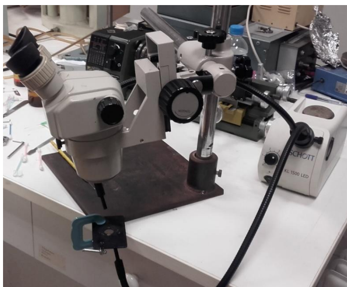
Εικόνα 6.4. Οπτικό μικροσκόπιο διάταξης με συσκευή παραγωγής φωτός με οπτικές ίνες.
