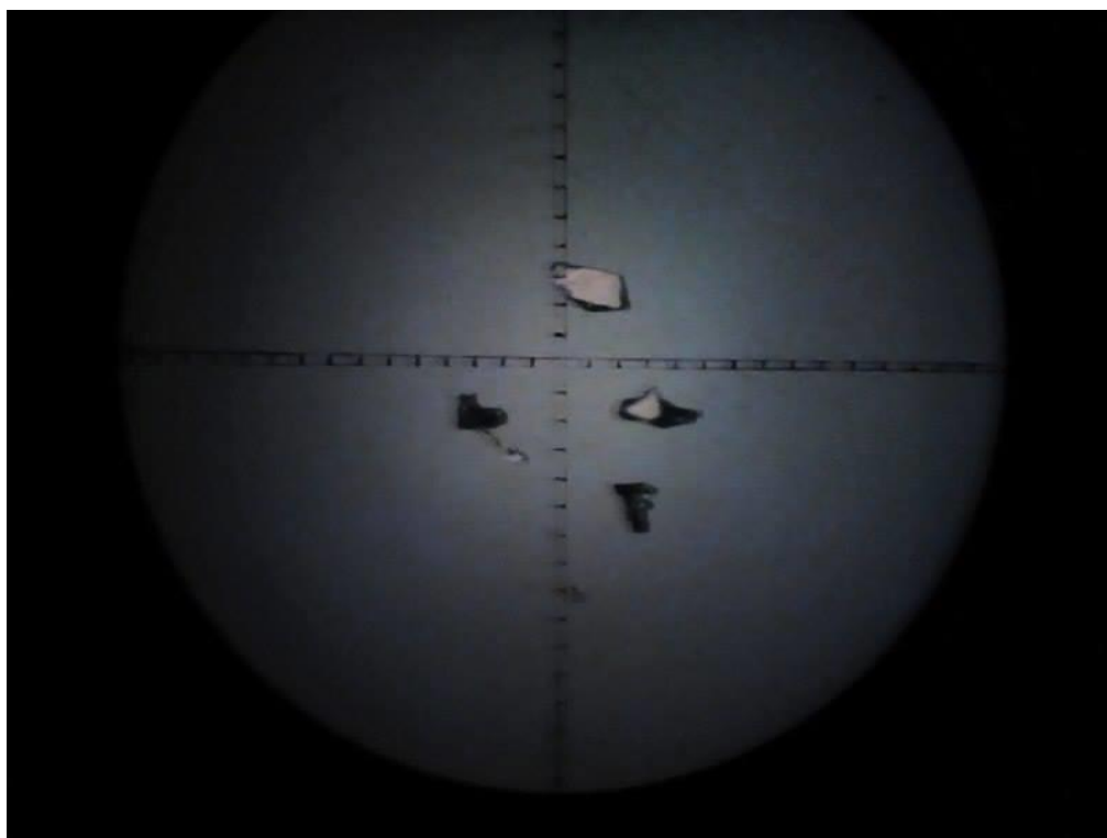
Εικόνα 6.3.. Θραύσματα του υπεραγωγού \text{SmFe}_{0.91}\text{Co}_{0.09}\text{AsO} στο ηλεκτρονικό μικροσκόπιο με φακό x40 LD.
