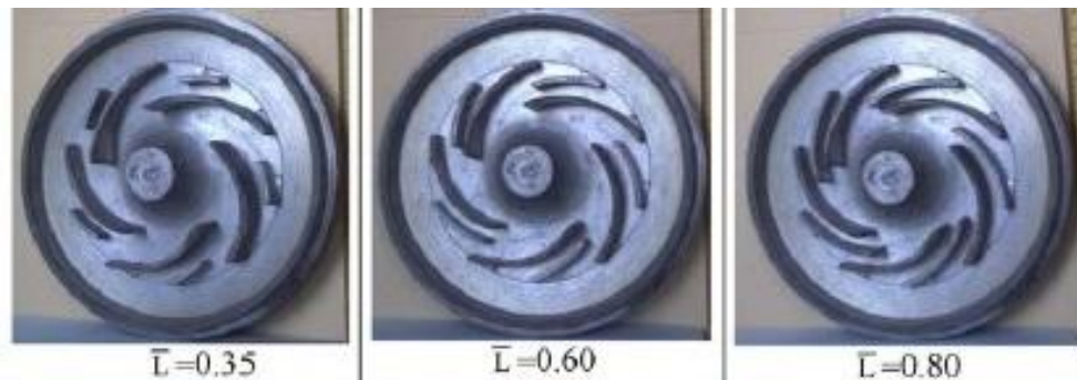
Σχήμα 1.10 Πτερωτές με διαφορετικά σχετικά μήκη παρεμβαλλόμενων διαχωριστικών πτερυγίων (splitter blades) [21].
