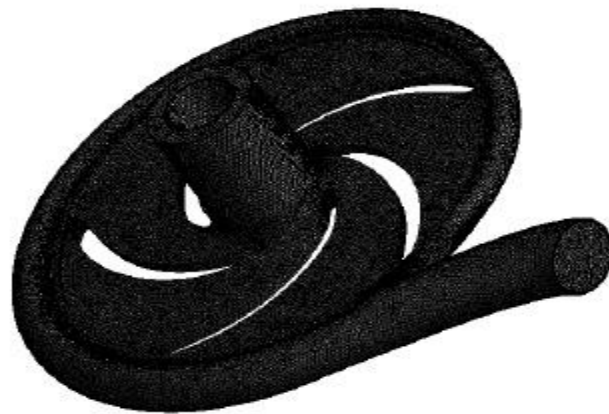
Σχήμα 2.37 Αριθμητικό πλέγμα του τριδιάστατου υπολογιστικού μοντέλου της αντλίας [25].
