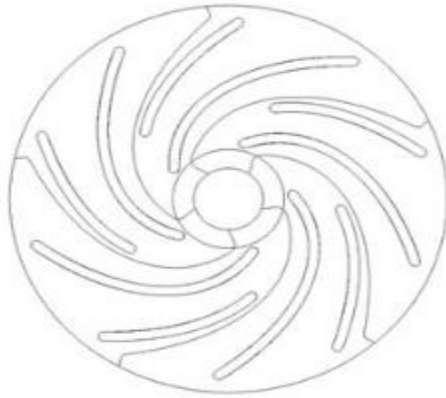
Σχήμα 2.29 Ακτινική περωτή φυγοκεντρικής αντλίας με διαχωριστικά περυσία.
