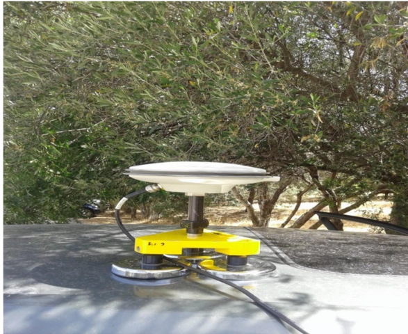
Εικόνα 5: Κινητός δέκτης GNSS στην οροφή του οχήματος.
