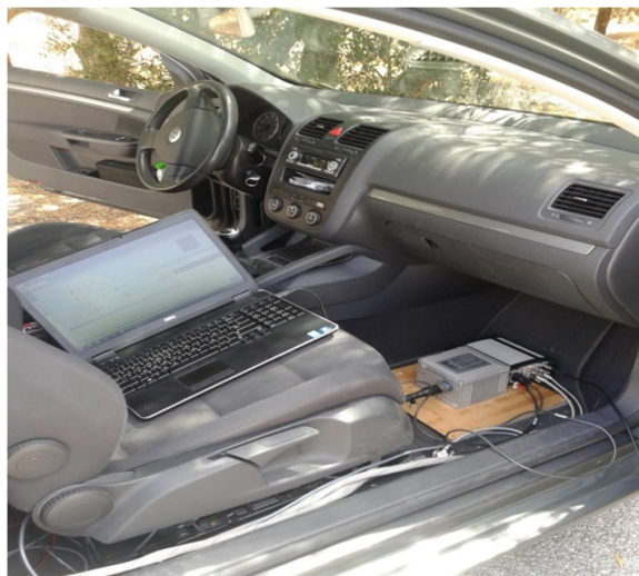
Εικόνα 6: Σύνδεση του δέκτη GNSS με το αδρανειακό σύστημα (iMAR) και το λογισμικό NOVATEL CONNECT σε φορητό υπολογιστή.
