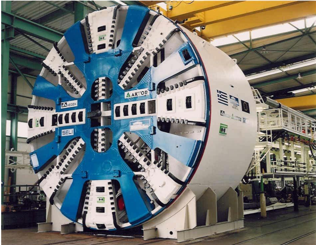
Εικόνα 3.13: Μηχάνημα ολομέτωπης κοπής χωρίς ασπίδα ( www.ametro.gr )
