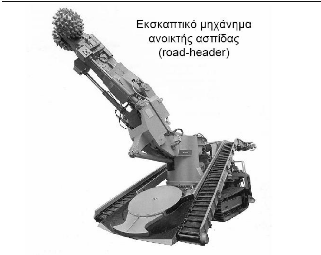
Εικόνα 3.5: Εκσκαπτικό μηχάνημα ανοικτής ασπίδας Roadheader (Εξαδάκτυλος, 2006)
