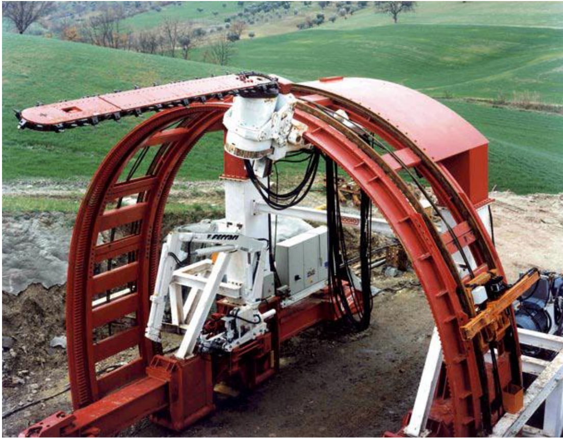
Εικόνα 5.7 Μηχανή πρότμησης που χρησιμοποιήθηκε για την εκσκαφή σηράγγων της σιδηροδρομικής γραμμής στο Sibari-Cosenza(1985) (Pietro Lunardi, 2008)
