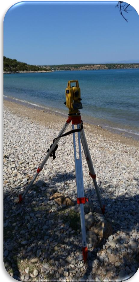
Εικόνα 5.9: Ολοκληρωμένος Γεωδαιτικός Σταθμός Topcon GTS-235N, στη κορυφή T1, κατά τη διάρκεια της ταχυμετρίας. Πηγή: Ίδια διπλωματική εργασία, 2015
