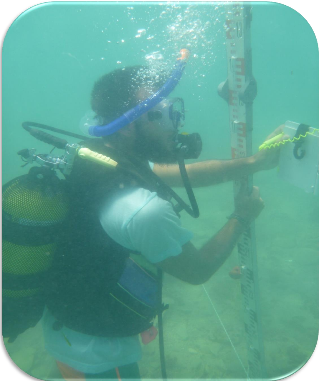
Εικόνα 5.16: Δύτης επί το έργο, Υδραυλική Χωροστάθμιση Πηγή: Ιδία διπλωματική εργασία, 2015
