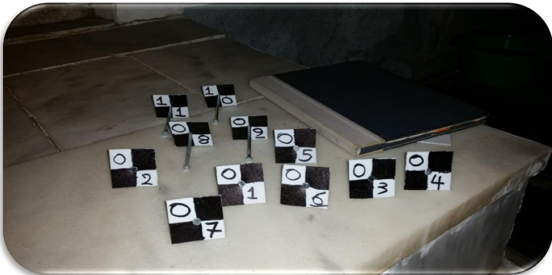
Εικόνα 5.13: Ήλοι από ατσάλι τοποθετημένοι στο κέντρο τετραγώνων από πλαστικό για τη σήμανση των υποθαλάσσιων σημείων λεπτομέρειας Πηγή: Ιδία διπλωματική εργασία, 2015
