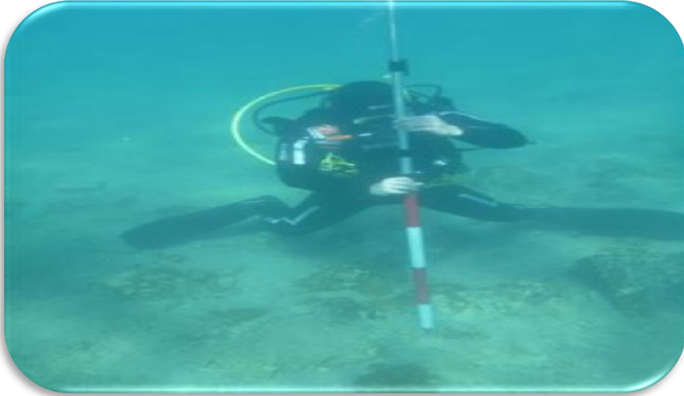
Εικόνα 5.11: Δύτης επί το έργο, αποτύπωση ταχυμετρικών σημείων στο βυθό με κατάφωτο Πηγή: http://www.patrisnews.com/ , 2016
