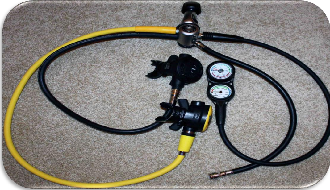
Εικόνα 2.7: Ρυθμιστής αναπνοής, πρώτο και δεύτερο στάδιο Πηγή: http://www.ukdiving.co.uk/ , 2016
