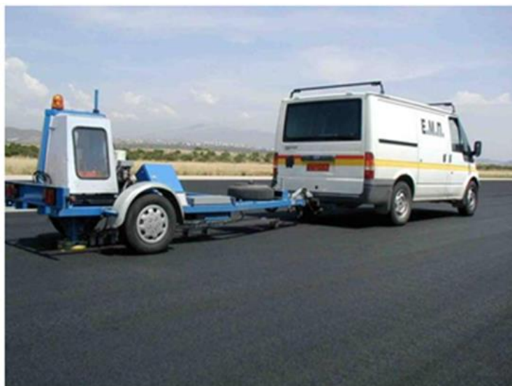
Εικόνα 5.5 Παραμορφωσίμετρο πίπτοντος βάρους προσαρμοσμένο σε συσκευή ρυμούλκησης για ταχεία μέτρηση
