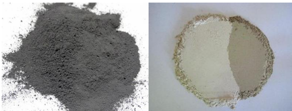
Εικόνα 2.15 Πυριτική παιπάλη αριστερά και φυσική ποζολάνη δεξιά
