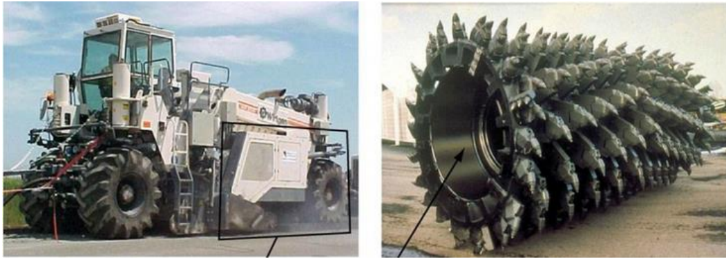
Εικόνα 4.14 Μηχάνημα πλήρους βάθους ανάκτησης οδοστρώματος αριστερά & αντίστοιχη κεφαλή δεξιά
