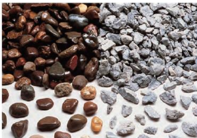
Εικόνα 2.2 Φυσικά αδρανή αριστερά και τεχνητά θρυμματισμένα δεξιά
