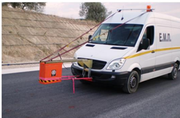
Εικόνα 5.6 Συσκευή συστήματος γεωραντάρ (GPR) προσαρμοσμένη σε ειδικό όχημα για ταχεία μέτρηση
