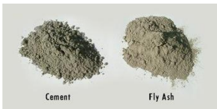
Εικόνα 2.13 Ιπτάμενη τέφρα δεξιά σε σύγκριση με συμβατικό τσιμέντο
