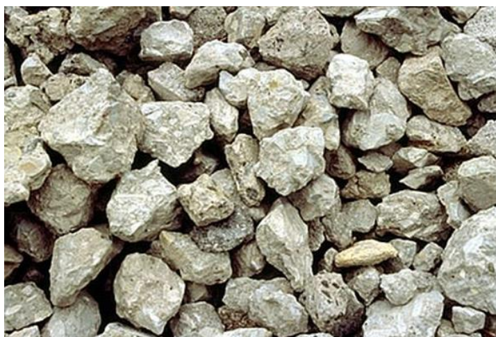
Εικόνα 2.5 Ανακυκλωμένα αδρανή σκυροδέματος, RCA
