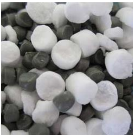
Εικόνα 2.12 Ασφαλτος τροποποιημένη με πολυμερή, PMA
