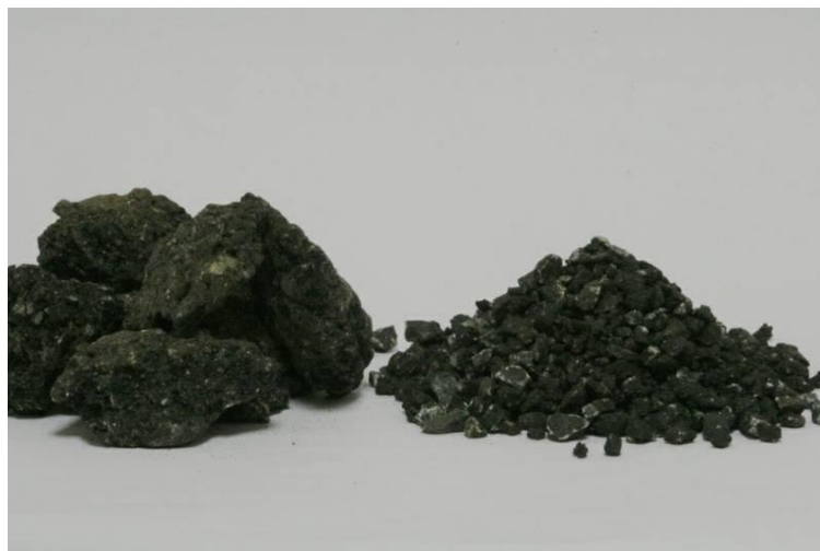
Εικόνα 2.4 Ανακτημένο ασφαλτικό υλικό οδοστρώματος, RAP
