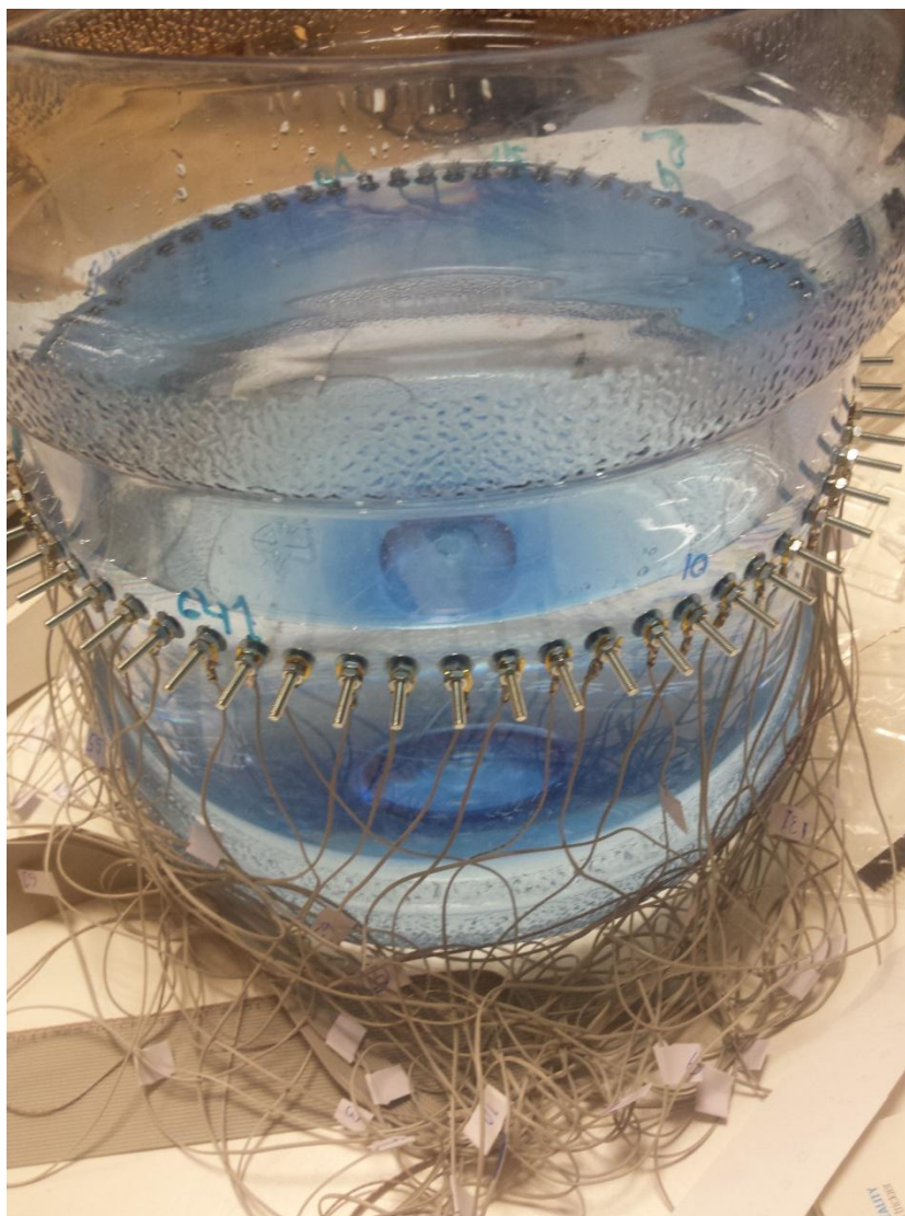
Εικόνα 9: Το πλαστικό δοχείο της πειραματικής διάταξης με τα προσαρτημένα ηλεκτρόδια (phantom 2D model)
