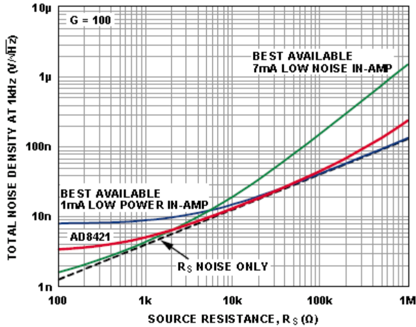
Διάγραμμα 8: Πυκνότητα θορύβου VS αντίσταση πηγής
