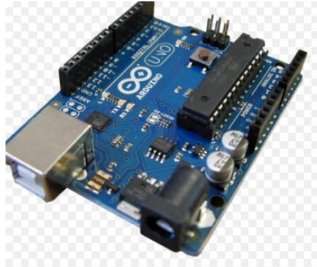
Εικόνα 15: Αναπτυξιακή πλακέτα arduino Uno (ενσωματώνει το μικροελεγκτή Atmel Atmega328P).
