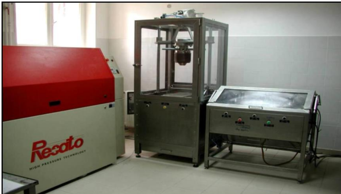
Εικόνα 5.1: Το σύστημα Υπερυψηλής Πίεσης που χρησιμοποιήθηκε για τα πειράματα. Αριστερά βρίσκεται η μονάδα ΥΠ, στο κέντρο ο θάλαμος όγκου 1.5L και δεξιά η συστοιχία των 6 μικρότερων θαλάμων όγκου 42ml
