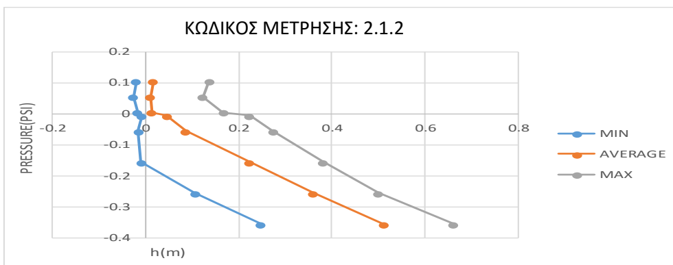
Σχήμα4.4.38- Κατανομή πιέσεων (υδροδυναμικές + υδροστατικές)(Κ1.Β/d2)
