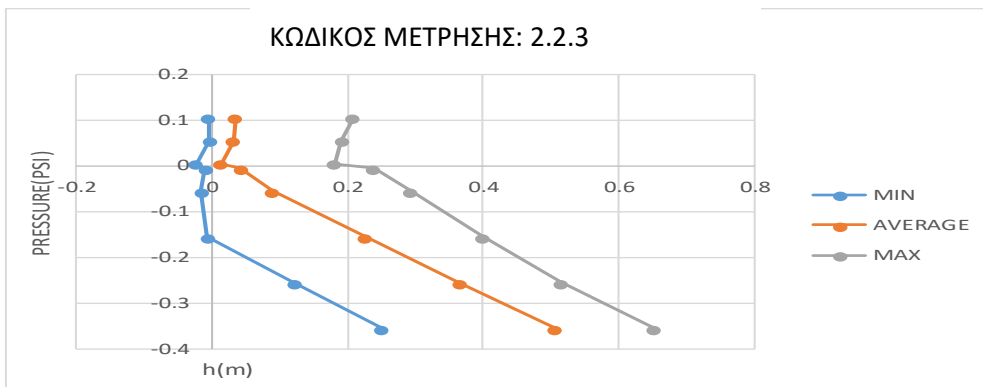
Σχήμα4.4.43- Κατανομή πιέσεων (υδροδυναμικές + υδροστατικές)(Κ2.Γ/d2)
