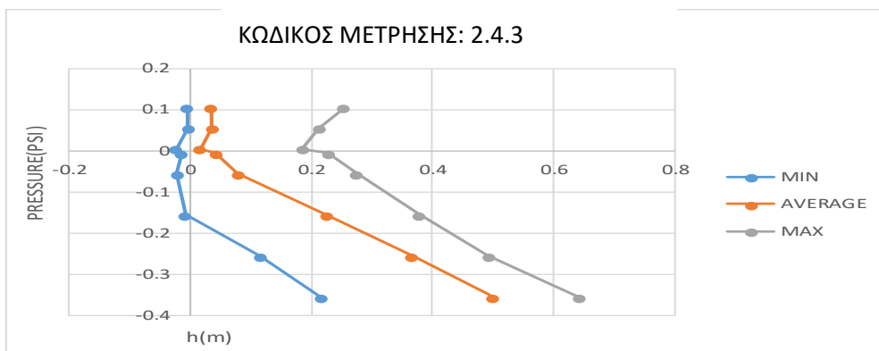
Σχήμα4.4.51- Κατανομή πιέσεων (υδροδυναμικές + υδροστατικές)(Κ4.Γ/d2)
