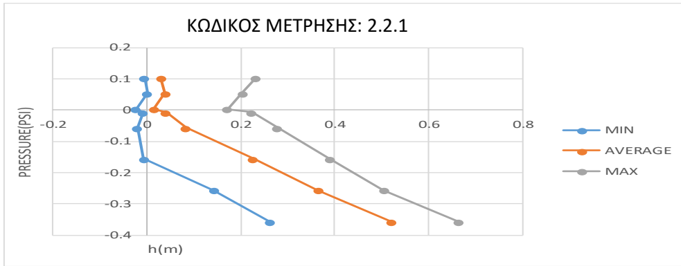
Σχήμα4.4.41- Κατανομή πιέσεων (υδροδυναμικές + υδροστατικές)(Κ2.Α/d2)
