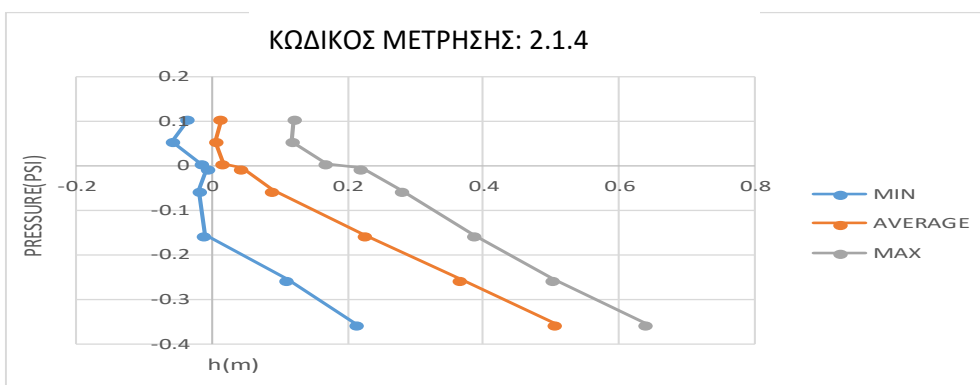
Σχήμα4.4.40- Κατανομή πιέσεων (υδροδυναμικές + υδροστατικές)(Κ1.Δ/d2)
