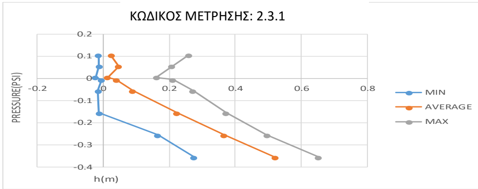
Σχήμα4.4.45- Κατανομή πιέσεων (υδροδυναμικές + υδροστατικές)(Κ3.Α/d2)
