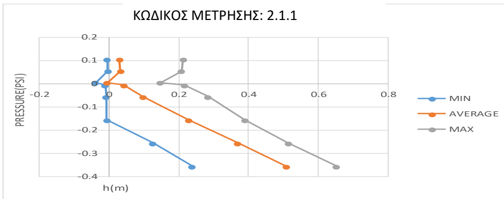
Σχήμα4.4.37- Κατανομή πιέσεων (υδροδυναμικές + υδροστατικές)(Κ1.Α/d2)
