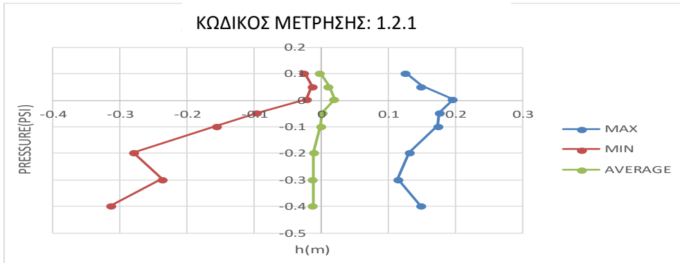
Σχήμα 4.3.5-Κατανομή πιέσεων (υδροδυναμικές μόνο) (Κ2.Α/d1)
