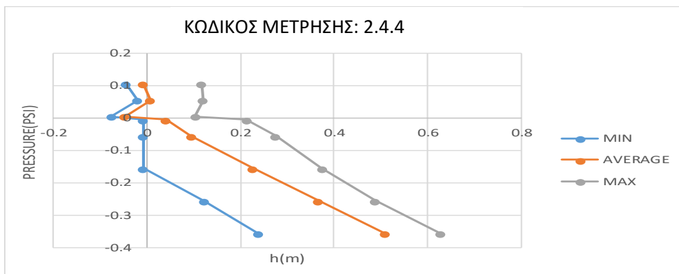
Σχήμα4.4.52- Κατανομή πιέσεων (υδροδυναμικές + υδροστατικές)(Κ4.Δ/d2)
