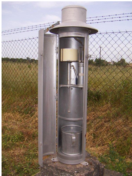
Σχήμα 3.10. Τυπικός βροχογράφος [Πηγή: www.northmeteo.gr ]
