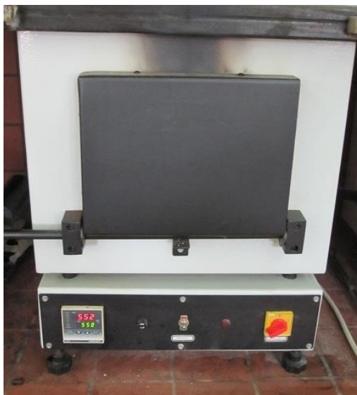
Εικόνα 5.4 Εργαστηριακός ηλεκτρικός κλίβανος για θερμική κατεργασία πλακετών
