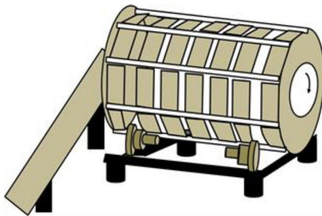
Εικόνα 3.3 Βιομηχανικής κλίμακας θραυστήρας που χρησιμοποιείται για τη διαδικασία ανακύκλωσης ΑΗΗΕ
