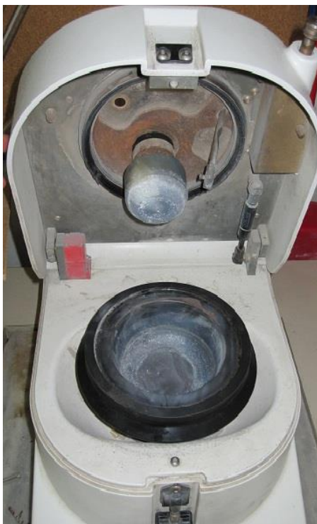
Εικόνα 5.5 Εργαστηριακός τριβέας για τη λειοτρίβηση προϊόντων θερμικής κατεργασίας πλακετών
