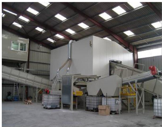
Εικόνα 3.3 Βιομηχανικής κλίμακας θραυστήρας που χρησιμοποιείται για τη διαδικασία ανακύκλωσης ΑΗΗΕ
