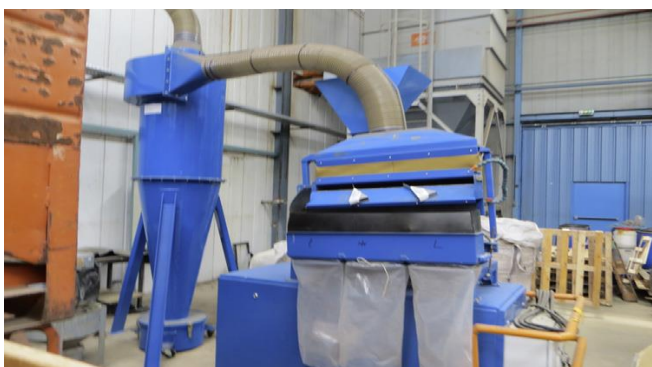
Εικόνα 3.8 Κλίνη αέρα για διαχωρισμό πυκνότητας
