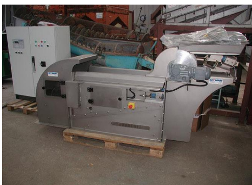
Εικόνα 3.7 Επαγωγικός διαχωριστής, συνδυασμένος με χαμηλής έντασης μαγνητικό διαχωριστή
