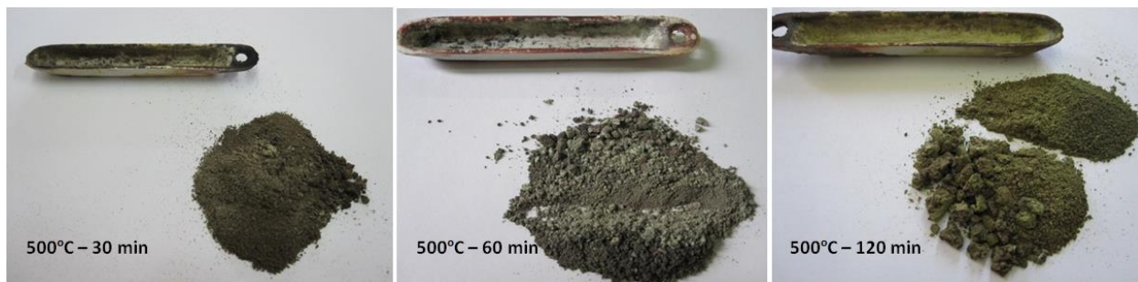
Εικόνα 8.4 Στερεά προϊόντα χλωρίωσης σε θερμοκρασία 500°C για χρόνους κατεργασίας 30, 60 και 120 min
