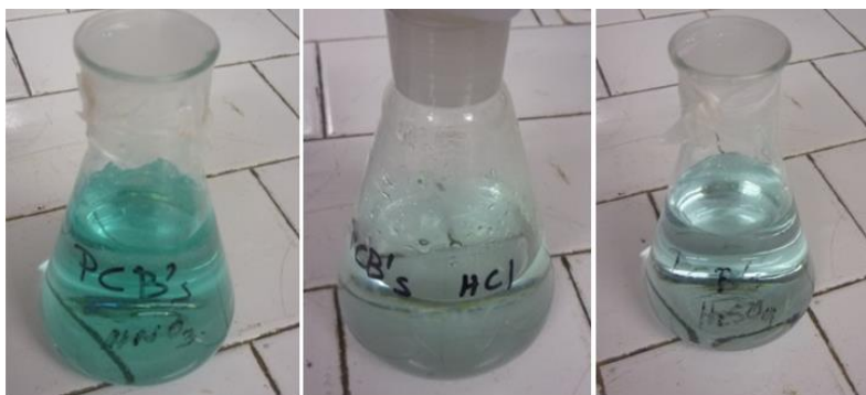
Εικόνα 7.12 Διαλύματα οξέων από τη διαλυτοποίηση σκόνης πλακετών για ανάκτηση χαλκού
