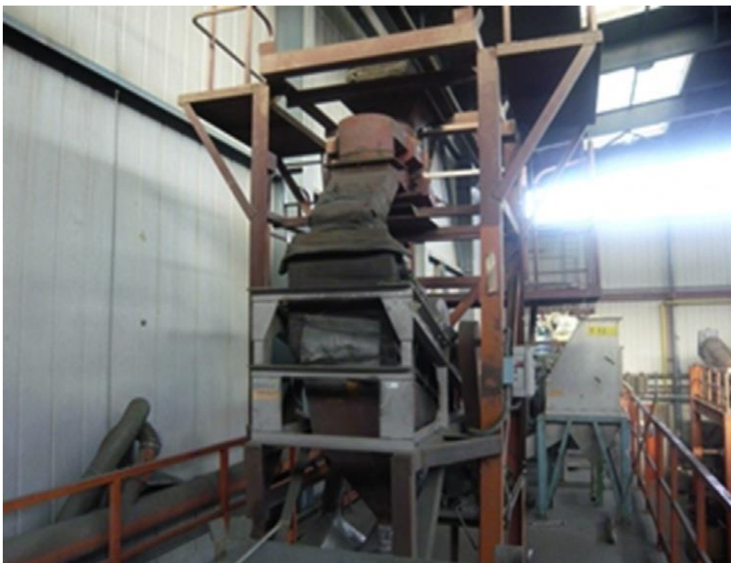
Εικόνα 3.4 Δονούμενα κόσκινα βιομηχανικής κλίμακας
