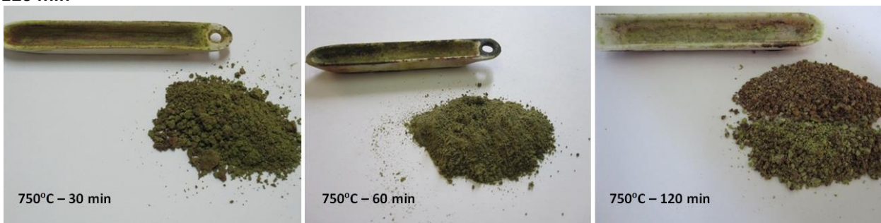
Εικόνα 8.5 Στερεά προϊόντα χλωρίωσης σε θερμοκρασία 750°C για χρόνους κατεργασίας 30, 60 και 120 min
