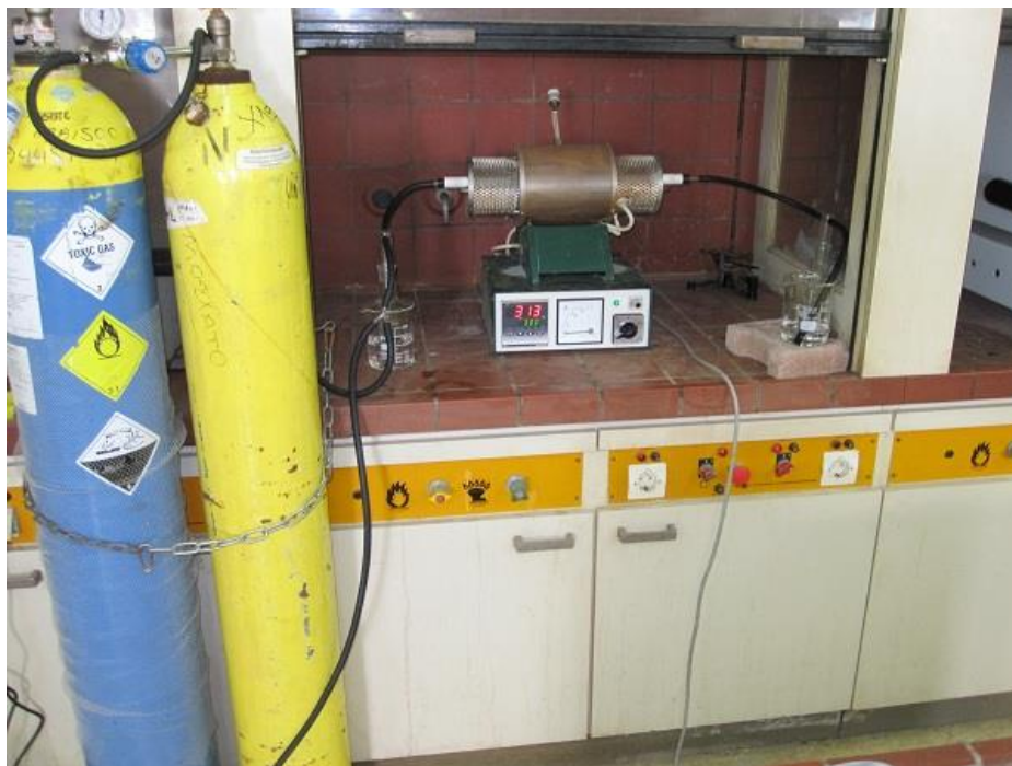
Εικόνα 8.2 Πειραματική διάταξη χλωρίωσης σκόνης πλακετών
