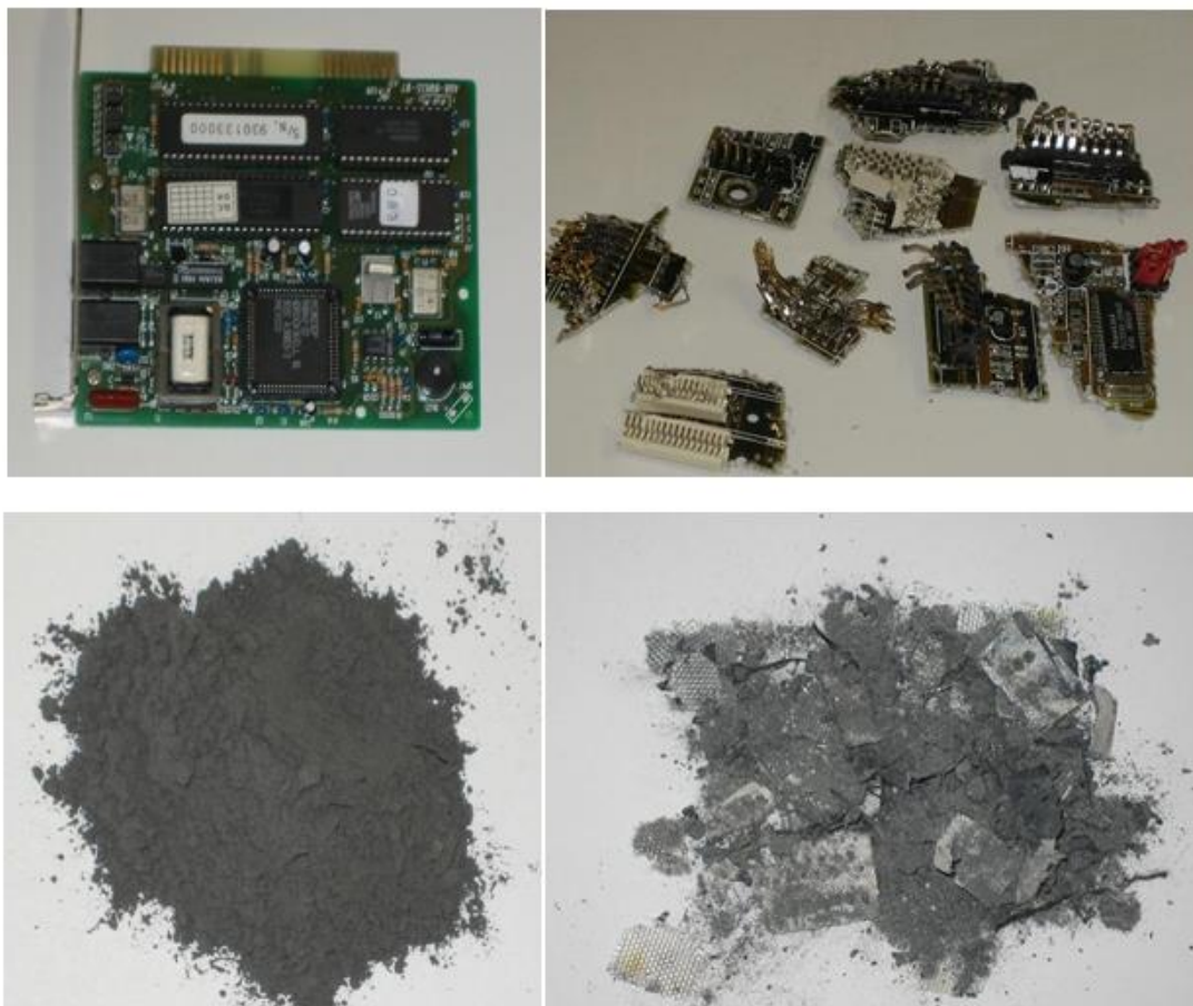
Εικόνα 5.6 Στάδια προκατεργασίας πλακετών για παραγωγή σκόνης
