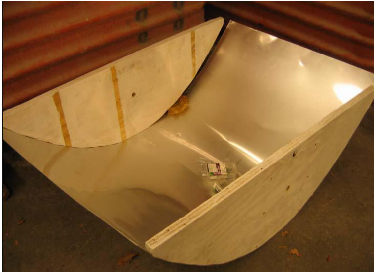
Εικόνα 2.14 – Μερικώς ολοκληρωμένος φούρνος παραβολικού κοίλου.
