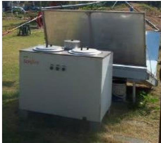
Εικόνα 2.10 – Φούρνος συλλέκτη. Προστίθενται κάτοπτρα για να αυξήσουν την ποσότητα του ηλιακού φωτός που πέφτει στον συλλέκτη.
