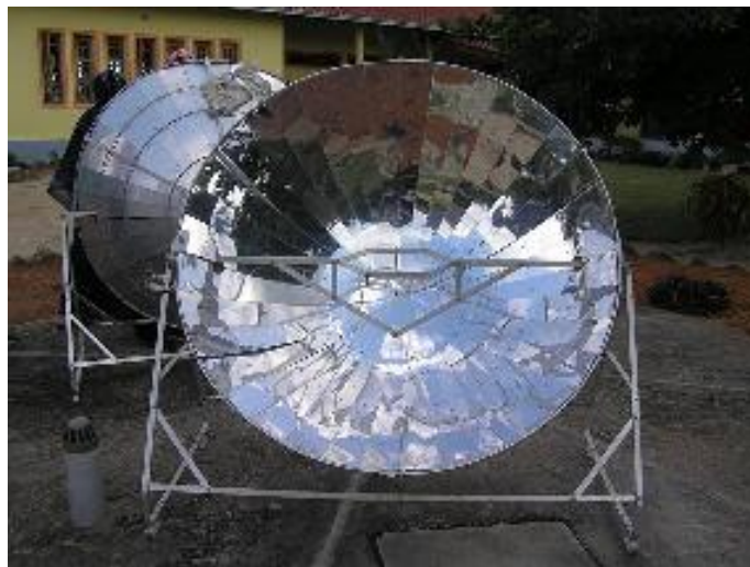
Εικόνα 2.8 – Ηλιακός φούρνος παραβολικής συγκέντρωσης SK14.
