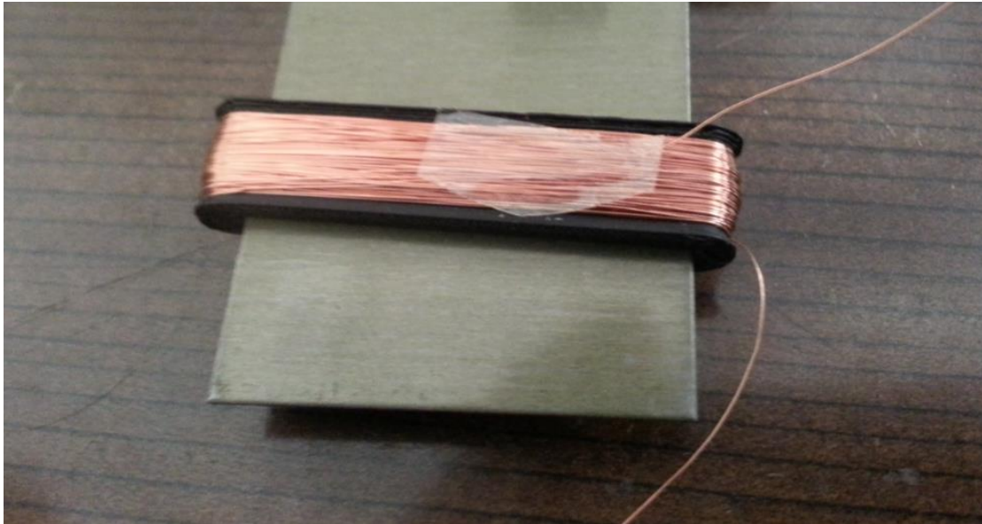
Σχήμα 14: Πηνίο 300 σπειρών τυλιγμένο στο μαύρου χρώματος εξάρτημα που απεικονίζεται στο προηγούμενο σχήμα.
