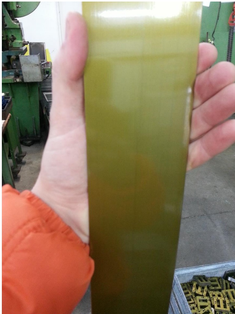
Σχήμα 10: Ο ηλεκτρικός χάλυβας από τον οποίο παράγονται οι πυρήνες, το μπρούντζινο χρώμα οφείλεται στο μονωτικό στρώμα
