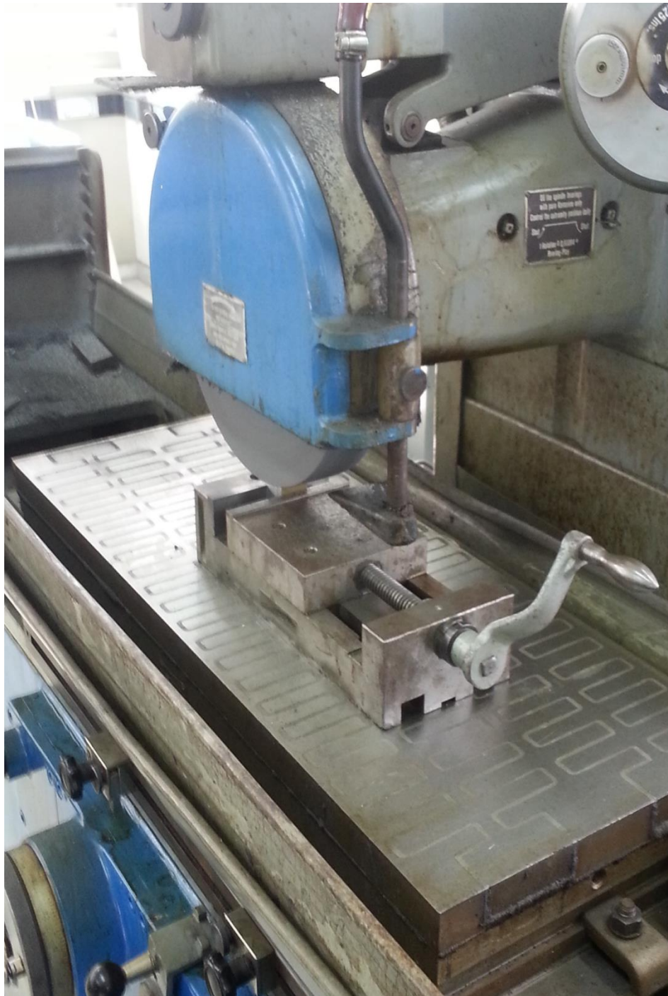
Σχήμα 11: Λείανση των εδρών του πυρήνα στο ρεκτιφιέ. Η μέγγενη συγκρατείται με μαγνητικό τρόπο πάνω στο τραπέζι. Διακρίνονται ο λειαντικός τροχός και τα τεμάχια, ακριβώς από κάτω του.
