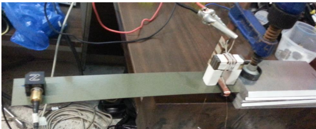
Σχήμα 37: Διάταξη με τα πηνία και τον αισθητήρα επιτάχυνσης στις άκρες της λάμας πακτωμένης λάμας
