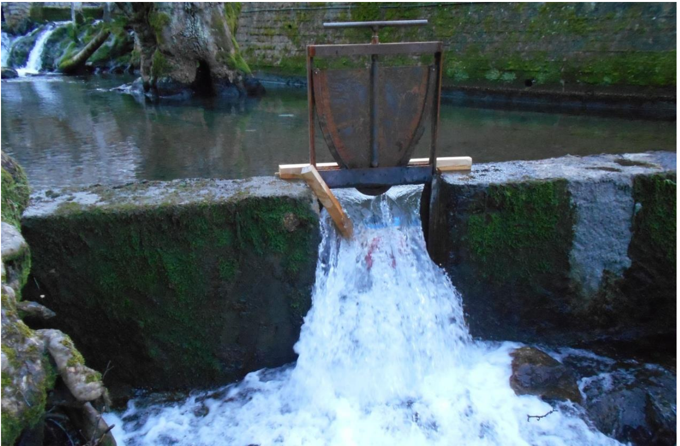
Σχήμα 5.2 Υπερχειλιστής όπου μετρήθηκε η παροχή του νερού
