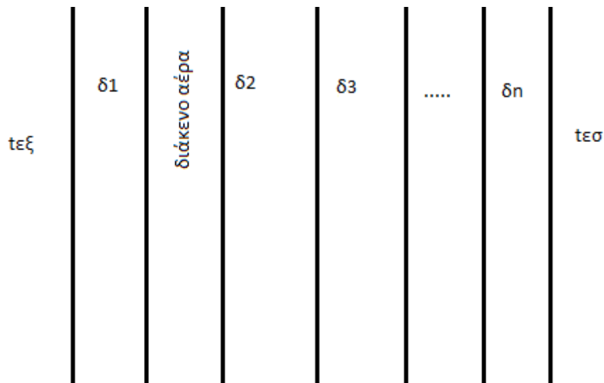
Σχήμα 4.7 Παράδειγμα υπολογισμού θερμοπερατότητας σύνθετων τοιχωμάτων με διάκενο αέρα
