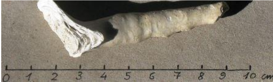
Εικ.22: Σταλακτίτης (με αποθραυσμένο άκρο) αποσπασμένος από το εσωρράχιο του ανατολικού τόξου.
