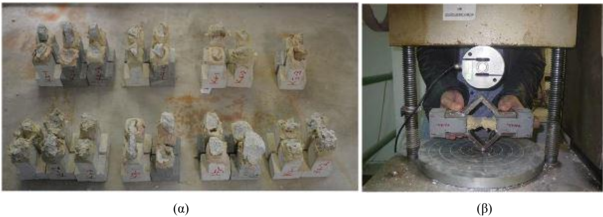
Εικ.47: (α) Δοκίμια για έλεγχο της εφελκυστικής αντοχής και (β) Πειραματική διάταξη για τον έλεγχο της εφελκυστικής αντοχής. (Φωτογραφικό Αρχείο ΕΜΠ)
