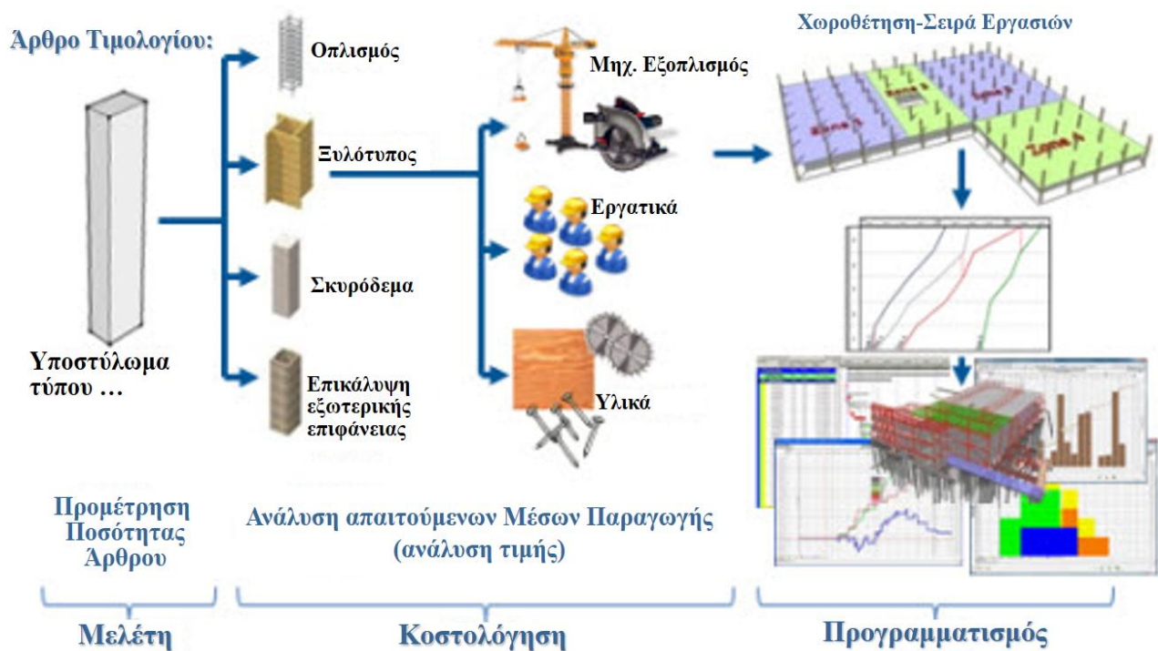
Εικ. 4.10: Ανάλυση τιμής άρθρου τιμολογίου και σύνδεση με τη μελέτη και το χρονοδιάγραμμα του έργου (Τουλιάτος και ACE Hellas, 2012) [43]
