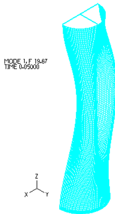
Σχήμα 3-11: 1 η ιδιομορφή του αριθμητικού προσομοιώματος της σύνδεσης
