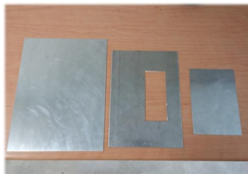
Εικόνα 5.2: Φύλλα αλουμινίου που συντελούν το καλούπι για την παρασκευή επίπεδων πλακών διαστάσεων 150x60x1 mm.
