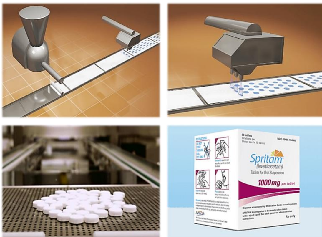
Εικόνα 1.5: Τριδιάστατη εκτύπωση φαρμακευτικών δισκίων ταχείας αποσάθρωσης με τη μέθοδο Binder Jetting. Δραστικές ουσίες και αδρανή έκδοχα βρίσκονται με τη μορφή σκόνης, στην οποία ψεκάζονται υδατοδιαλυτά συνδεδετικά μέσα, βελτιωτικά γεύσης κ.ά. Με τον τρόπο αυτό είναι δυνατή η παρασκευή εξατομικευμένων φαρμάκων πολλών δραστικών ουσιών, ακριβής δοσολογίας και αυξημένης βιοδιαθεσιμότητας. Ήδη, η αμερικανική Υπηρεσία Τροφίμων και Φαρμάκων (FDA) έχει εγκρίνει την κυκλοφορία του πρώτου τριδιάστατα εκτυπωμένου δισκίου για τη θεραπεία της επιληψίας, με την εμπορική ονομασία SPRITAM (levetiracetam)[8].
