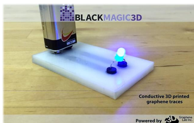
Εικόνα 3.1: Χρήση αγώγιμου νήματος PLA/γραφενίου για την ενσωμάτωση ηλεκτρονικών εφαρμογών χαμηλής τάσης στον κύριο όγκο του αντικειμένου.
