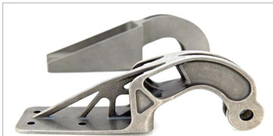
Εικόνα 1.3: Συνεργασία της ευρωπαϊκής βιομηχανίας κατασκευής αεροσκαφών με τη γερμανική εταιρία προσθετικής κατασκευής EOS, για την βελτιστοποίηση της τοπολογίας των μεντεσέδων στα ατρακτίδια του Airbus A320. Η μορφοποίηση μέσω χύτευσης χάλυβα αντικαταστάθηκε από την κατασκευή μέσω επιλεκτικής τήξης σκόνης κράματος τιτανίου (Ti6Al4V) με δέσμη laser, μειώνοντας το βάρος του αντικειμένου κατά 64%. Η εταιρία εκτιμά ότι η χρήση μεθόδων ΠΚ για την κατασκευή αεροσκαφών μπορεί να μειώσει μέχρι και 30% το βάρος τους.
