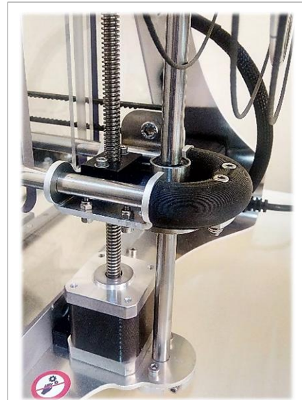
Εικόνα 2.3: Δεξιά πρισματική άρθρωση μεταξύ X και Z άξονα και σύστημα γραμμικής οδήγησης Z άξονα με κινούμενο κοχλία.
