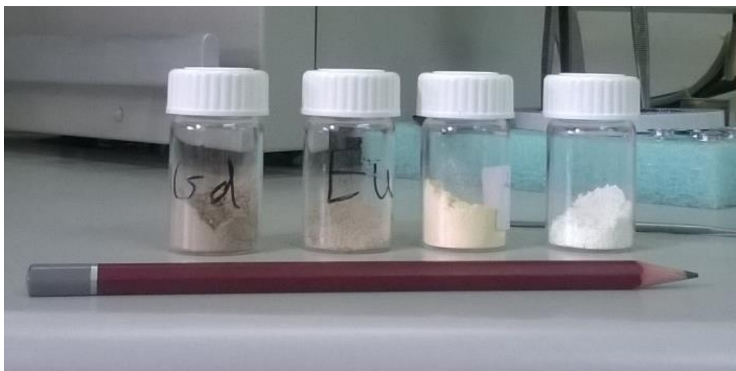
Εικόνα 138: Τελικό προϊόν των \text{La}_{1.7}\text{Eu}_{0.3}\text{Mo}_2\text{O}_9 , \text{La}_{1.7}\text{Gd}_{0.3}\text{Mo}_2\text{O}_9 , \text{La}_{1.5}\text{Pr}_{0.5}\text{Mo}_2\text{O}_9 και \text{La}_2\text{MoWO}_9 , μετά από έψηση.
