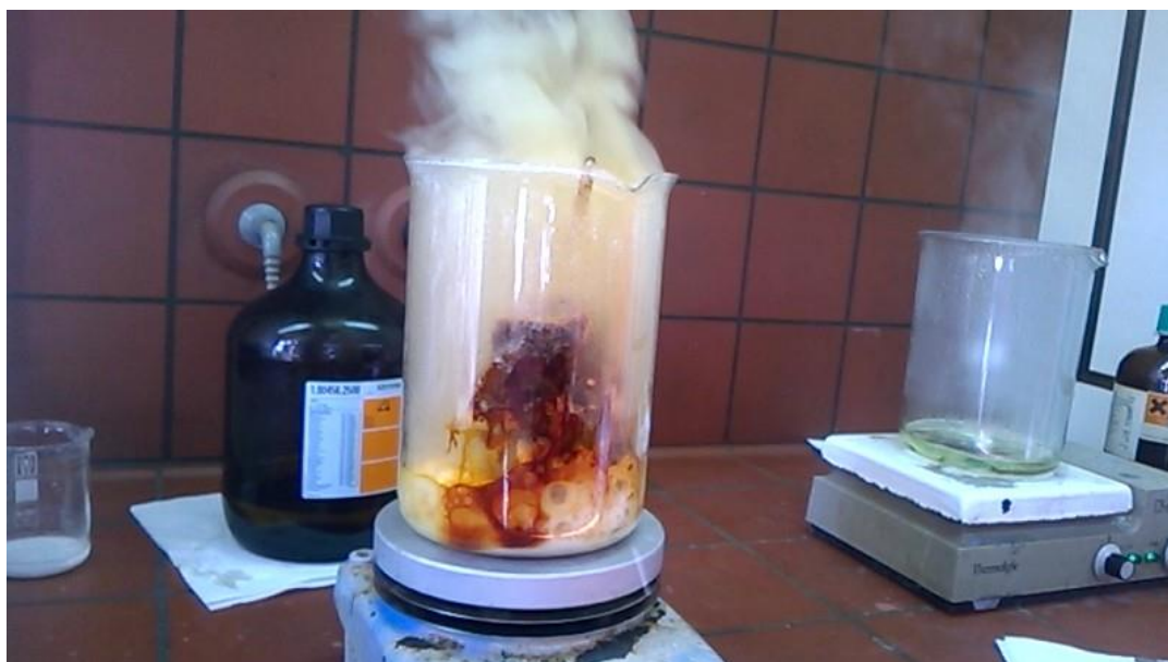
Εικόνα 149: Η αρχή της διόγκωσης στο παραχθέν \text{La}_{1.7}\text{Eu}_{0.3}\text{Mo}_2\text{O}_9 κατά την παραγωγή του (δεξιά), ομαλή διεξαγωγή παρασκευής \text{La}_{1.7}\text{Gd}_{0.3}\text{Mo}_2\text{O}_9 (αριστερά).
