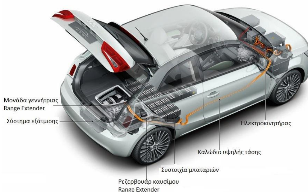
Εικόνα 2-8 Το Audi A1 e-tron, με κινητήρα Wankel ως Range Extender [42]
