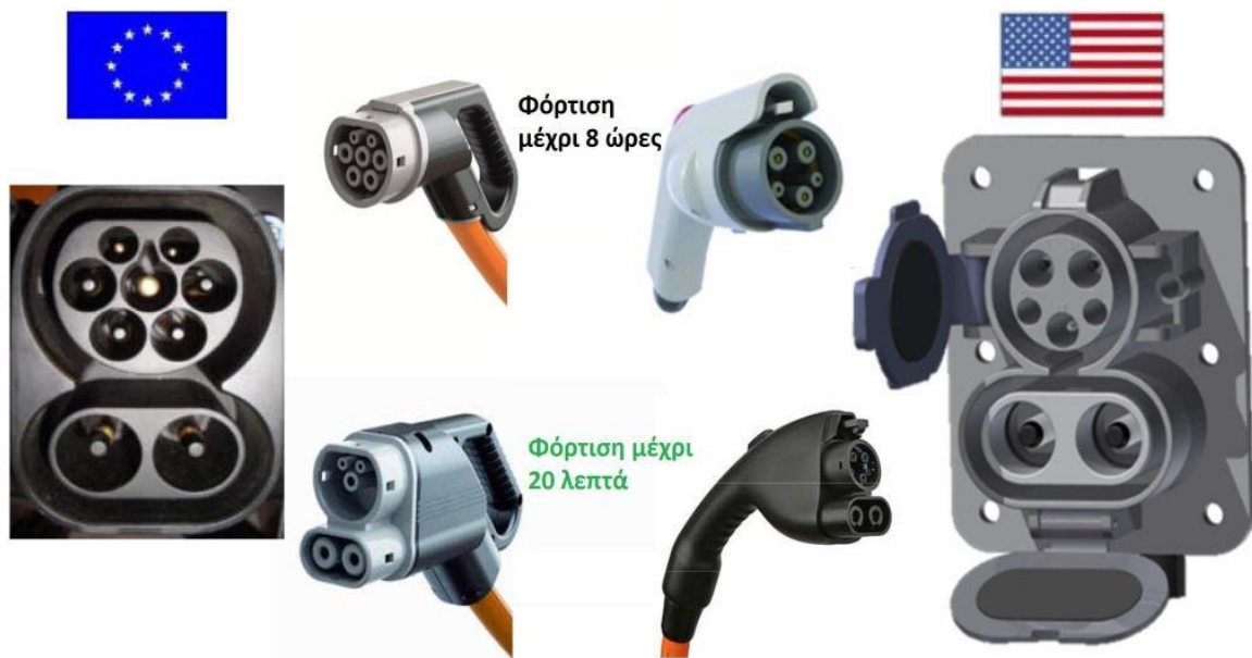
Εικόνα 4-14 Το Combo Charging System στην Ευρώπη και στις Η.Π.Α. [98]
