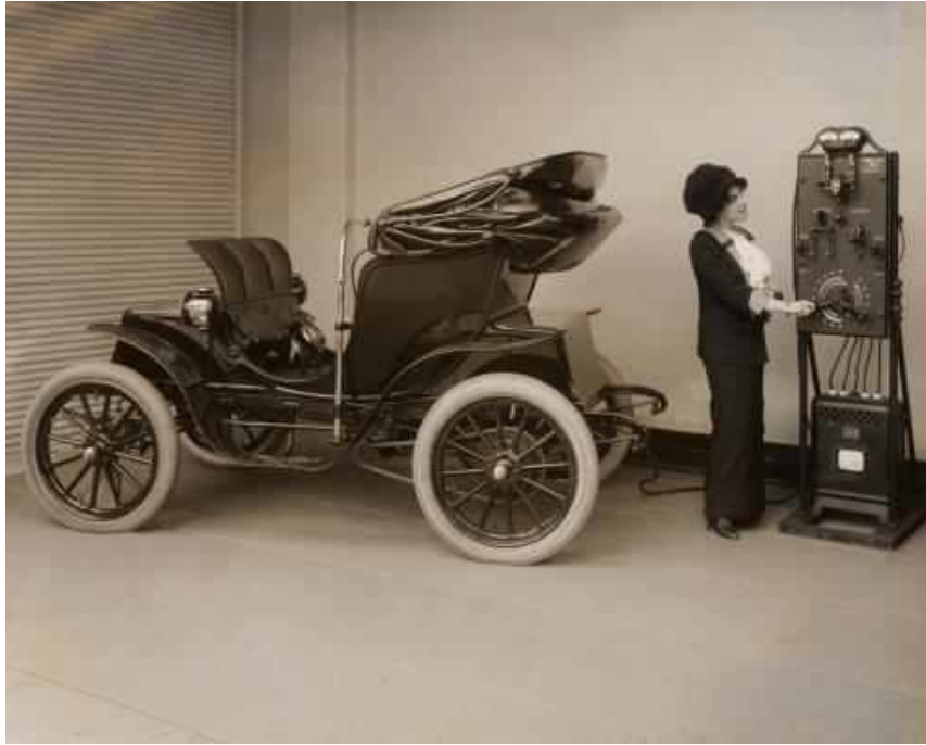
Εικόνα 2-3 Ηλεκτρικό αυτοκίνητο της Columbia Victoria κατά τη φόρτιση της μπαταρίας του [25]
