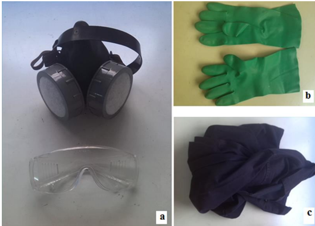
Εικόνα 5.10. Μέσα Ατομικής Προστασίας (ΜΑΠ) που χρησιμοποιήθηκαν κατά τη διάρκεια παρασκευής του νανο-σύνθετου υλικού (GNPs/PE). (α) μάσκα μισού προσώπου για προστασία αναπνοής με φίλτρα τύπου FFP3 και προστατευτικά γυαλιά, (β) γάντια νιτριλίου, μη διαπερατά από νανο-σωματίδια και (γ) χιτώνιο.
