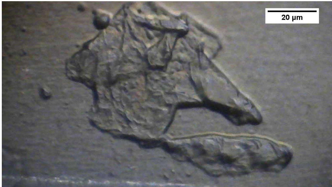
Εικόνα 6.7. Μικροσκοπική άποψη τυπικού συσσωματώματος σε δοκίμιο περιεκτικότητας 2% w.t. GNPs.
