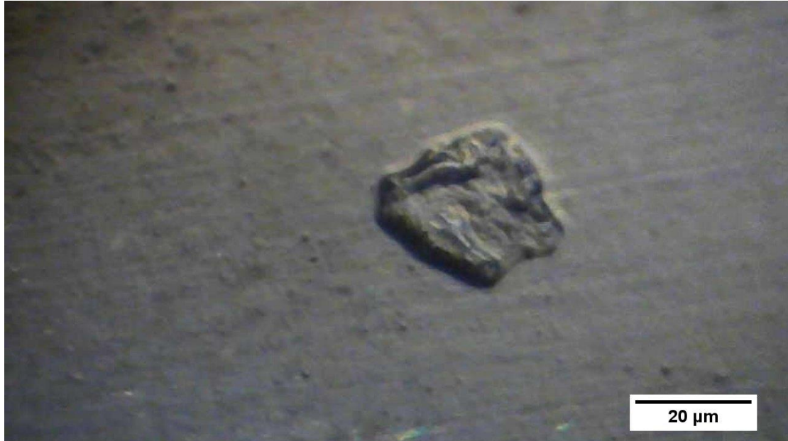
Εικόνα 6.5. Μικροσκοπική άποψη συσσωματώματος μικρής διάστασης σε δοκίμιο περιεκτικότητας 1% w.t. GNPs.
