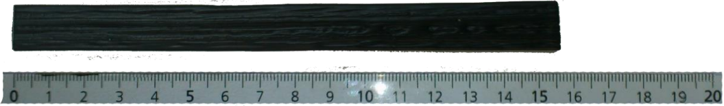
Εικόνα 5.16: Δοκίμο χωρίς προσθήκη GNPs, στις πρότυπες διαστάσεις για κάμψη
