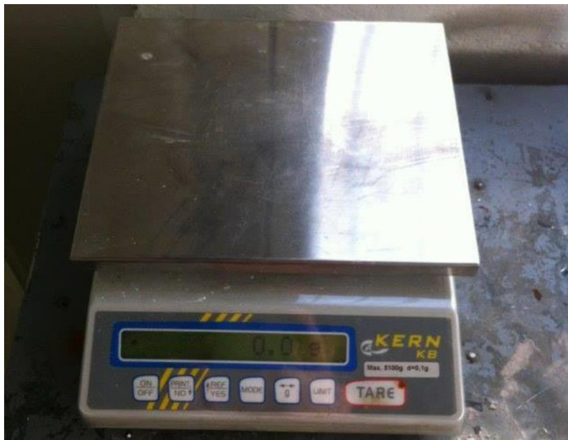
Εικόνα 5.7. Ζυγός ακριβείας που χρησιμοποιήθηκε κατά την παρασκευή των σύνθετων υλικών (GNPs/PE).
