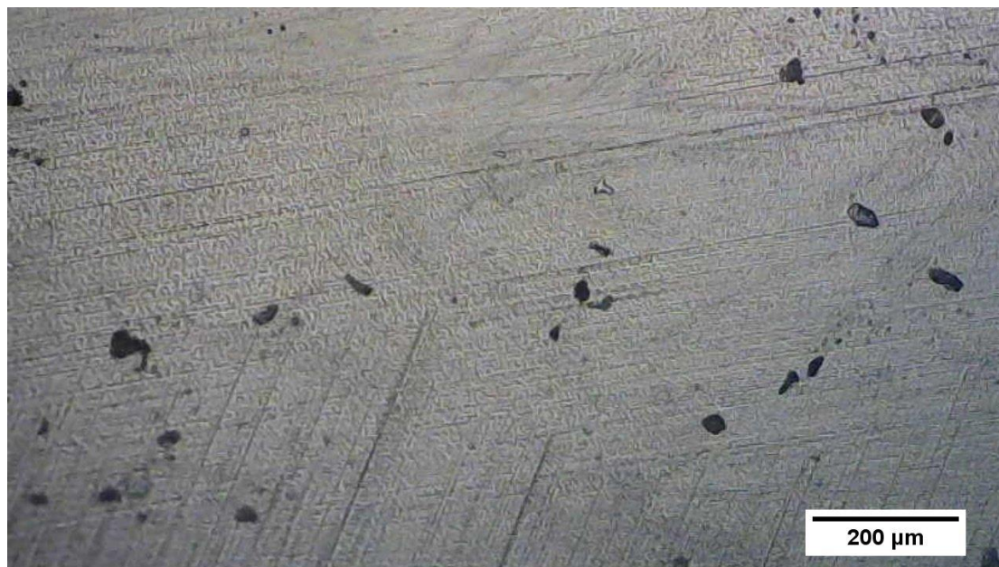
Εικόνα 6.1. Μικροσκοπική άποψη διασποράς νανοδομών γραφενίου περιεκτικότητας 1% w.t. σε μήτρα PE.
