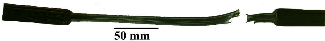
Εικόνα 5.22: Δοκίμιο με προσθήκη 1% W.t. GNPs, μετά από εφελκυσμό
