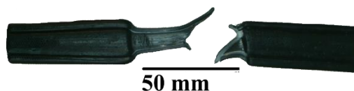
Εικόνα 5.24: Δοκίμιο με προσθήκη 3% W.t. GNPs, μετά από εφελκυσμό
