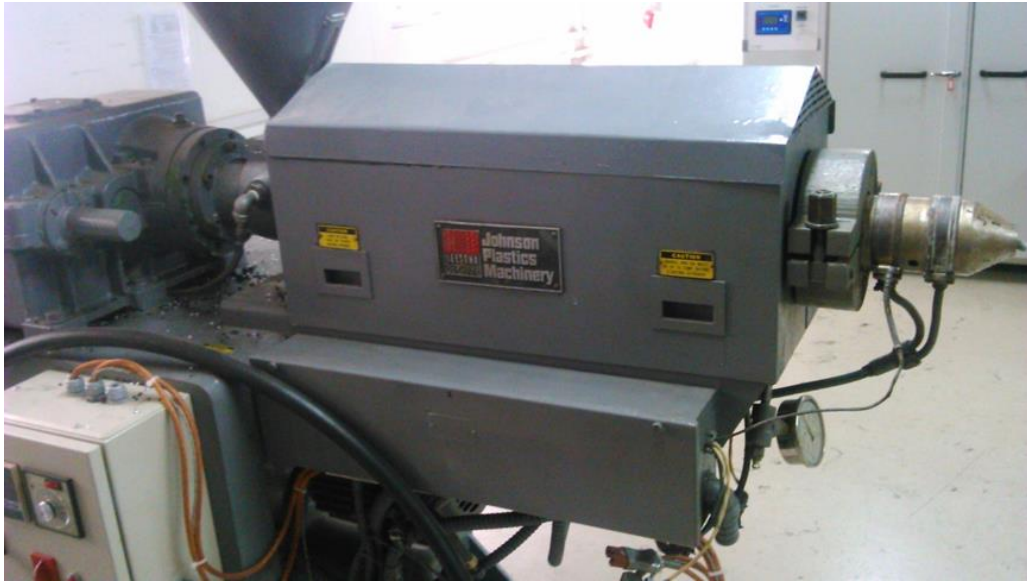
Εικόνα 5.2. Τμήμα του extruder στο οποίο υπάρχουν οι αντιστάσεις θέρμανσης και ο άξονας/κοχλίας μεταφοράς του πολυαιθυλενίου.
