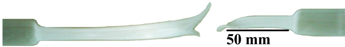
Εικόνα 5.19: Δοκίμιο χωρίς προσθήκη GNPs, μετά από εφελκυσμό
