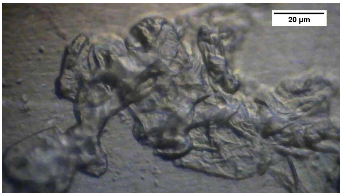
Εικόνα 6.8. Μικροσκοπική άποψη τυπικού συσσωματώματος πολύ μεγάλου μεγέθους σε δοκίμιο περιεκτικότητας 3% w.t. GNPs.
