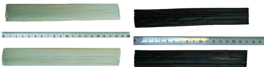
Εικόνα 5.14: (αριστερά) Δοκίμια χωρίς προσθήκη GNPs, πριν την κοπή με βάση τις πρότυπες διαστάσεις. (δεξιά) Δοκίμια με προσθήκη 1% w.t. GNPs, πριν την κοπή στις πρότυπες διαστάσεις
