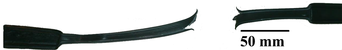
Εικόνα 5.21: Δοκίμιο με προσθήκη 1% W.t. GNPs, μετά από εφελκυσμό
