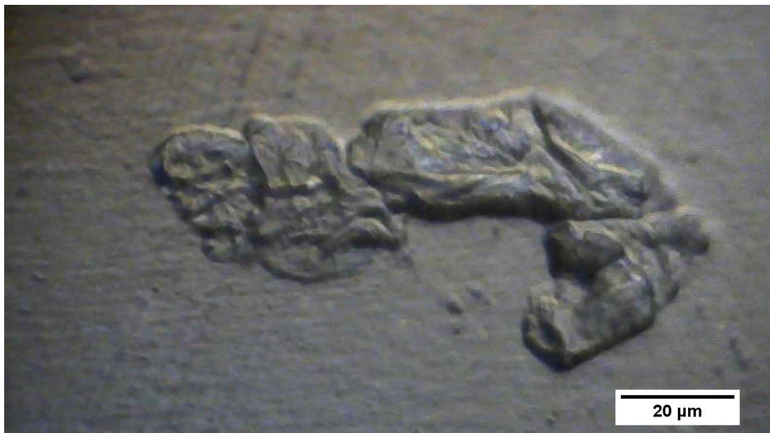
Εικόνα 6.6. Μικροσκοπική άποψη τυπικού συσσωματώματος σε δοκίμιο περιεκτικότητας 2% w.t. GNPs.
