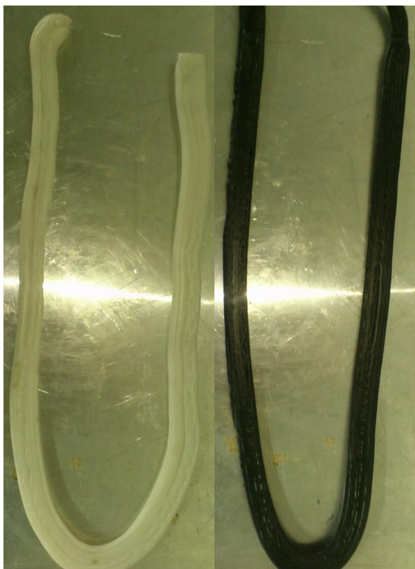
Εικόνα 5.13. Ελαφρώς συμπίεσμένο υλικό μετά τη διέλαση για δημιουργία δοκιμών εφελκυσμού: αριστερά χωρίς προσθήκη GNPs και δεξιά με προσθήκη 1% w.t. GNPs.
