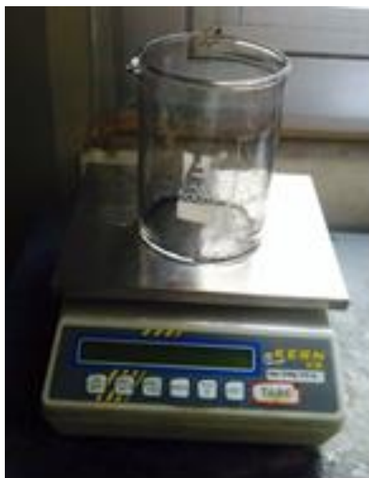
Εικόνα 5.9. Γυάλινο σκεύος ανάμιξης GNPs και PE, επάνω στο ζυγό ακριβείας.
