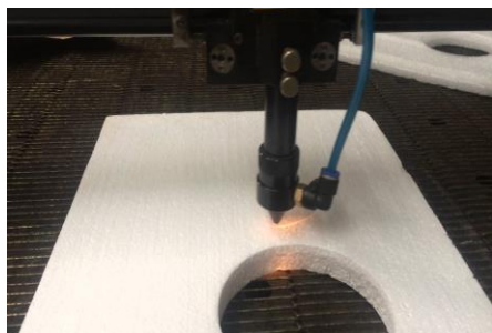
Εικόνα 26 : Κοπή μεταλλικού αφρού με laser
