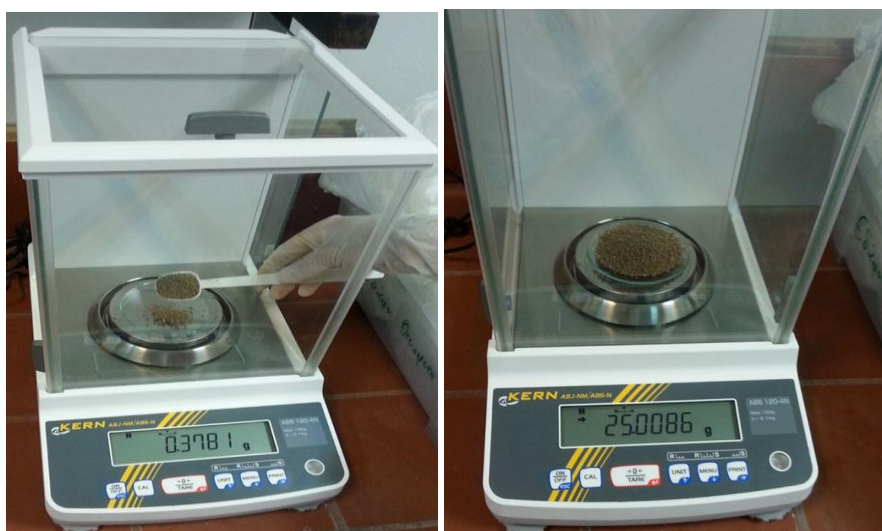
Εικόνα 4.8: Μέτρηση βάρους εδάφους για την τροφοδότηση των συριγγών
