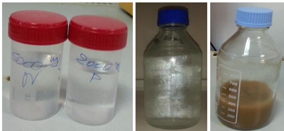
Εικόνα 4.25: Αριστερά εικονίζονται τα stock διαλύματα N 5000 mg / L και P 2000 mg / L, στο κέντρο το stock διάλυμα οξικού οξέος 10 gr / L και δεξιά ο περιέκτης με το διάλυμα βιομάζας
