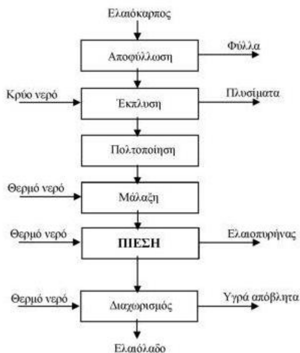
Σχήμα 1.3.1: Διαγραμματική παρουσίαση των σταδίων επεξεργασίας σε ελαιουργείο με υδραυλικό πιεστήριο (Λοϊζίδης, 2009)
