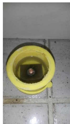
Σχήμα 3.9: Εγκιβωτισμός δοκιμίου εργαλειοχάλυβα (υπόστρωμα) σε ρητίνη
