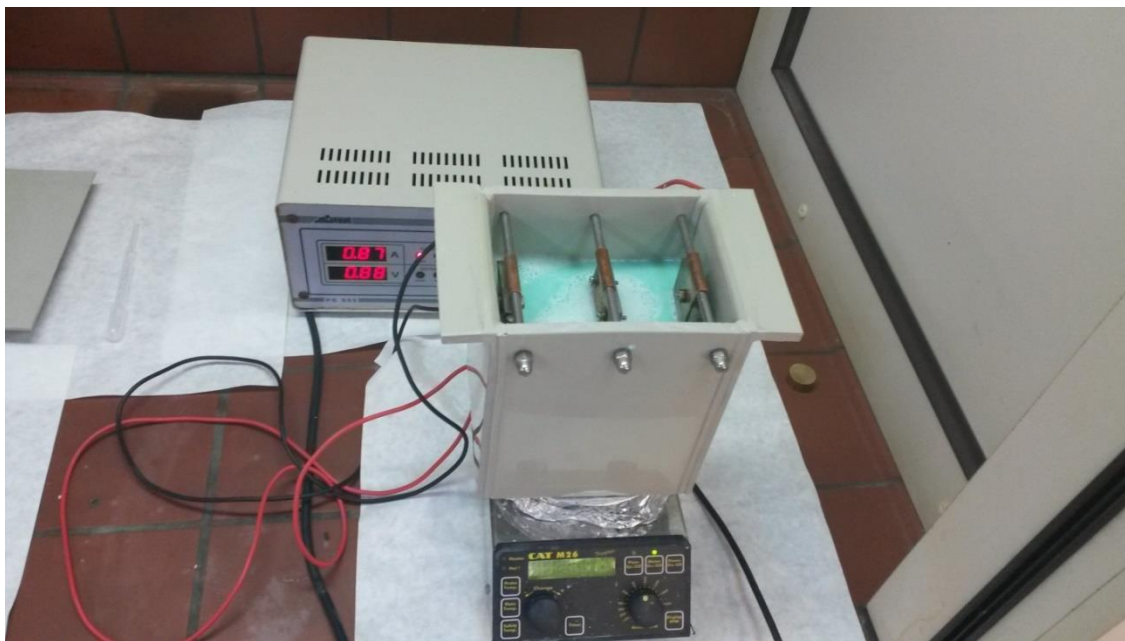
Σχήμα 3.4: Πειραματική διάταξη ηλεκτρολυτικού κελιού
