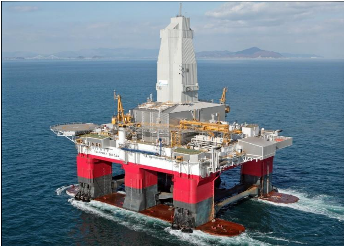
Σχήμα 24: Αυτοκινούμενη ημιβυθιζόμενη πλωτή κατασκευή «Polyarnaya Zvezda» της εταιρείας Gazprom Πηγή: Προσπελάστηκε 25/6/2016 στο www.gazprom.com/press/gallery/subsidiaries/gazprom-flot
