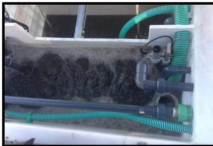
Σχήμα 4-10: Βιοαντιδραστήρα MBR σε λειτουργία με λύματα
