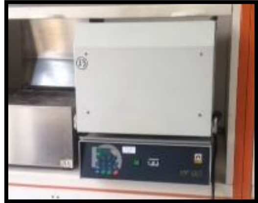
Σχήμα 4-17: Φούρνος 105,5°C και 550°C για τον υπολογισμό των TSS και VSS
