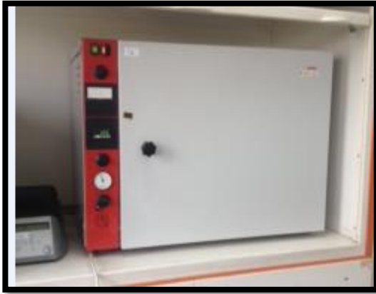
Σχήμα 4-17: Φούρνος 105,5°C και 550°C για τον υπολογισμό των TSS και VSS
