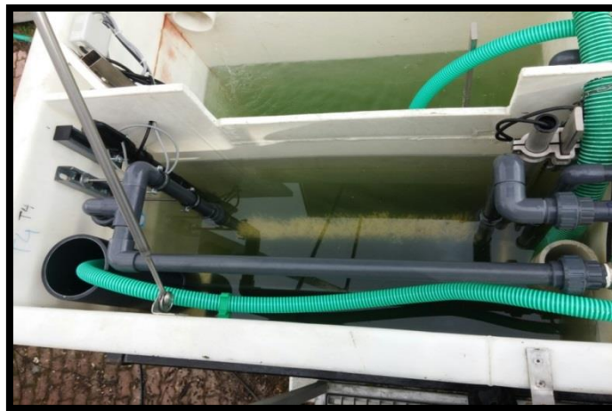
Σχήμα 4-9: Βιοαντιδραστήρας MBR σε λειτουργία με νερό
