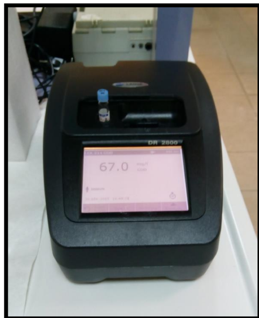
Σχήμα 4-19: Χωνευτήρας και φασματοφωτόμετρο για τη μέτρηση του COD
