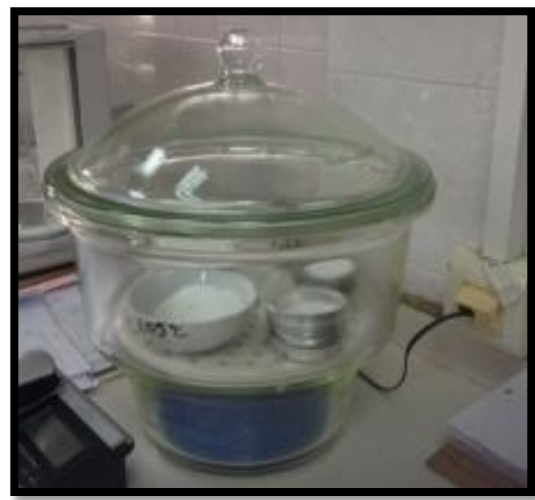
Σχήμα 4-18: Ζυγός και αφυγραντήρας για τη μέτρηση των στερεών
