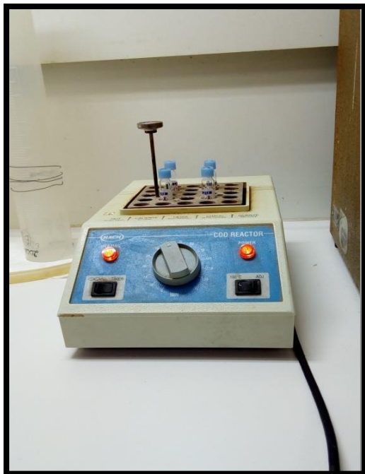
Σχήμα 4-19: Χωνευτήρας και φασματοφωτόμετρο για τη μέτρηση του COD
