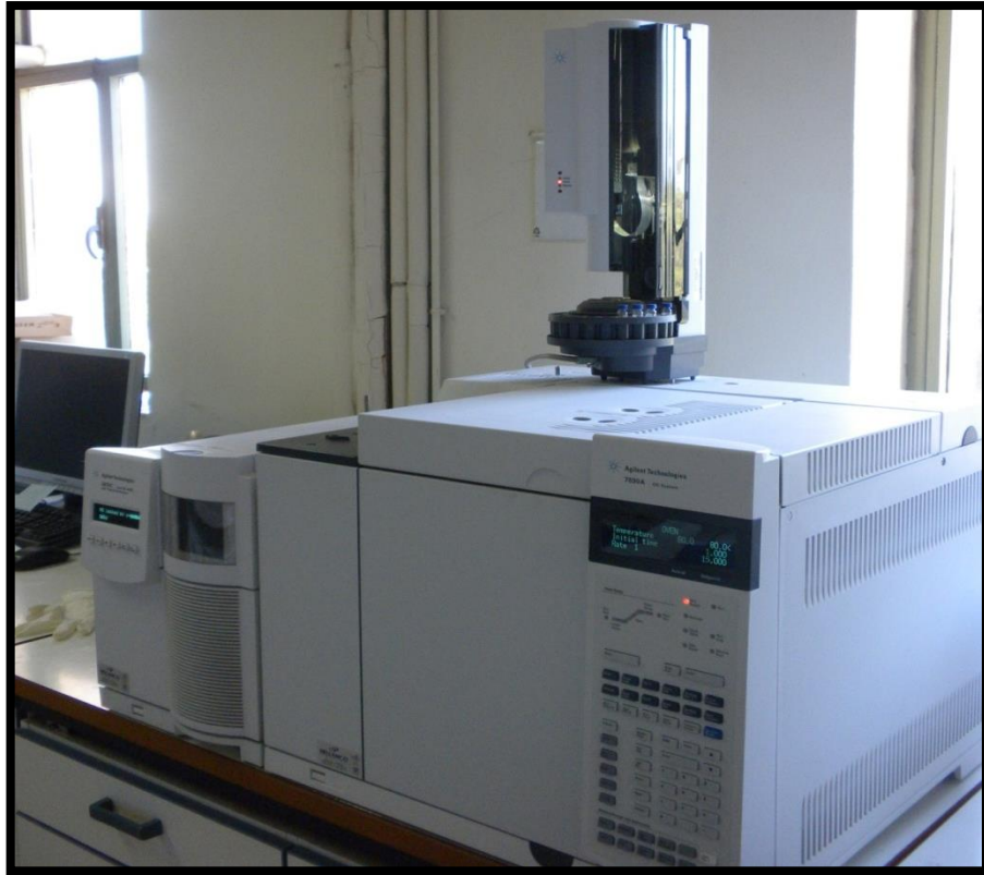
Σχήμα 4-24: Αέριος χρωματογράφος τύπου Agilent 7890A συζευγμένος με φασματογράφο μάζας Agilent 5975C
